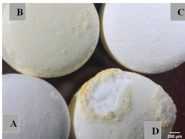
Slika 31. Stereomikrografija tableta; 25X (Advantia™): A – neobložena tableta; B – pokus 1; C – pokus 2; D – pokus 6
