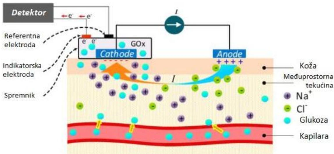
Slika 3.21 Princip obrnute ionoforeze za mjerjenje razine glukoze, adaptirano iz [41]
