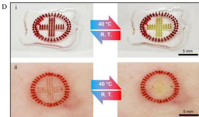
Slika 3.32 Responzivne tetovaže na bazi svjetlosno osjetljivih i termoosjetljivih flasterima<sup>[42]</sup>
