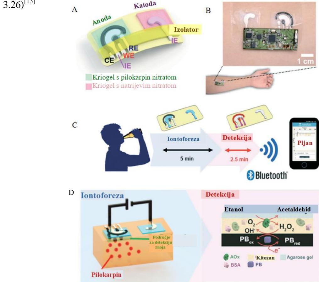
Slika 3.26 Tetovaža kao transdermalni senzor za mjerjenje alkohola, adaptirano iz [13]
