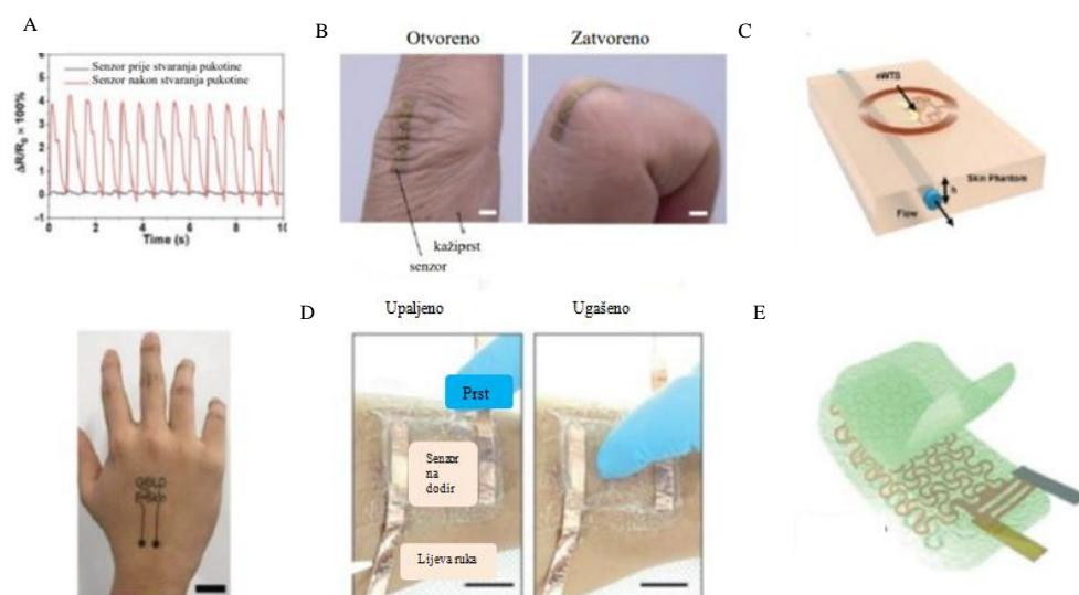
Slika 3.2 Fizički senzori: fizička promjena u senzoru za mjerjenje bioloških signalova: (A, B) senzori naprezanja i (C) toplinski senzor, (D) senzor dodira i (E) elektrokardiogram [29]
