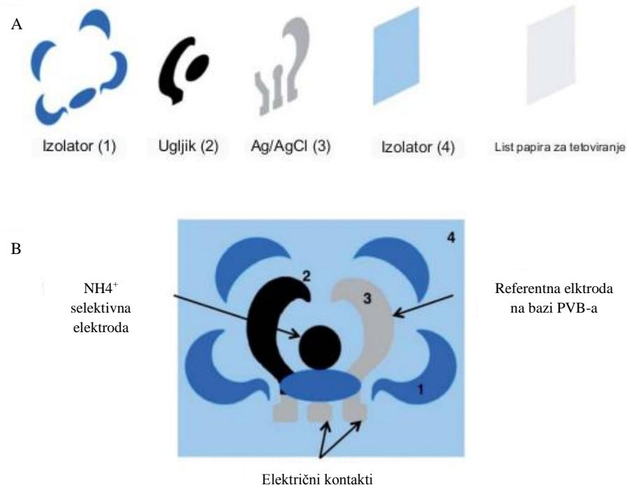
Slika 3.17 Izrada potenciometrijskog senzora sloj po sloj<sup>[36]</sup>
