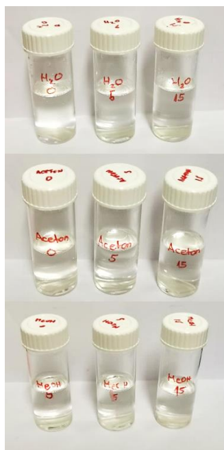
Slika 22. Prikaz bočica s uzorcima tijekom procesa bubrenja
