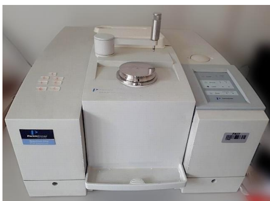
Slika 23. Uređaj PerkinElemer Spectrum One
