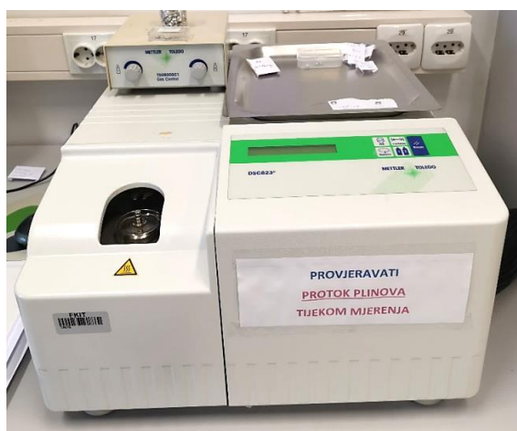
Slika 24. Uređaj Mettler Toledo DSC 823
