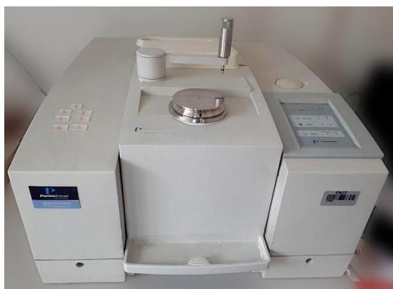
Slika 23. Uredaj PerkinElmer Spectrum One
