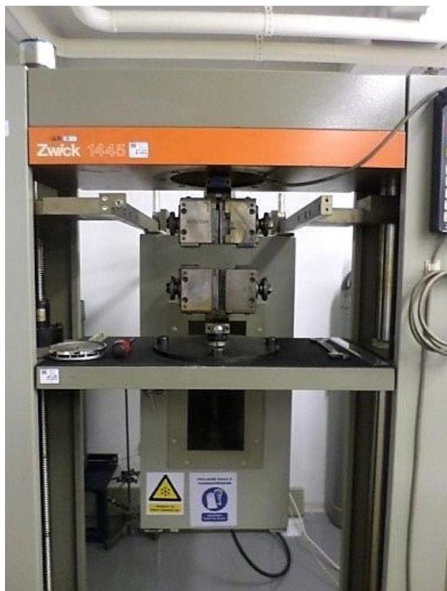
Slika 21. Kidalica UTM 1445 Zwick Röell, Njemačka
