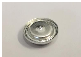
Slika 25. Posudica s poklopcem za DSC mjerenje
