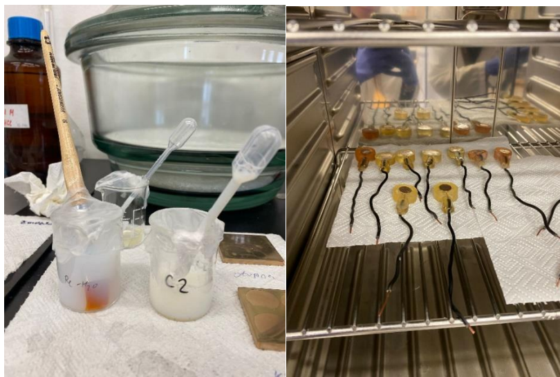
Slika 14. Priprema elektroda nanošenjem vodorazjedinog premaza i sušenjem u peći na 40°C
