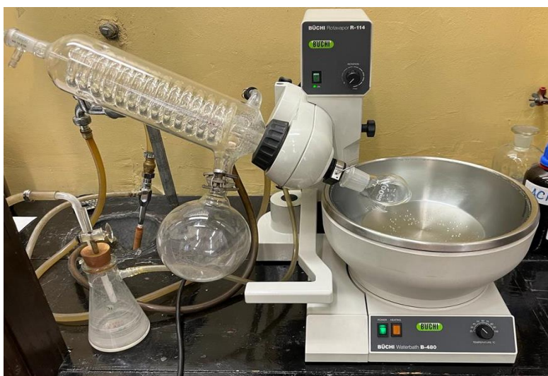
Slika 19. Uparivač Büchi Waterbath B-480
