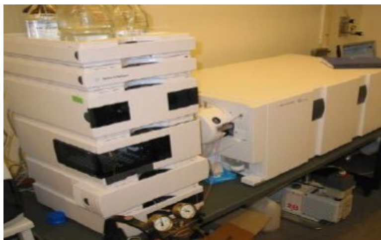
Slika 20. Agilent kromatografski sustav Series 1200 sa spektrometrom masa 6410 QqQ
