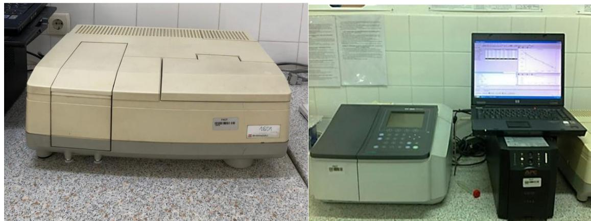
Slika 3.5. Spektrofotometar Shimadzu a) UV-1601 i b) UV-1800
