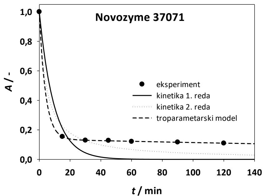
Slika 4.4. Operacijska stabilnost enzima tijekom hidrolize proteina u ostacima kozica katalizirana proteazama u kotlastom reaktoru ( $T = 50^\circ\text{C}$ ,  $50 \text{ mmol dm}^{-3}$  Tris-HCl pH 8,  $V_{\text{reaktor}} = 200 \mu\text{L}$ ,  $m_{\text{kozica}} = 20 \text{ mg}$ ,  $A_{\text{proteaze}} = 1 \text{ U}$ )
