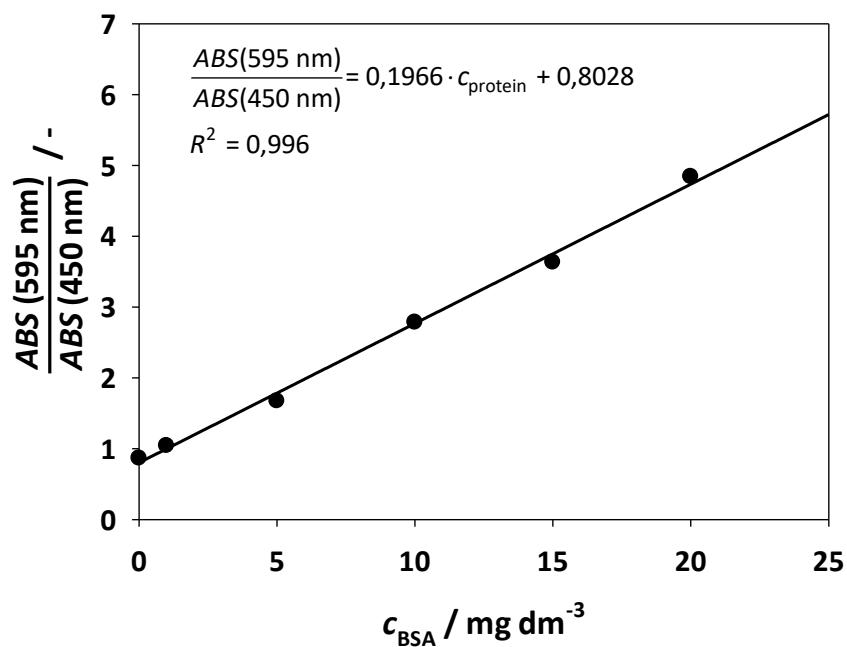
Slika 8.3. Baždarni pravac za mjerjenje koncentracije proteina
