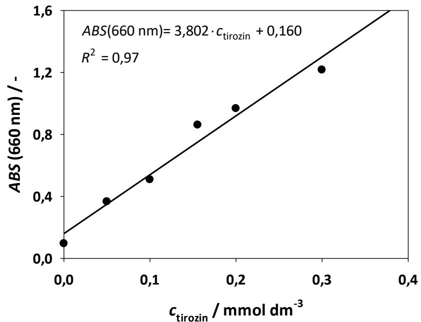
Slika 8.1. Baždarni pravac za mjerjenje koncentracije tirozina
