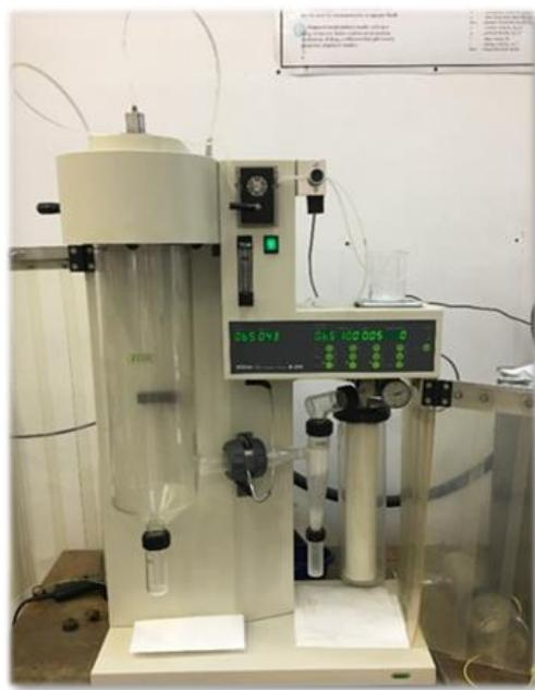
Slika 9. Fotografija laboratorijskog sušionika s raspršivanjem Mini Spray-Dryer B-290
