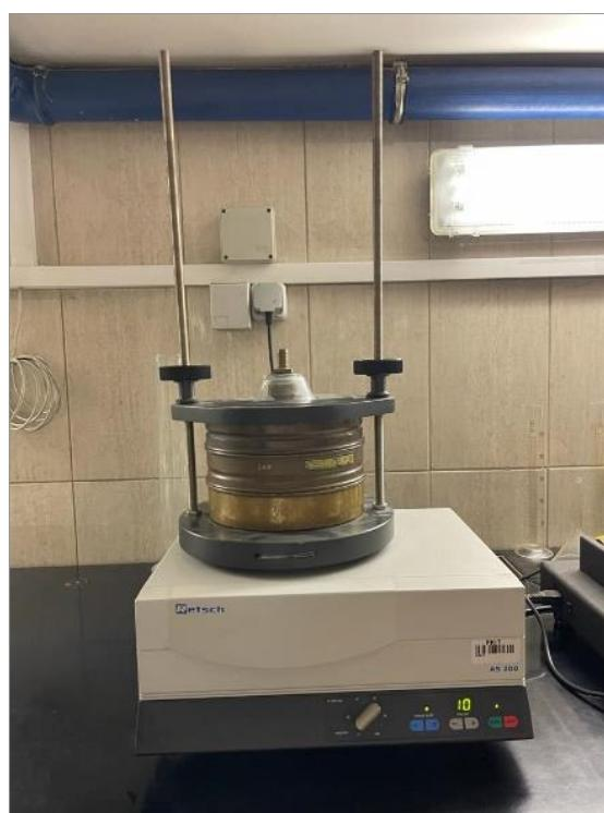
Slika 4. Fotografija uređaja za potresivanje AS 200
