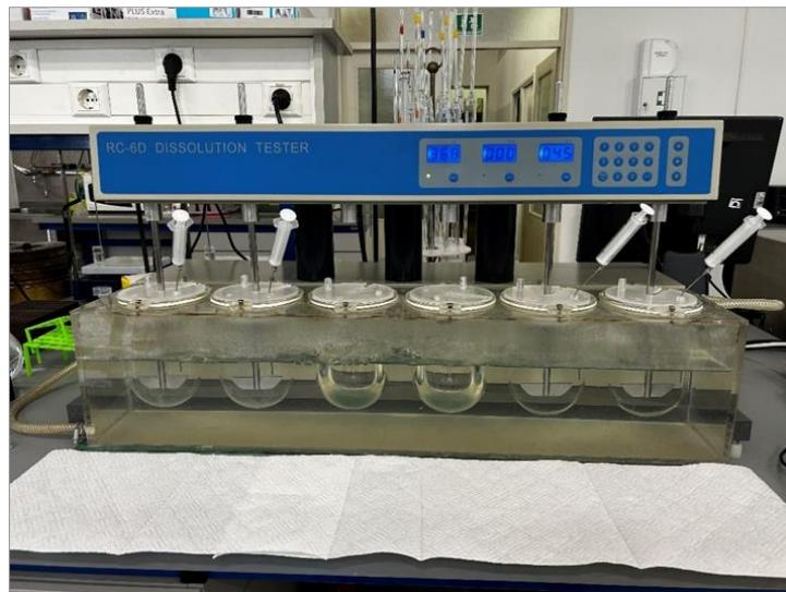
Slika 13. Fotografija uređaja za određivanje profila oslobađanja djelatne tvari RC-6D
