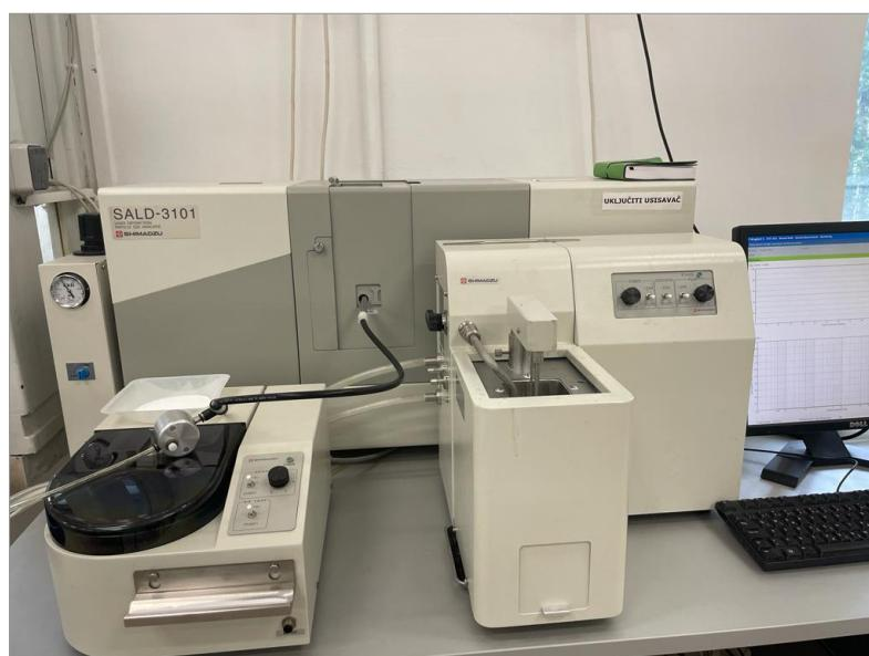
Slika 6. Fotografija uređaja za određivanje raspodjele veličina čestica metodom laserske difrakcije SALD-3101 (Shimadzu, Kyoto, Japan)
