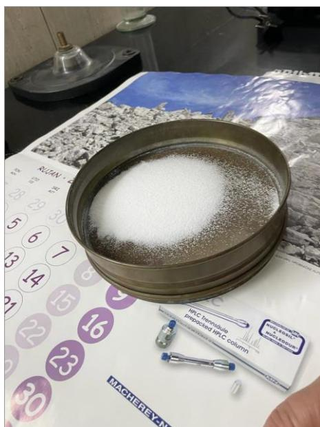
Slika 15. Fotografija sita s prosijanim granulatom
