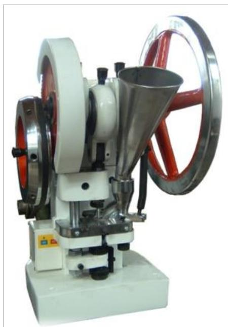
Slika 7. Fotografija uređaja za tabletiranje TDP-5T
