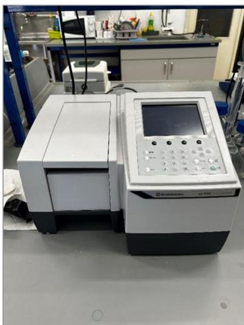
Slika 12. Fotografija UV/Vis spektrofotometra UV-1280
