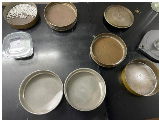
Slika 14. Fotografija sita s prosijanim Parteckom
