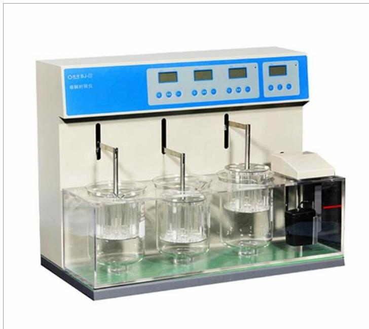
Slika 11. Fotografija uređaja za ispitivanje raspadljivosti tableta BJ 2
