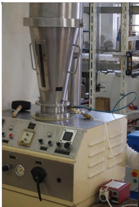
Slika 8. Fotografija granulatora s fluidiziranim slojem Uni-Glatt
