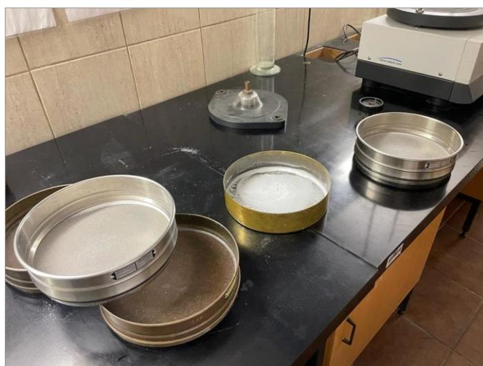
Slika 16. Fotografija sita s prosijanim D(-) manitolom
