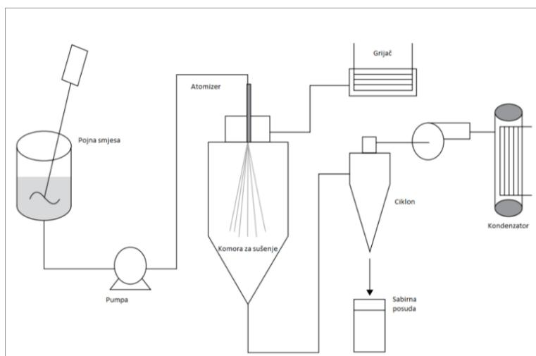
Slika 3. Shematski prikaz procesa/procesne tehnologije sušenja raspršivanjem
