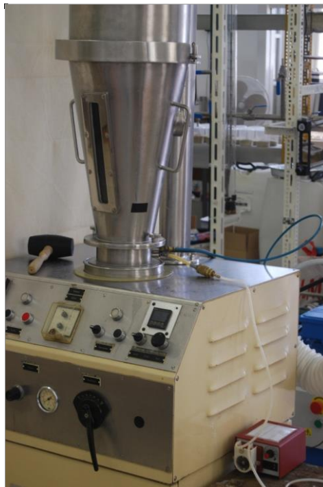
Slika 8. Fotografija granulatora s fluidiziranim slojem Uni-Glatt (Glatt GmbH, Binzen, SR Njemačka)
