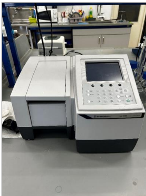
Slika 12. Fotografija UV/Vis spektrofotometra UV-1280 (Shimadzu, Kyoto, Japan)
