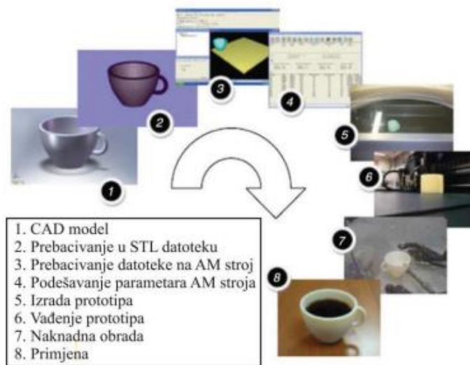
Slika 2.6. Prikaz pojedinih stupnjeva procesa aditivne proizvodnje[22]
