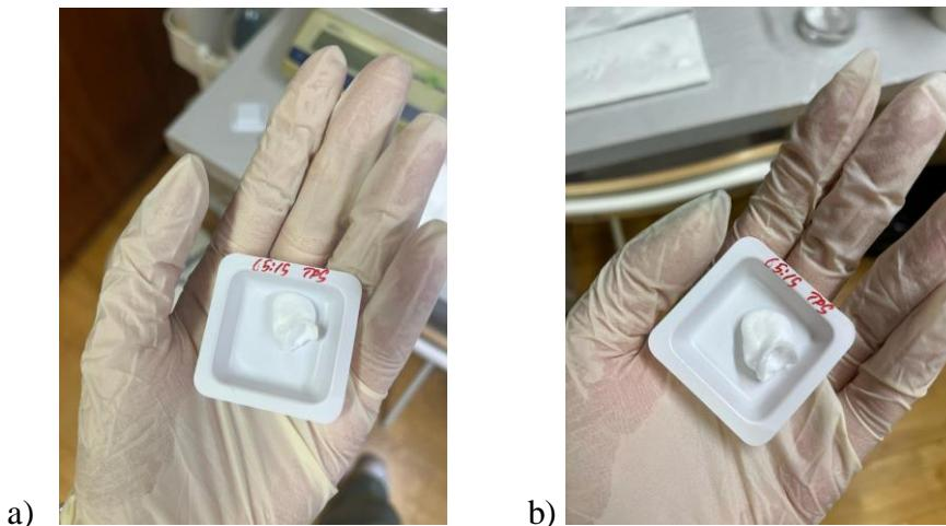
Slika 22. Izgled hidrogela PLA + TPS/NMP (omjer 85:15)
