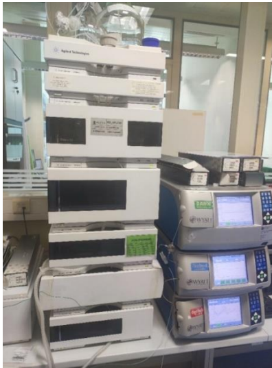
Slika 14. GPC kromatografski uređaj Agilent 1260 Infinity s refraktometrijskim osjetilom korištenim za određivanje molekulskih masa polimernih uzoraka hidrogelova
