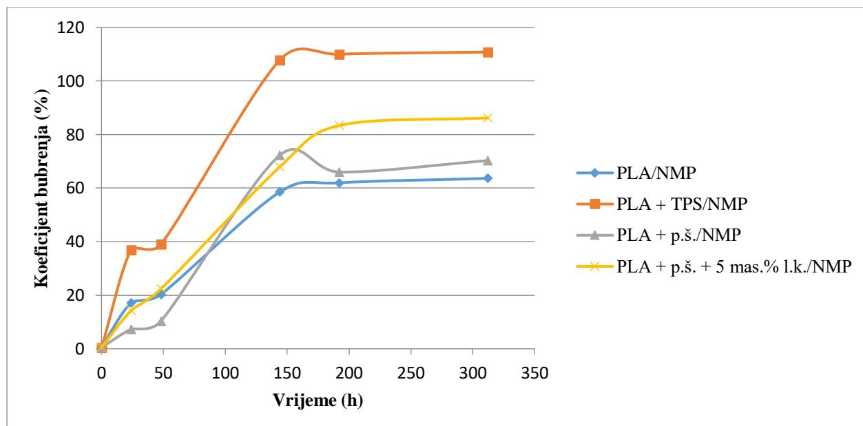
Slika 26. Grafički prikaz ovisnosti supnja bubrenja o vremenu (t) za uzorke hidrogela PLA:škrob u omjeru 90:10
