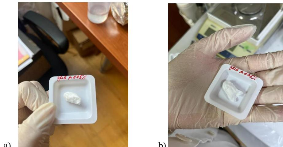
Slika 18. Izgled hidrogela PLA + p.š. + 5 mas. % l.k./NMP (omjer 95:5)
