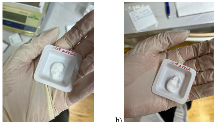
Slika 24. Izgled hidrogela PLA + p.š. + 5 mas. % l.k./NMP (omjer 85:15)
