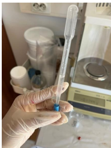
Slika 13. Postupak punjenja kapsule polimernom otopinom
