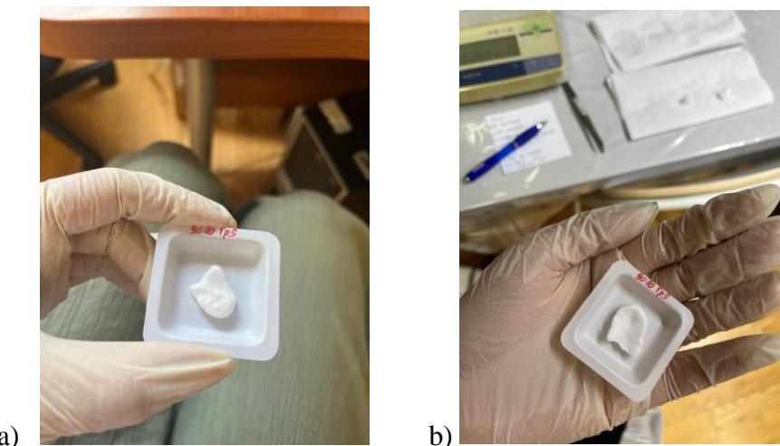
Slika 19. Izgled hidrogela PLA+TPS/NMP (omjer 90:10)
