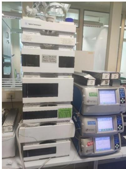
Slika 14. GPC kromatografski uređaj Agilent 1260 Infinity s refraktometrijskim osjetilom korištenim za određivanje molekulske masu polimernih uzoraka hidrogelova
