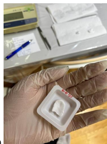
Slika 19. Izgled hidrogela PLA+TPS/NMP (omjer 90:10) nakon a) 24 h i b) 336 h bubrenja
