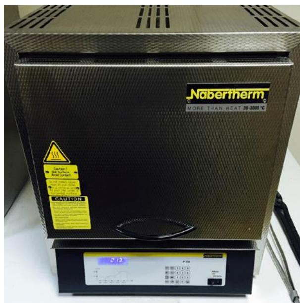
**Slika 13.** Visokotemperaturna peć *Nabertherm*
