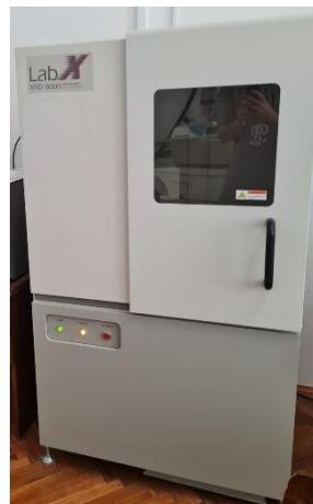
**Slika 16.** XRD instrument LabX XRD *Shimadzu 6 000*
