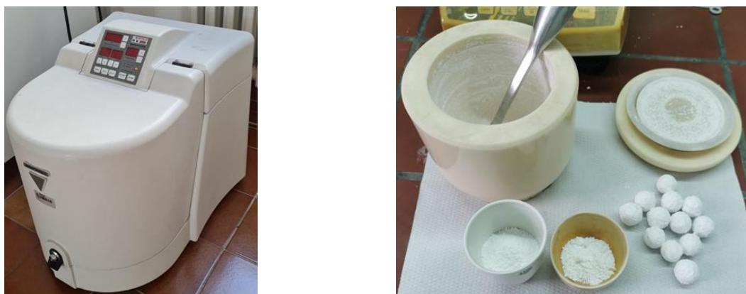
**Slika 12.** Prikaz planetarnog mlina *Pulverizette* (lijevo), posude i kuglica za miješanje (desno)
