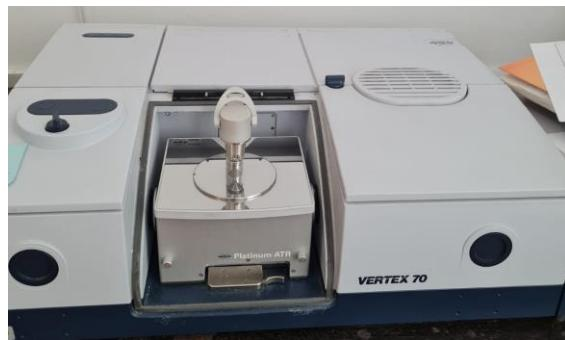
**Slika 15.** ATR-FTIR instrument *Bruker Vertex 70* sa Platinum ATR
