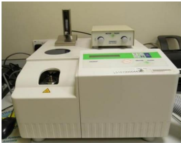
Slika 22. Mettler Toledo DSC 823eT kalorimetar
