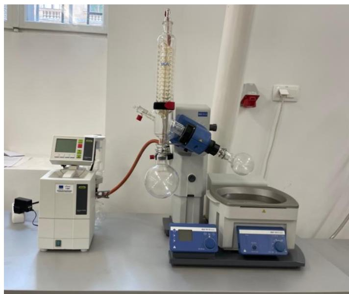
**Slika 15.** Vakuum rotacijski isparivač
