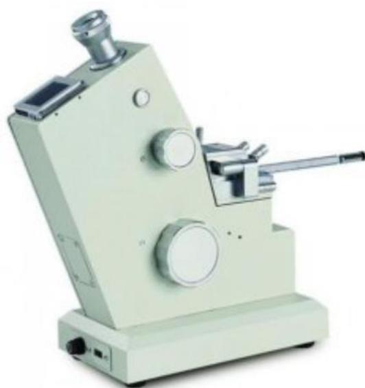
**Slika 16.** Exacta Optech Abbe refraktometar model RMI
