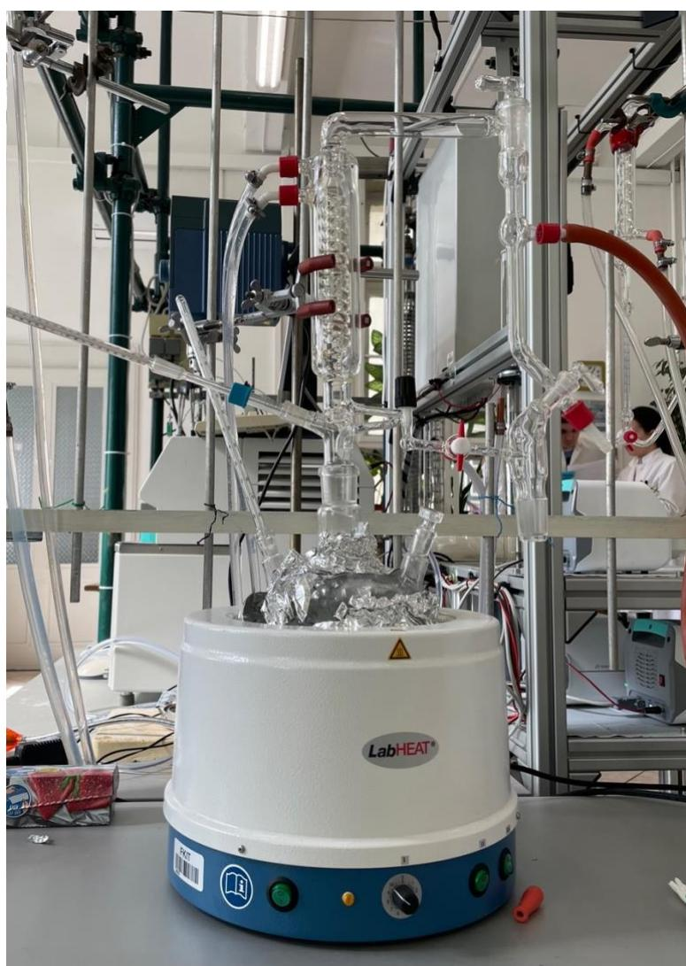
Slika 17. Destilacijska kolona za šaržnu destilaciju
