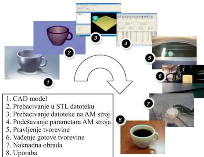
Slika 21 Faze općenitog postupka aditivne proizvodnje [43].
