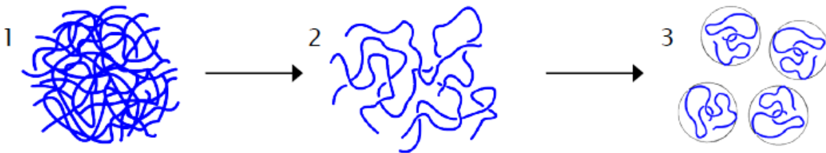
Slika 11 Shematski prikaz otapanja polimera [15]
