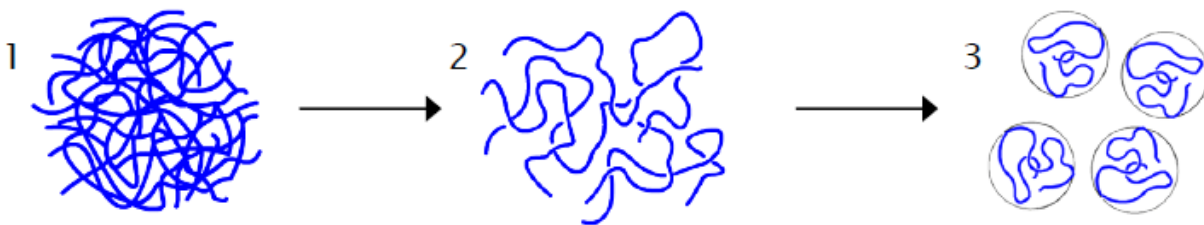
Slika 11 Shematski prikaz otapanja polimera [15]
