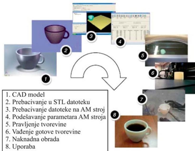
Slika 21 Faze općenitog postupka aditivne proizvodnje [43].
