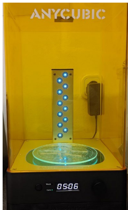
Slika 31 Očvršćivanje u komori Anycubic Cure Machine 2.0 na valnoj duljini od 405nm
