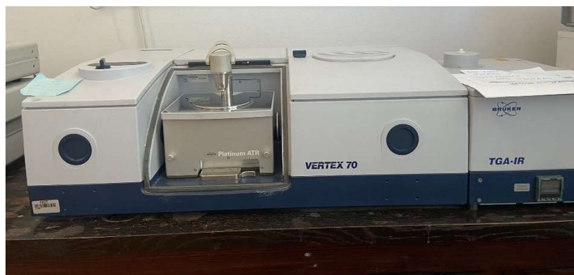
Slika 17. Spektrometar Bruker Vertex 70.
