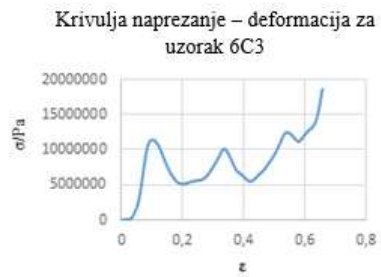
Slika B28. Krivulja naprezanje - deformacija za uzorak C u šestom tjednu razgradnje.
