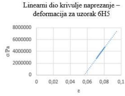
Slika B303. Krivulja naprezanje - deformacija za uzorak **H** u šestom tjednu razgradnje.
