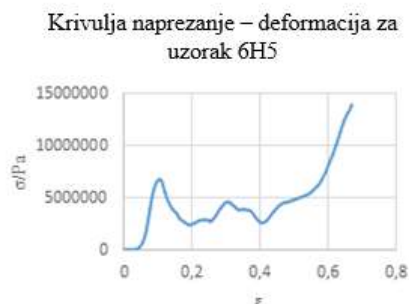
Slika B303. Krivulja naprezanje - deformacija za uzorak H u šestom tjednu razgradnje.
