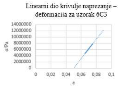
Slika B28. Krivulja naprezanje - deformacija za uzorak C u šestom tjednu razgradnje.
