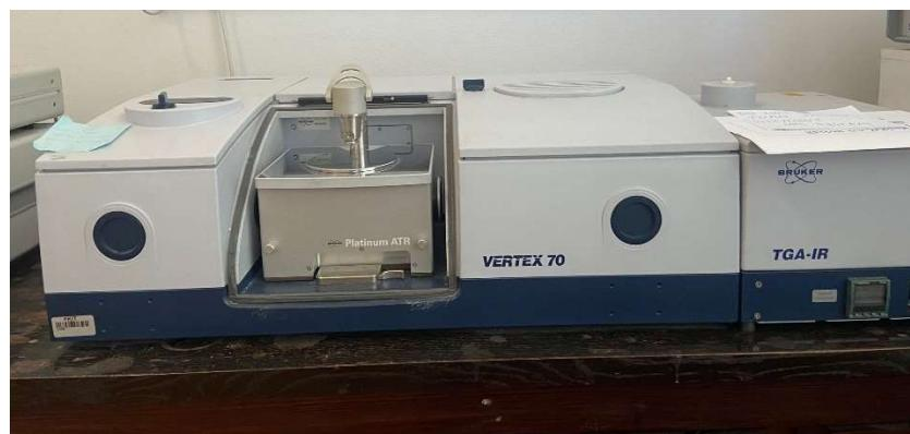
Slika 17. Spektrometar Bruker Vertex 70.
