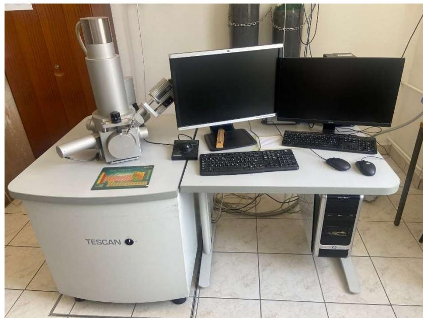
Slika 18. Pretražni elektronski mikroskop SEM Tescan Vega 3.
