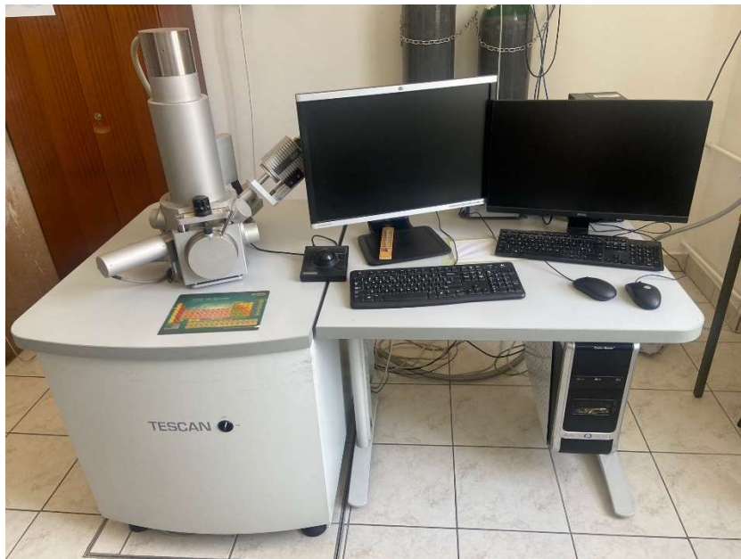
Slika 18. Pretražni elektronski mikroskop SEM Tescan Vega 3.
