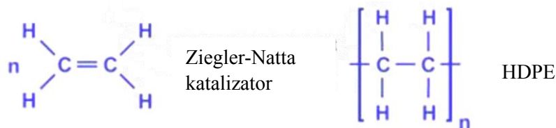
Slika 8. Nastajanje PE-HD uz Ziegler-Natta katalizator
