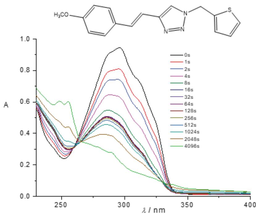
Slika 27. UV spektri dobiveni prilikom osvjetljavanja trans-izomera
