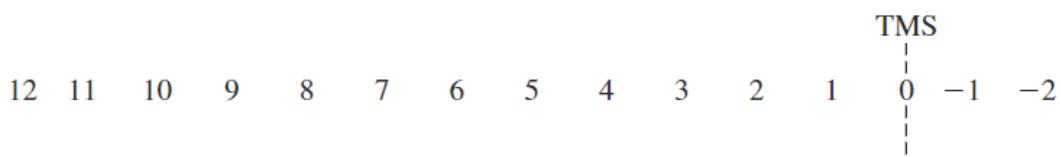
*Slika 4: Skala na kojoj se prikazuju rezultati mjerena izražena preko  $\delta$  (ppm)*
