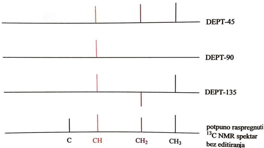
*Slika 10: Shematski prikaz DEPT spektara koje je moguće snimiti primjenom različitih pulseva*
