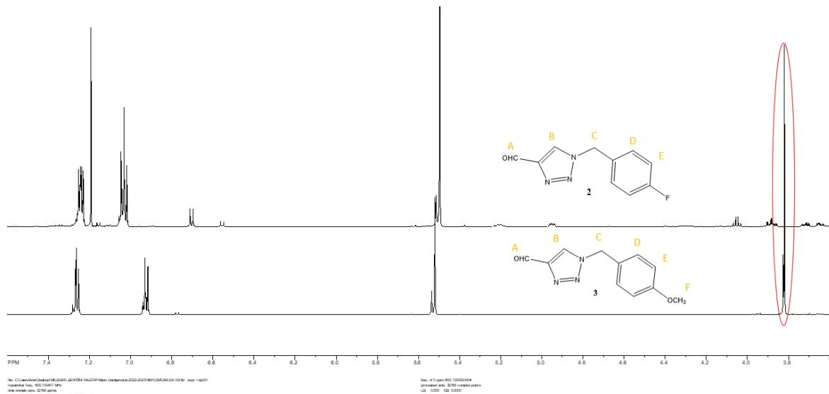
Slika 223.  $^1\text{H}$  NMR spektri spojeva **2** i **3**
