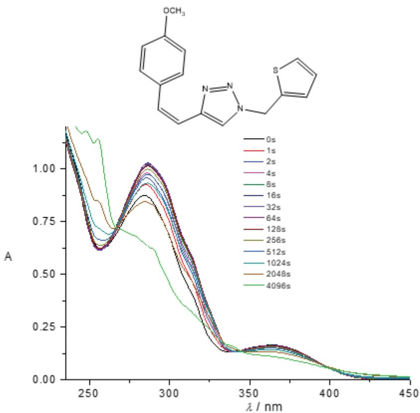
Slika 26. UV spektri dobiveni prilikom osvjetljavanja cis-izomera
