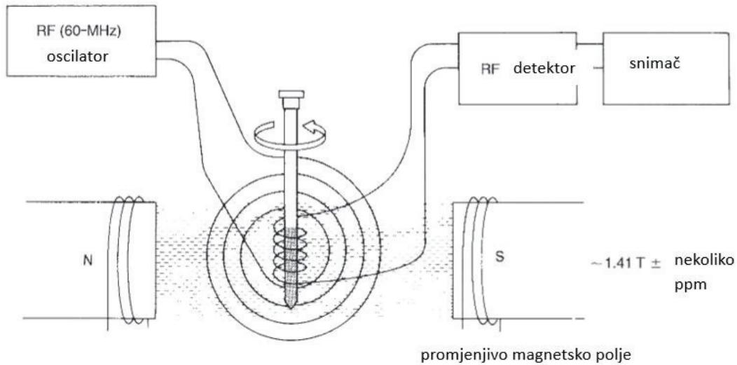
Slika 5: Uredaj za mjerjenje rezonancije primjenom kontinuiranog magnetskog vala
