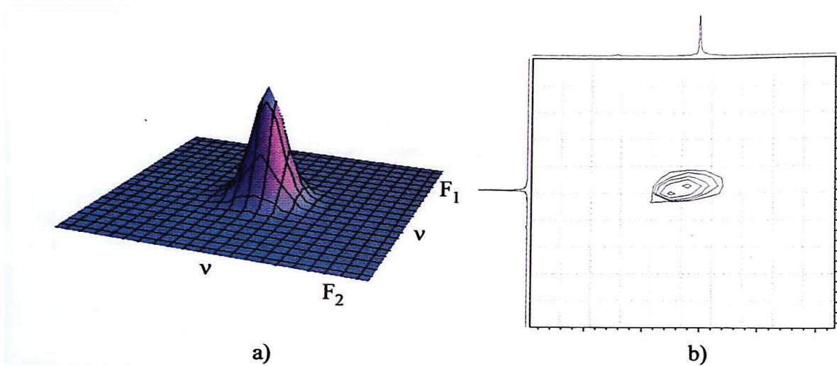
Slika 11: Shematski prikaz signala u dvodimenzijском spektru NMR: a) trodimenzijski prikaz,
