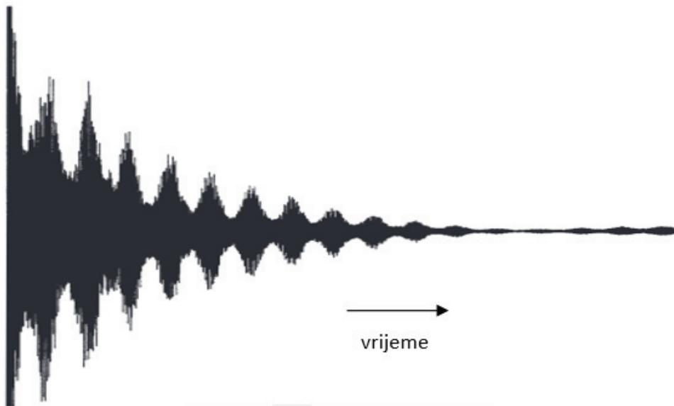
Slika 7: FID signal dobiven snimanjem etil-fenilacetata pri 300 MHz
