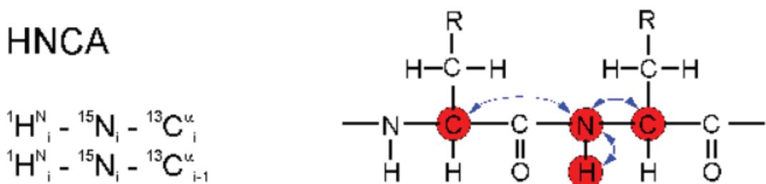
Slika 19. Shema prijenosa magnetizacije kod HNCA tehnike
