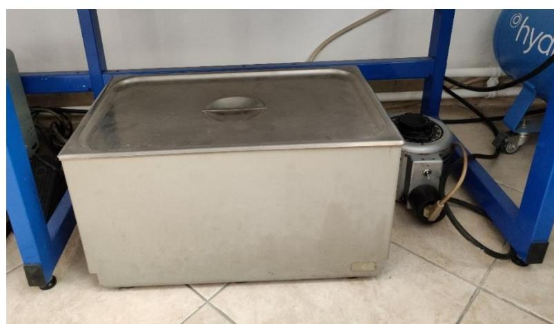
**Slika 9.** Fotografija ultrazvučne kupelji
