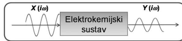
Slika 2.5.2.1. Shematski prikaz mjerenja impedancije
