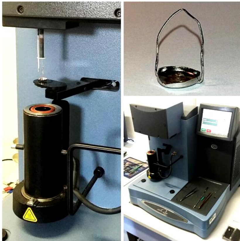
Slika 3.7.1. Instrument i uzorak za termogravimetrijsku analizu
