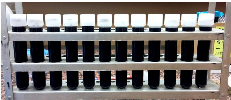
Slika 3.3.4.1. Suspenzija grafena dobivena nakon redukcije GO s OMW
