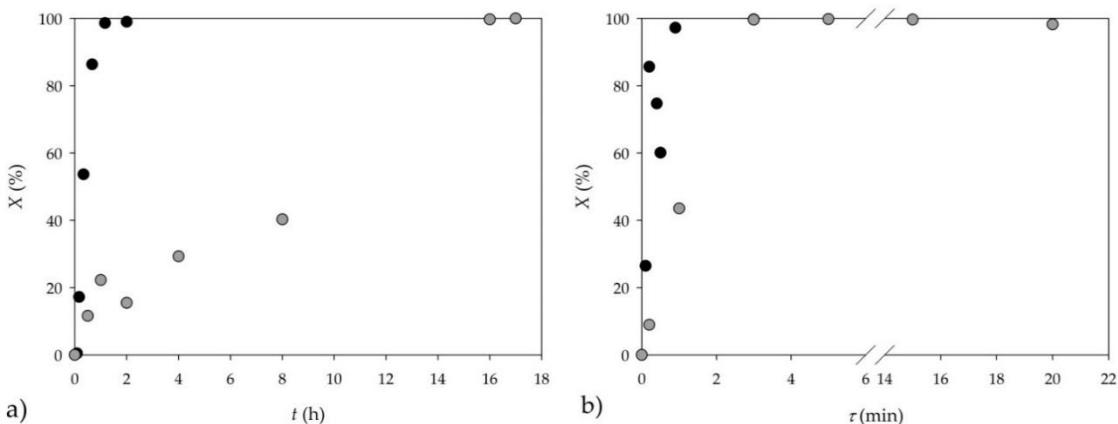
**Slika 160.** Usporedba fotokatalitičkog procesa oksigenacije koji se izvodi u (a) šaržnom reaktoru i (b) mikroreaktoru s geometrijom namotanog kanala ( $\circ$  tienil (221) i  $\bullet$  furil (220) kao supstrat).
