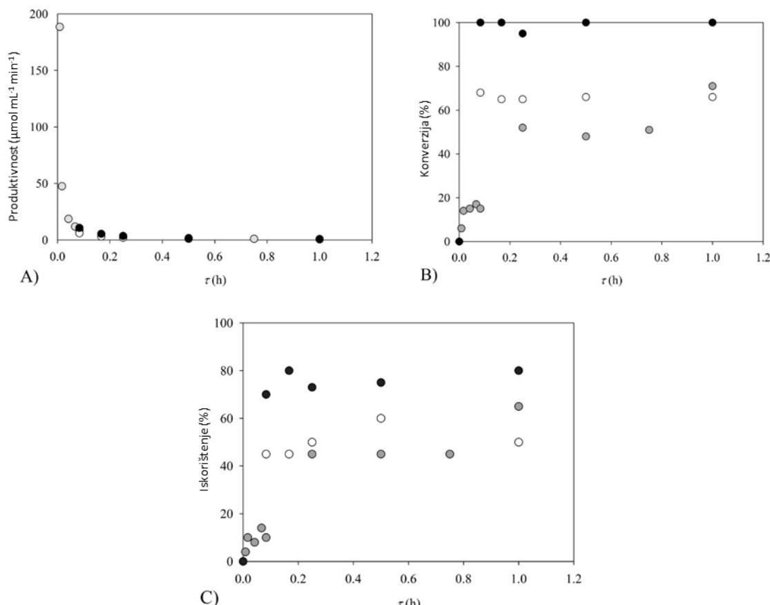
**Slika 152.** Usporedba A) produktivnosti, B) konverzije i C) iskorištenja za različita vremena zadržavanja u mikroreaktorskom sustavu (prikazanom na slici 149) za spoj 128 (●), spoj 216 (○) i spoj 217 (●)
