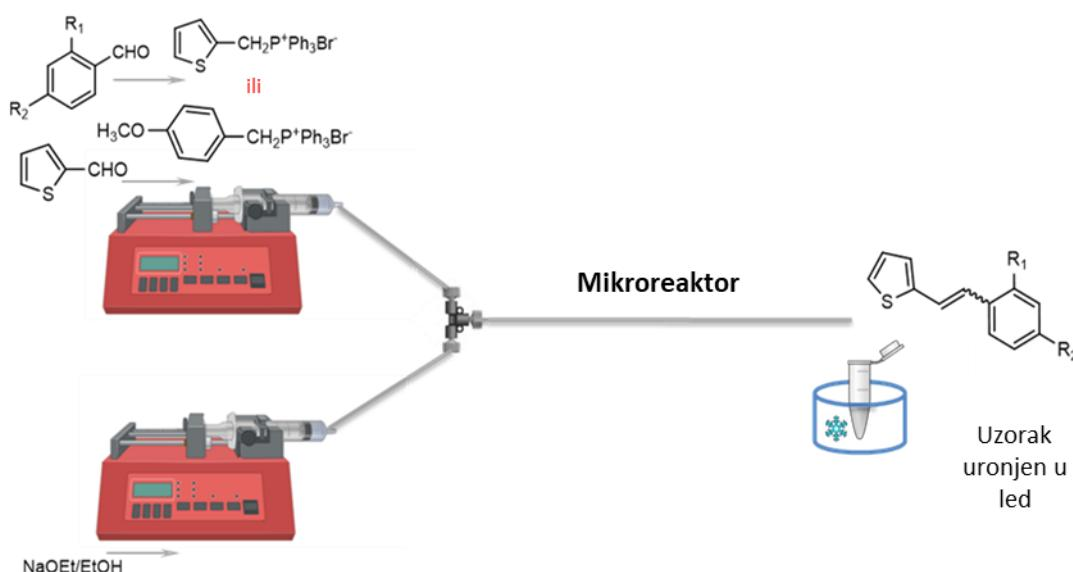
Slika 151. Sustav mikroreaktora za Wittigovu reakciju dobivanja spojeva 128, 215-217 [301].
