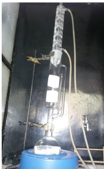
Slika 13. Soxhletova aparatura za ekstrakciju plinovitih PAU-a
