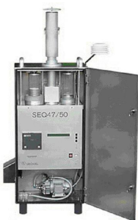
Slika 7. Sekvencijalni uređaj Sven Leckel Sequential Sampler SEQ47/50 za sakupljanje frakcija lebdećih čestica PM_{10} , PM_{2,5} i PM_1
