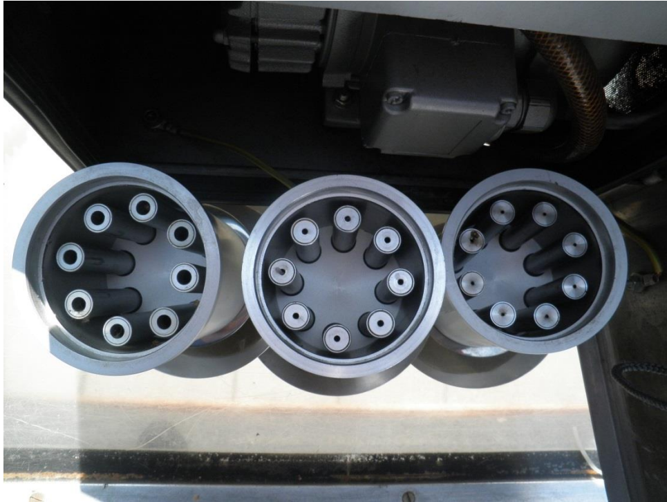
Slika 9. Mlaznice referentnih glava za sakupljanje frakcija lebdećih čestica PM 10 , PM 2,5 i PM 1
