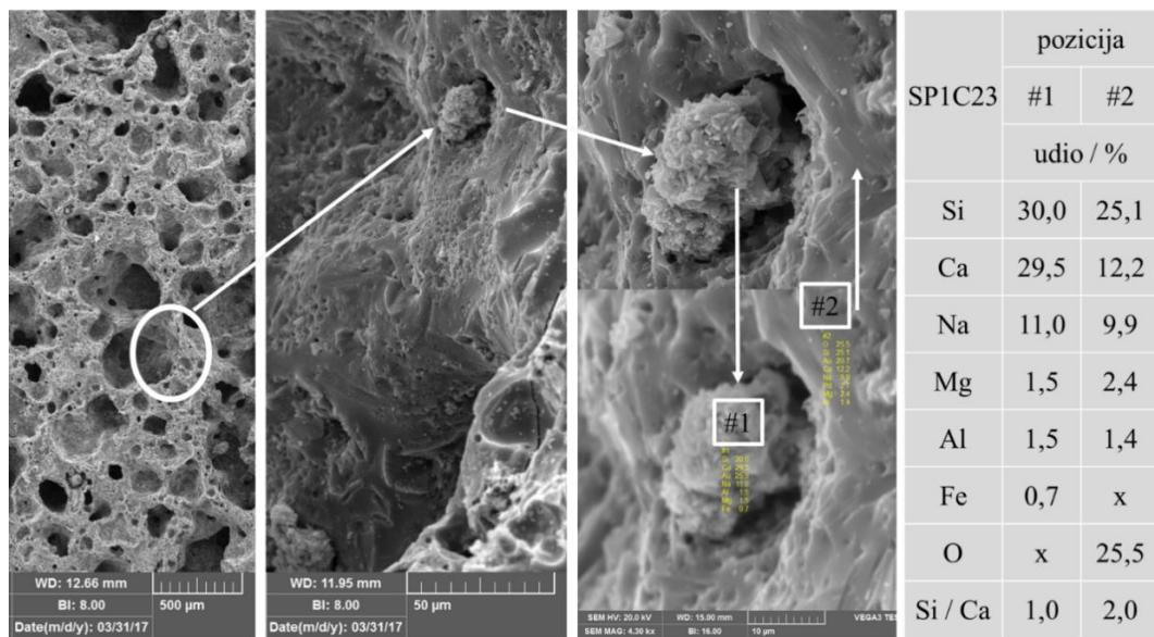
**Slika 38.** SEM/EDS mikrografije pjenostakla oznake SP1C23 sastava: 76 mas. % otpadnog stakla (S), 1 mas. % otpadnog vapnenca (P) te otpadnog pepela (C) od 23 mas. %.; prikaz mesta EDS analize pri različitim povećanjima; EDS analiza prikazana tablično za dvije pozicije.
