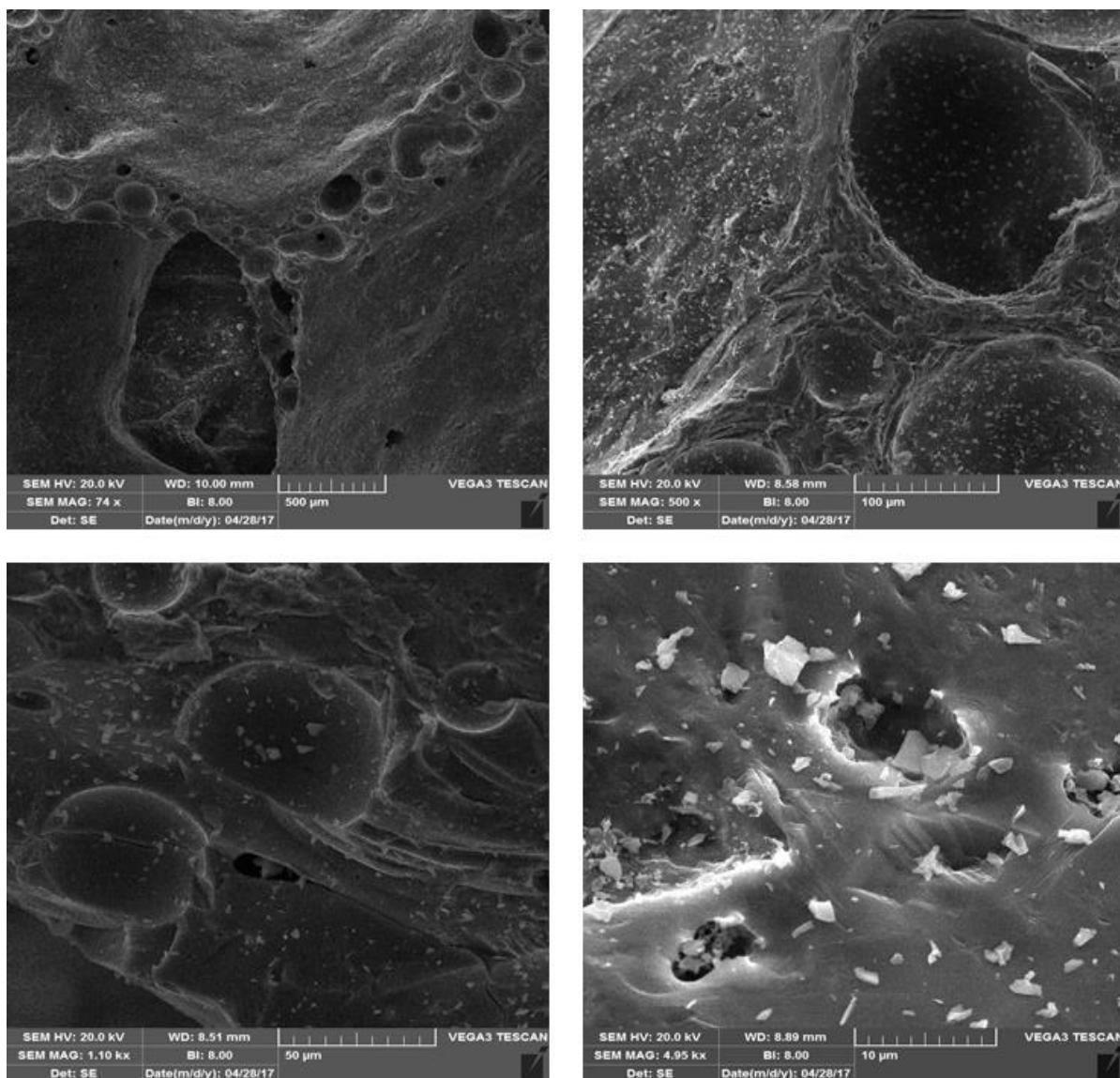
**Slika 27.** SEM mikrografije referentnog pjenostakla označe SP1 sastava: 99 mas. % otpadnog stakla (S) i 1 mas. % otpadnog vapnenca (P); skala veličine naznačena na mikrogafiji.
