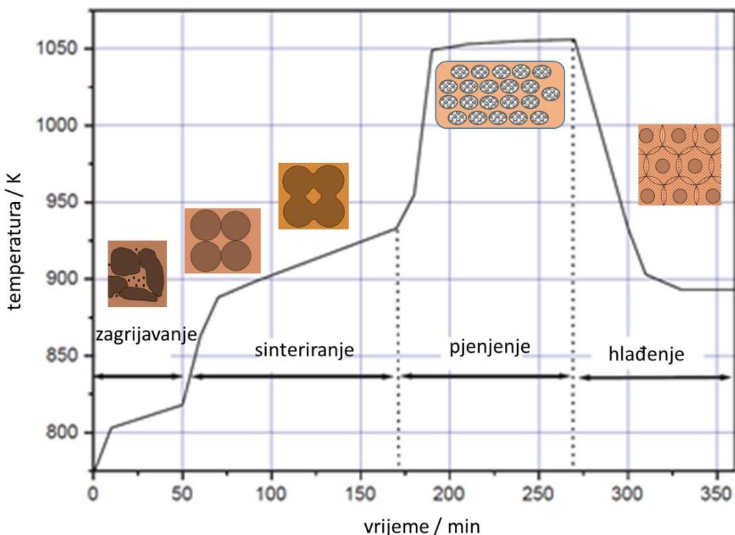
Slika 4. Proces toplinske obrade pri proizvodnji pjenostakla. Prilagođeno prema ref. [111].
