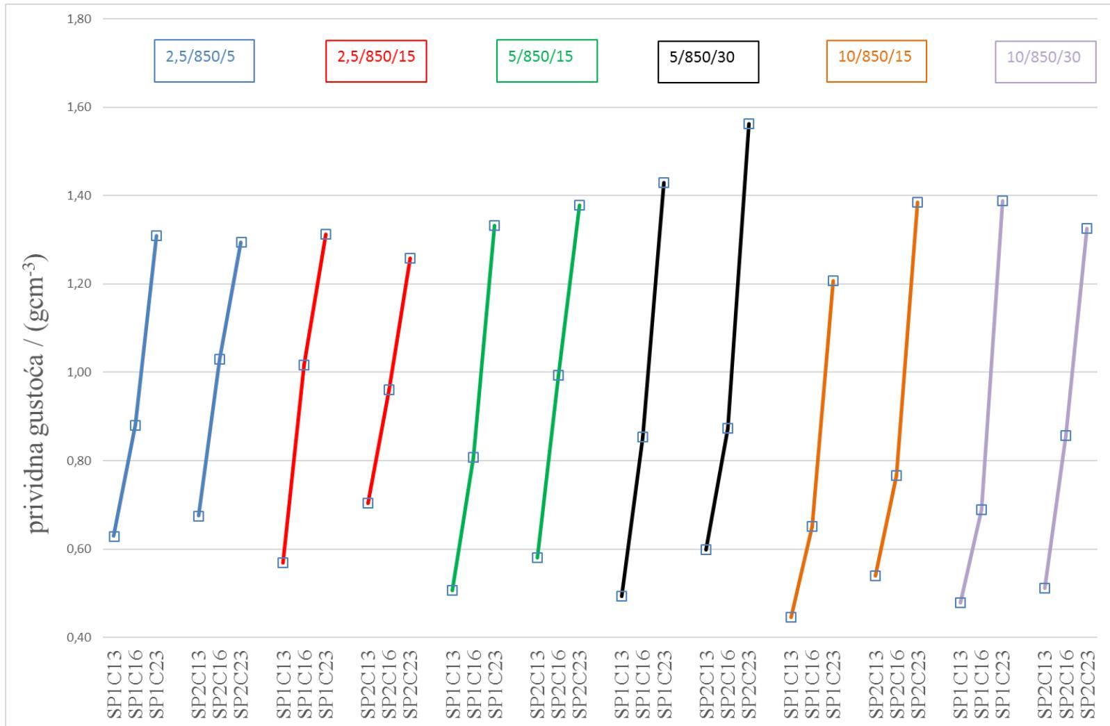
**Slika 14.** Prikaz ovisnosti gustoće pjenostaklenih uzoraka sastava prema tablici 10 o toplinskoj obradi brojčane oznake x/y/z koja predstavlja režim toplinske obrade uzorka gdje je x brzina zagrijavanja ( $^{\circ}\text{C}/\text{min}$ ), y vršna temperatura toplinske obrade ( $850^{\circ}\text{C}$ ) i z vrijeme zadrške na vršnoj temperaturi (min).
