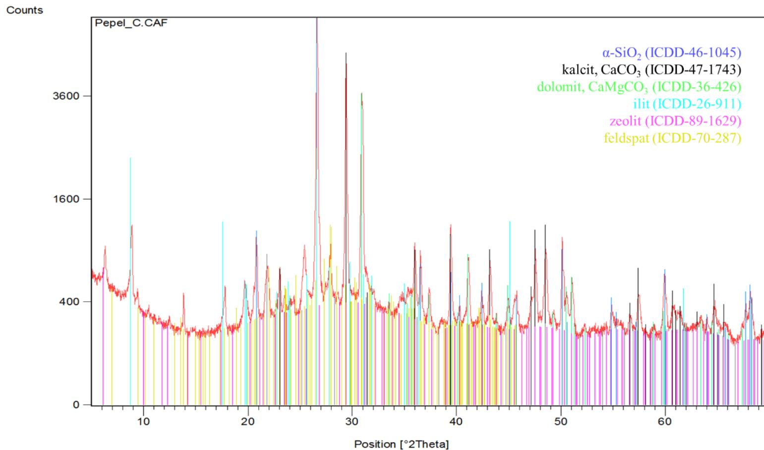
**Slika 10.** Rendgenski difraktogrami pepela (C) žarenog na 550°C 2h. Položaji i intenziteti difrakcijskih maksimuma kristalne faze označene su odgovarajućom bojom prema podacima iz ICDD baze podataka:  $\alpha$ -kvarc,  $\alpha$ -SiO<sub>2</sub> (ICDD-46-1045); kalcit, CaCO<sub>3</sub> (ICDD-47-1743) i dolomit, CaMgCO<sub>3</sub> (ICDD-36-426), ilita (ICDD-26-911), zeolita (ICDD-89-1629) i feldspata (ICDD-70-287).
