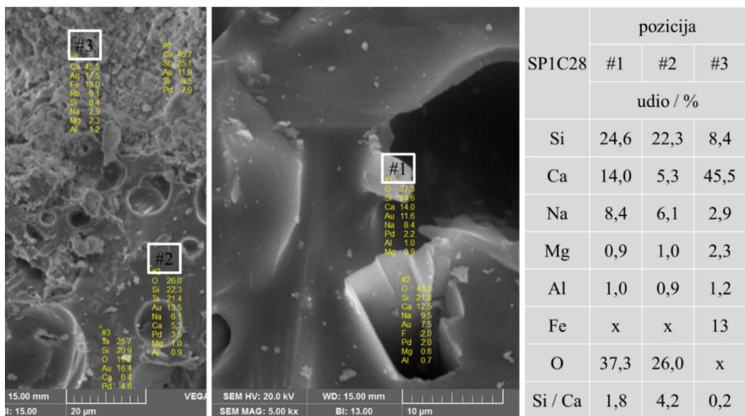
**Slika 40.** SEM/EDS mikrografije pjenostakla oznake SP1C28 sastava: 71 mas. % otpadnog stakla (S), 1 mas. % otpadnog vapnenca (P) te otpadnog pepela (C) od 28 mas. %; EDS analiza prikazana tablično za tri pozicije.
