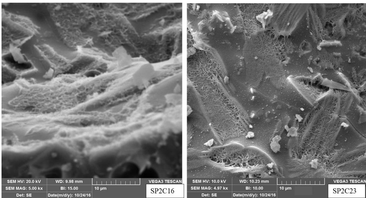
**Slika 35.** SEM mikrografije pjenostakla oznake SP2C16 sastava: 82 mas. % otpadnog stakla (S), 2 mas. % otpadnog vapnenca (P) te otpadnog pepela (C) od 16 mas. %. i SP2C23 sastava: 75 mas. % otpadnog stakla (S), 2 mas. % otpadnog vapnenca (P) te otpadnog pepela (C) od 23 mas. %; skala veličine naznačena na mikrogafiji.
