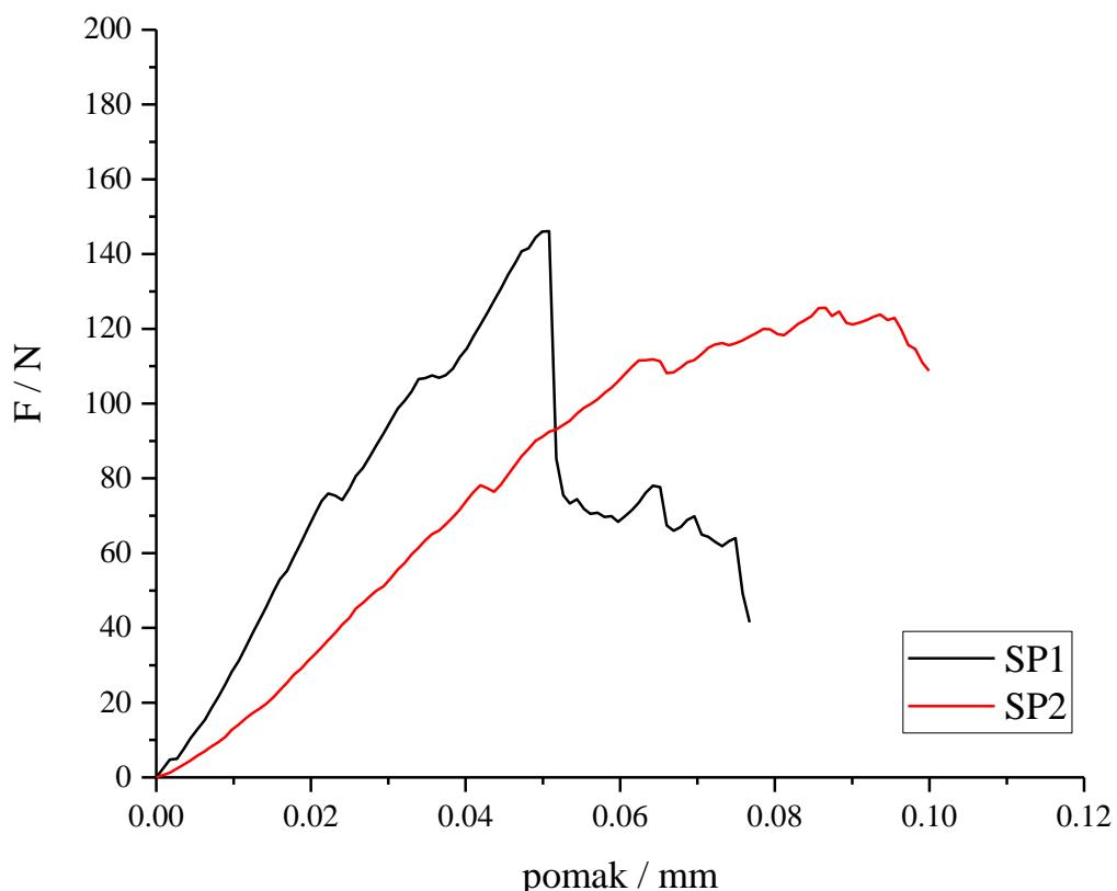
**Slika 41.** Prirast sile referentnih pjenostakla oznaka SP1C sastava: 99 mas. % otpadnog stakla (S) i 1 mas. % otpadnog vapnenca (P) i SP2C sastava: 98 mas. % otpadnog stakla (S) i 2 mas. % otpadnog vapnenca (P).
