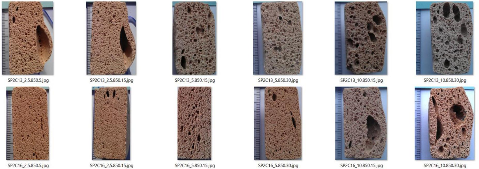
**Slika 13.** Fotografije uzoraka pjenostakla sastava 2 mas. % agensa za pjenjenje (P) sa 13 i 16 mas. % pepela (C) (oznake uzoraka prema tablici 10). Brojčana oznaka  $x.y.z$  predstavlja režim toplinske obrade uzoraka gdje je  $x$  brzina zagrijavanja ( $^{\circ}\text{C}/\text{min}$ ),  $y$  vršna temperatura termičke obrade ( $850^{\circ}\text{C}$ ) i  $z$  vrijeme zadrške na vršnoj temperaturi (min).
