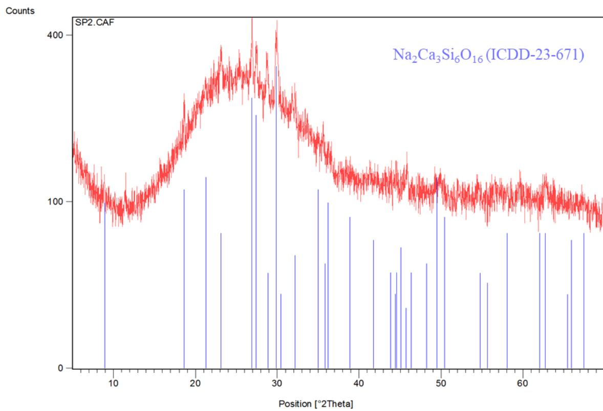
**Slika 18.** Rendgenski difraktogrami referentnog pjenostakla oznake SP2 sastava: 98 mas. % otpadnog stakla (S) i 2 mas. % otpadnog vapnenca (P). Položaji i intenziteti difrakcijskih maksimuma kristalne faze označene su odgovarajućom bojom prema podacima iz ICDD baze podataka, natrijev - kalcijev silikat,  $\text{Na}_2\text{Ca}_3\text{Si}_6\text{O}_{16}$  (ICDD-23-671).
