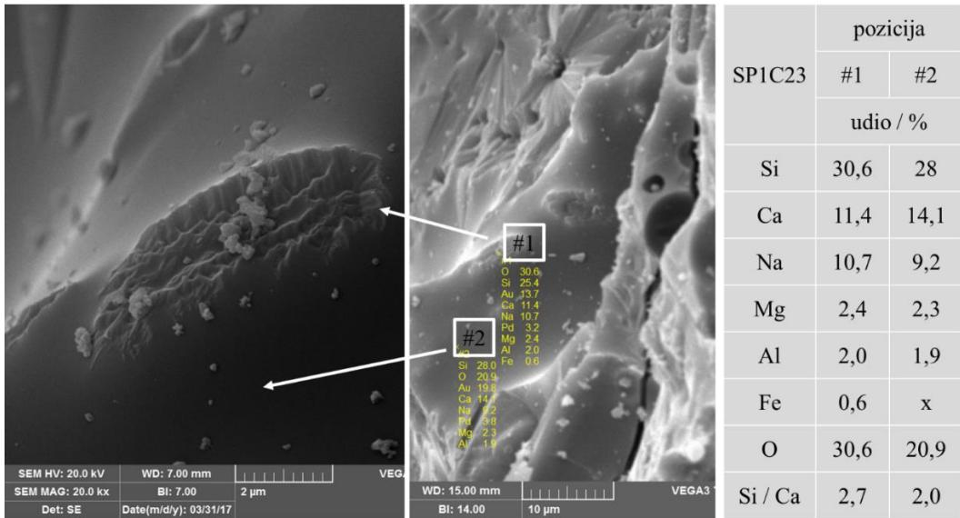
**Slika 39.** SEM/EDS mikrografije pjenostakla oznake SP1C23 sastava: 76 mas. % otpadnog stakla (S), 1 mas. % otpadnog vapnenca (P) te otpadnog pepela (C) od 23 mas. %; prikaz mjesta EDS analize pri različitim povećanjima; EDS analiza prikazana tablično za dvije pozicije.
