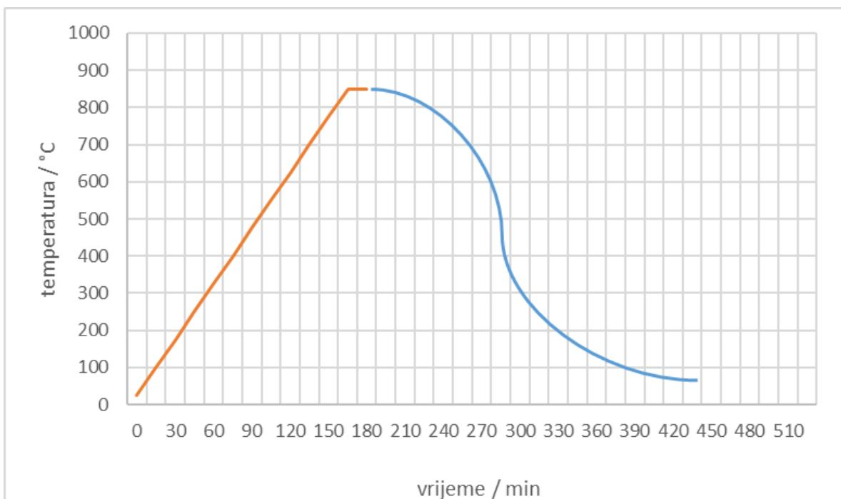
**Slika 5.** Shema toplinske obrade sirove smjese pjenostakla
