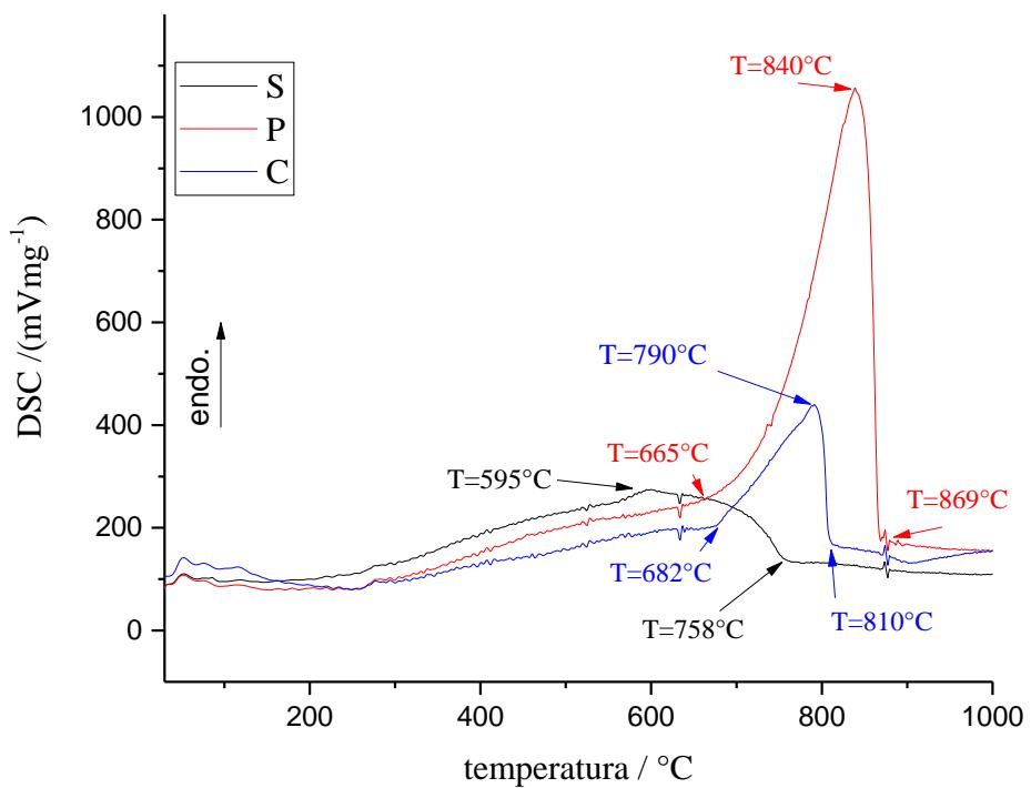
**Slika 8.** DSC analiza otpadnih sirovina pepela (C), stakla (S) i vapnenca (P)
