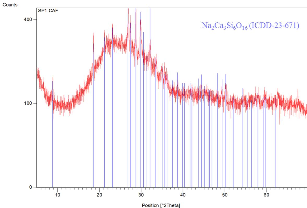
**Slika 17.** Rendgenski difraktogrami referentnog pjenostakla oznake SP1 sastava: 99 mas. % otpadnog stakla (S) i 1 mas. % otpadnog vapnenca (P). Položaji i intenziteti difrakcijskih maksimuma kristalne faze označene su odgovarajućom bojom prema podacima iz ICDD baze podataka, natrijev - kalcijev silikat, Na<sub>2</sub>Ca<sub>3</sub>Si<sub>6</sub>O<sub>16</sub> (ICDD-23-671).
