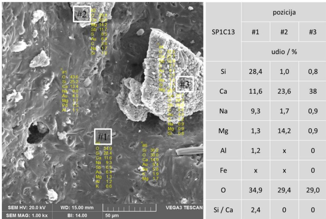
**Slika 37.** SEM/EDS mikrografije pjenostakla oznake SP1C13 sastava: 86 mas. % otpadnog stakla (S), 1 mas. % otpadnog vapnenca (P) te otpadnog pepela (C) od 13 mas. %; EDS analiza prikazana tablično za tri pozicije.
