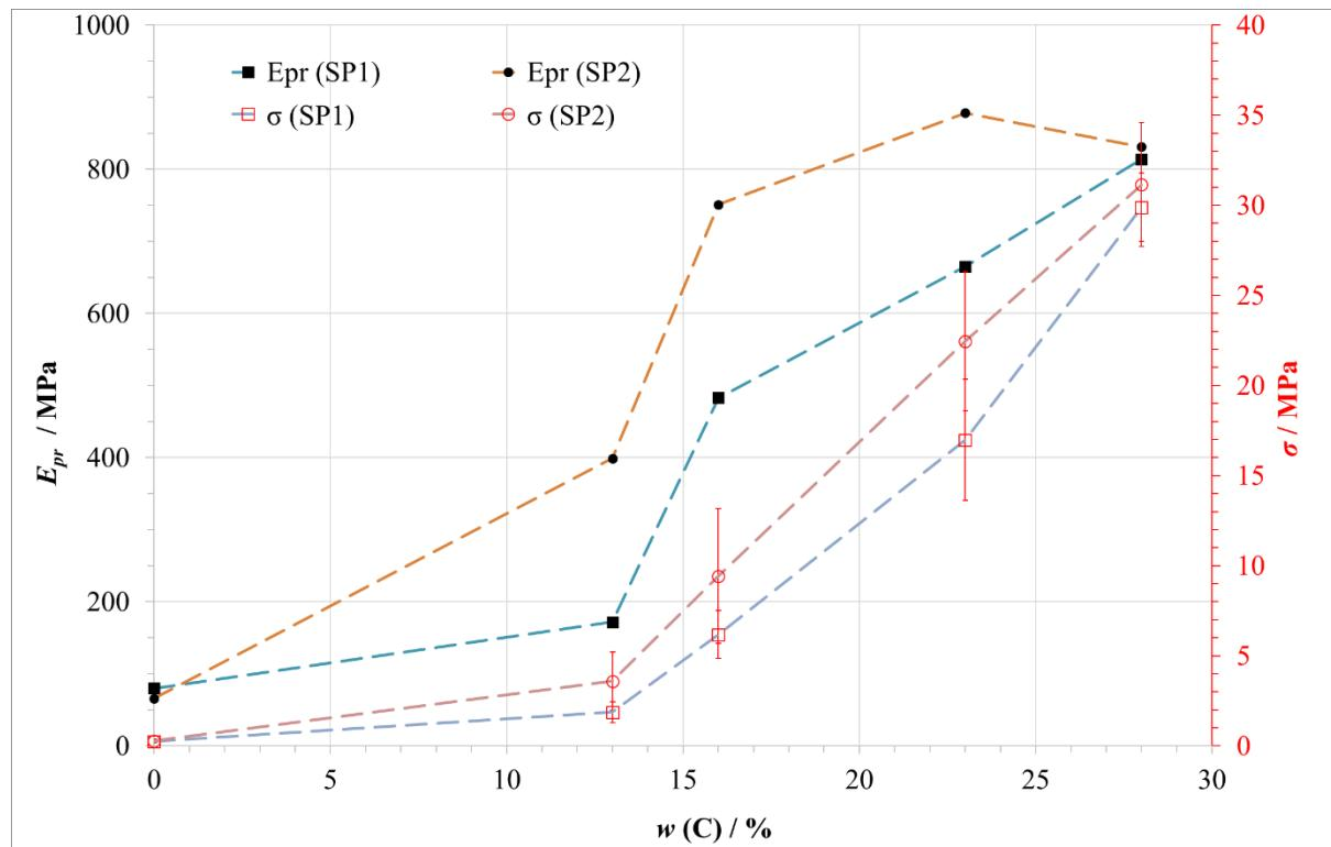
**Slika 48.** Prikaz ovisnosti prividnog Youngova modula elastičnosti ( $E_{pr}$ ) i tlačne čvrstoće ( $\sigma$ ) pjenostakla sastava prema tablici 10 sa udjelom agensa za pjenjenje od 1 mas. % (SP1) i 2 mas. % (SP2) o povećanju masenog udjela ( $w$ ) pepela (C).
