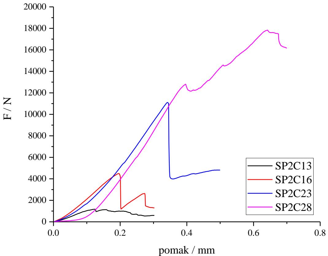
**Slika 43.** Prirast sile ispitivanih pjenostakla oznake SP<sub>x</sub>C<sub>y</sub> gdje je x mas. % agensa za pjenjenje (P) a y mas. % pepela (C) prema tablici 10.
