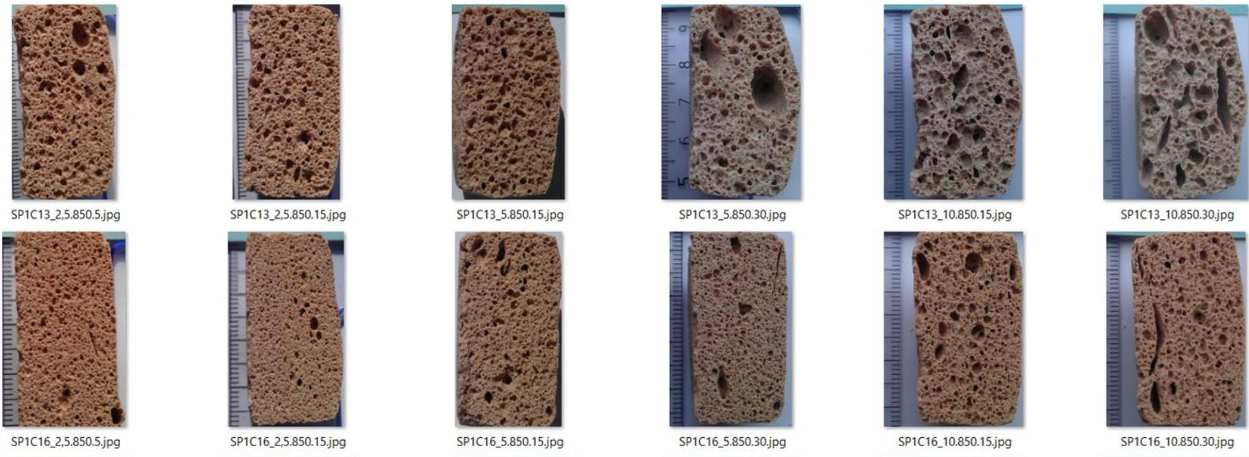
**Slika 12.** Fotografije uzoraka pjenostakla sastava 1 mas. % agensa za pjenjenje (P) sa 13 i 16 mas. % pepela (C) (oznake uzoraka prema tablici 10). Brojčana oznaka  $x.y.z$  predstavlja režim toplinske obrade uzorka gdje je  $x$  brzina zagrijavanja ( $^{\circ}\text{C}/\text{min}$ ),  $y$  vršna temperatura termičke obrade ( $850^{\circ}\text{C}$ ) i  $z$  vrijeme zadrške na vršnoj temperaturi (min).
