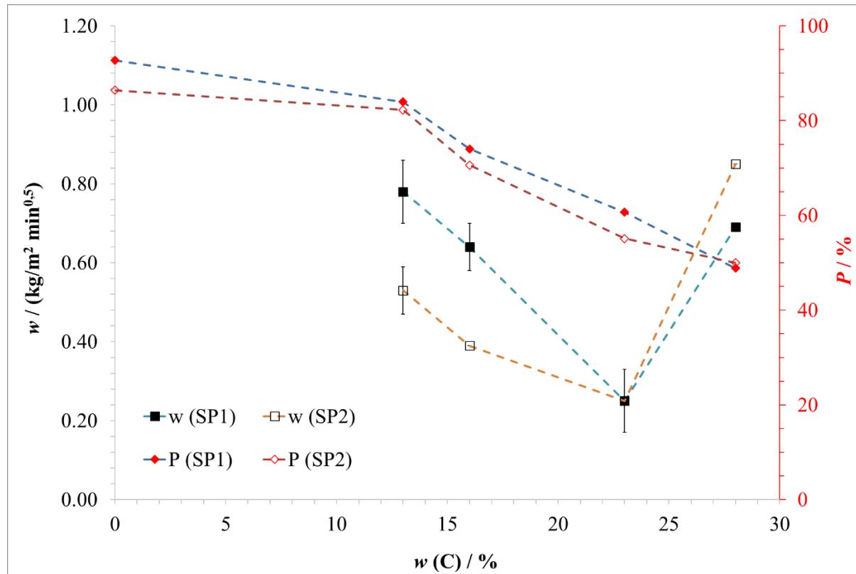
**Slika 49.** Prikaz ovisnosti vodoupojnosti ( $w$ ) i poroznosti ( $P$ ) pjenostakla sastava prema tablici 10 sa udjelom agensa za pjenjenje od 1 mas % (SP1) i 2 mas. % (SP2) o povećanju masenog udjela ( $w$ ) udjela pepela ( $C$ ).
