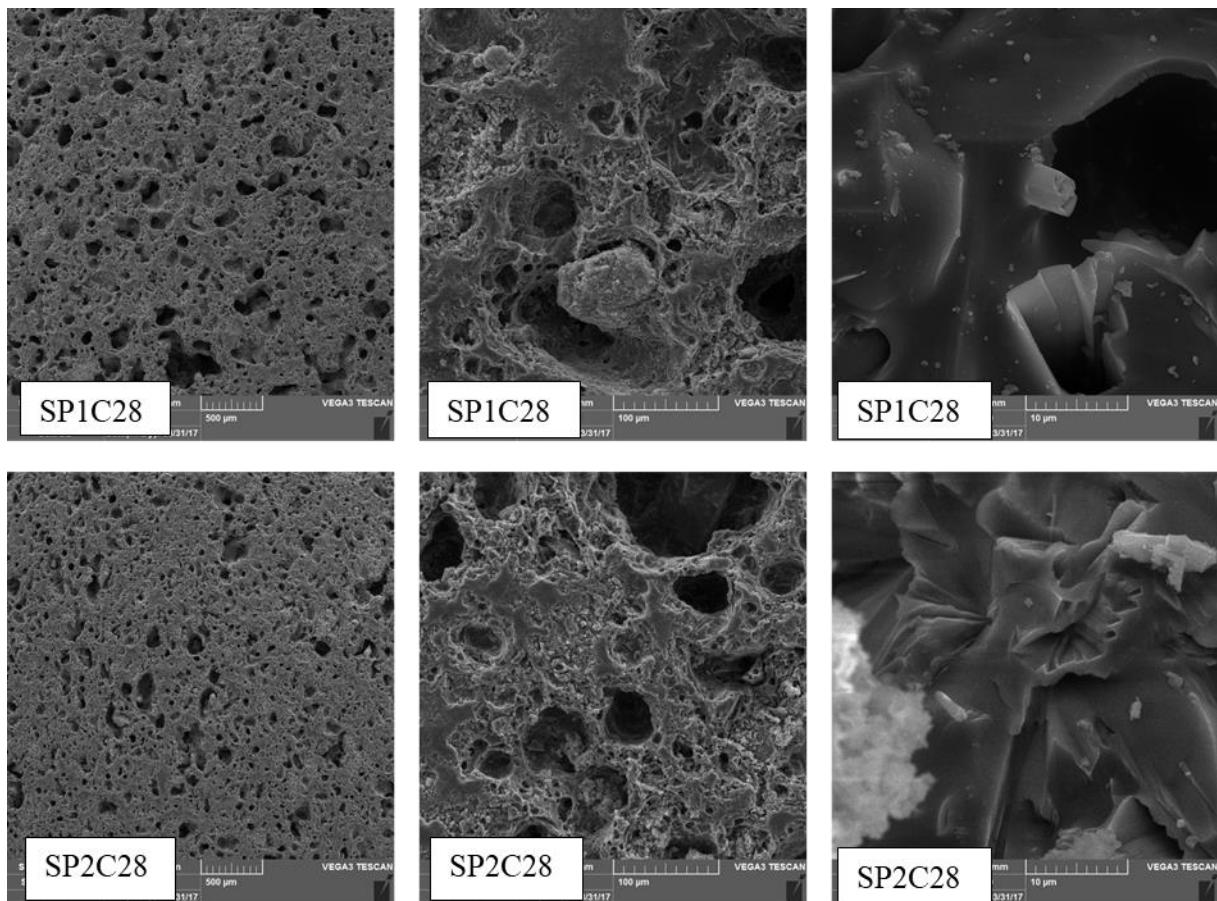
**Slika 34.** SEM mikrografije pjenostakla oznake SP1C28 sastava: 71 mas. % otpadnog stakla (S), 1 mas. % otpadnog vaspnenca (P) te otpadnog pepela (C) od 28 mas. %. i SP2C28 sastava: 70 mas. % otpadnog stakla (S), 2 mas. % otpadnog vaspnenca (P) te otpadnog pepela (C) od 28 mas. %. sa masenim udjelom otpadnog pepela (C) od 28 mas. %.; skala veličine naznačena na mikrogafiji.
