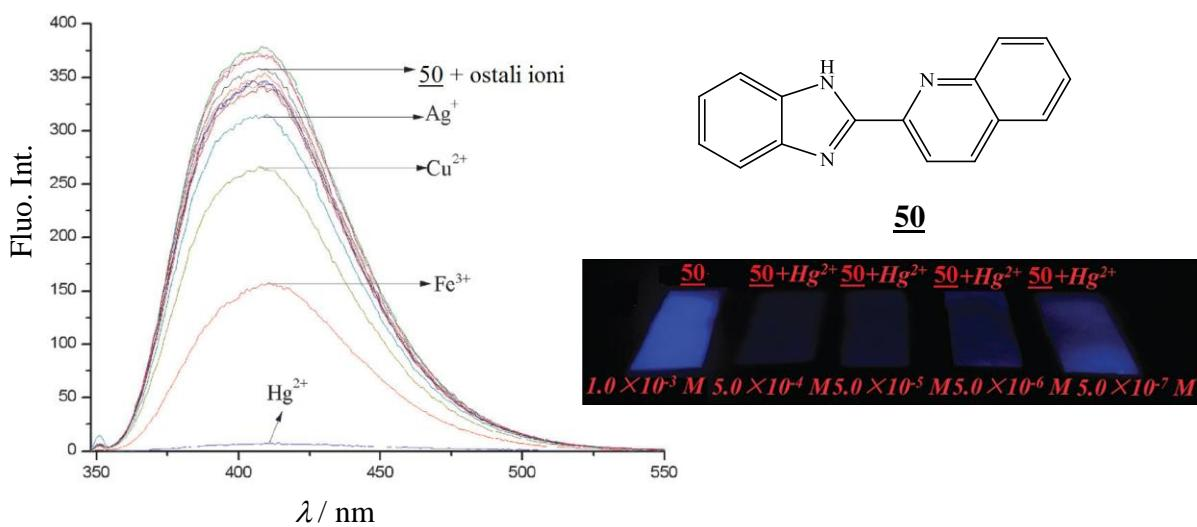
**Slika 34.** Optički kemijski senzor za živu temljen na derivatu benzimidazola **50**; gašenje fluorescencije uzrokovano koordiniranjem živinog iona (lijevo); test trakice za određivanje žive u uzorku (desno) adaptirano iz [174].
