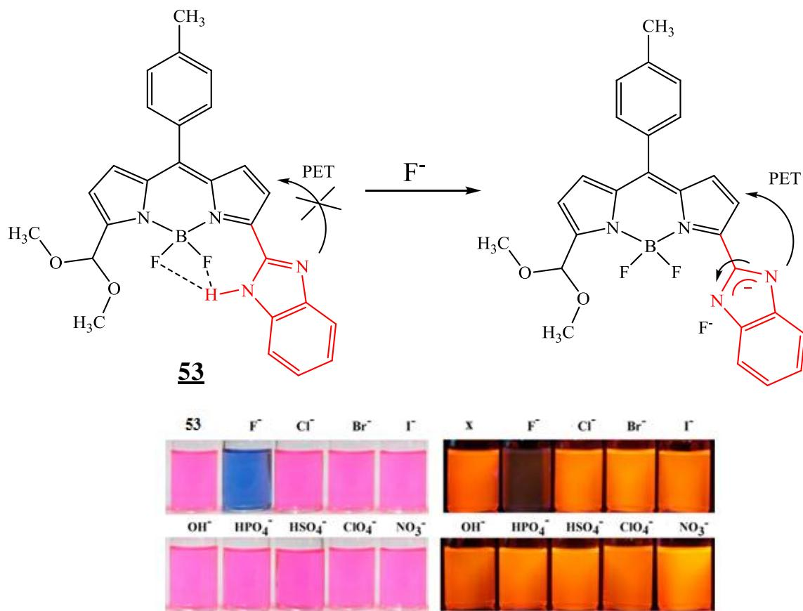
**Slika 36.** Senzor za  $\text{F}^-$  temeljen na fotoinduciranom prijenosu elektrona između benzimidazolne i BODIPY jedinice, adaptirano iz [209].
