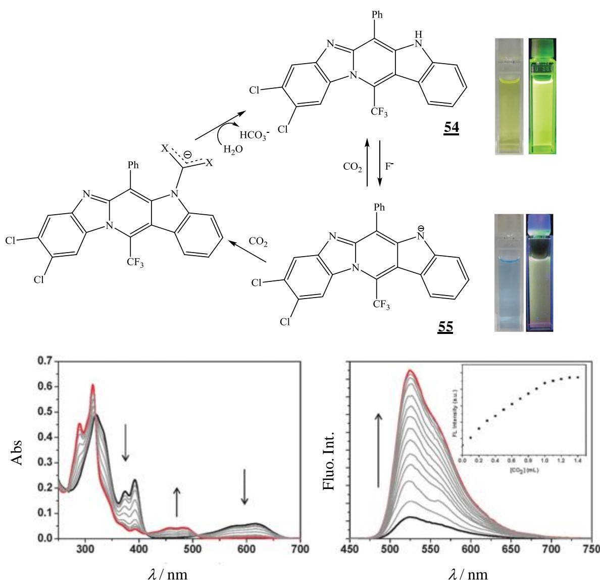
Slika 37. Optički kemijski senzor za CO<sub>2</sub> temeljen na derivatu benzimidazola, adaptirano iz [223].
