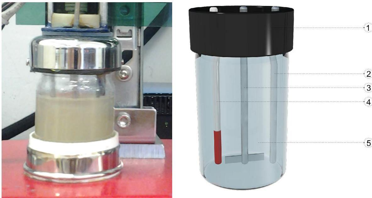
**Slika 3.2.** Fotografija reaktora u laboratoriju i prikaz reaktora s označenim dijelovima (1 – poklopac, 2 – kapilara za uzorkovanje, 3 – turbinesko miješalo, 4 – grijalo, 5 – staklena posuda)
