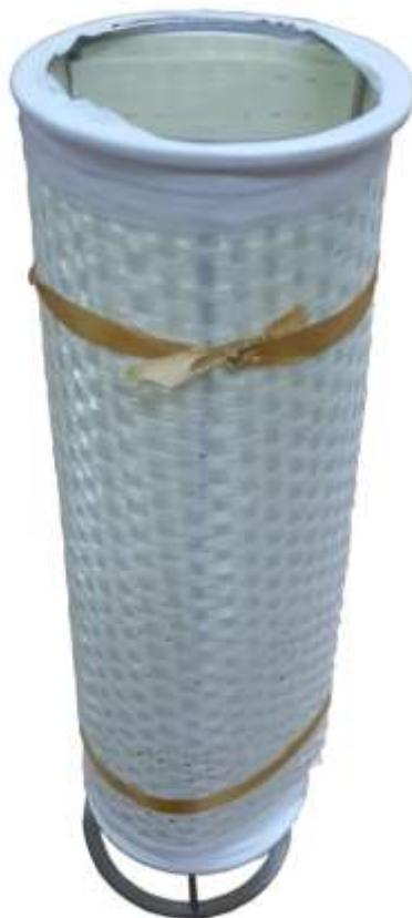
**Slika 3.2.** Modul sa slojem fotokatalizatora ( $TiO_2$ /kitozan) impregniranim na staklenom platnu i učvršćenim na nosač izrađen iz inoksa.
