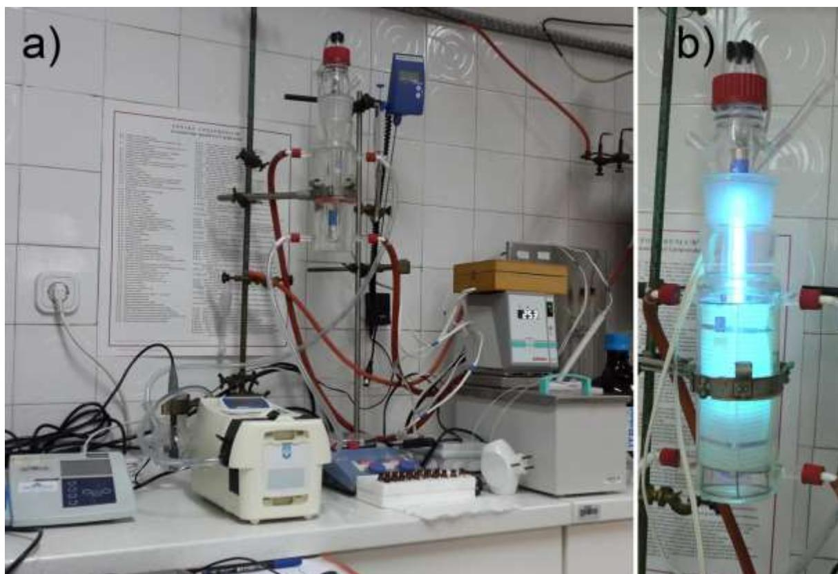
**Slika 3.5.a** Fotografija eksperimentalnog reaktorskog sustava i **b** fotokatalitičkog reaktora
