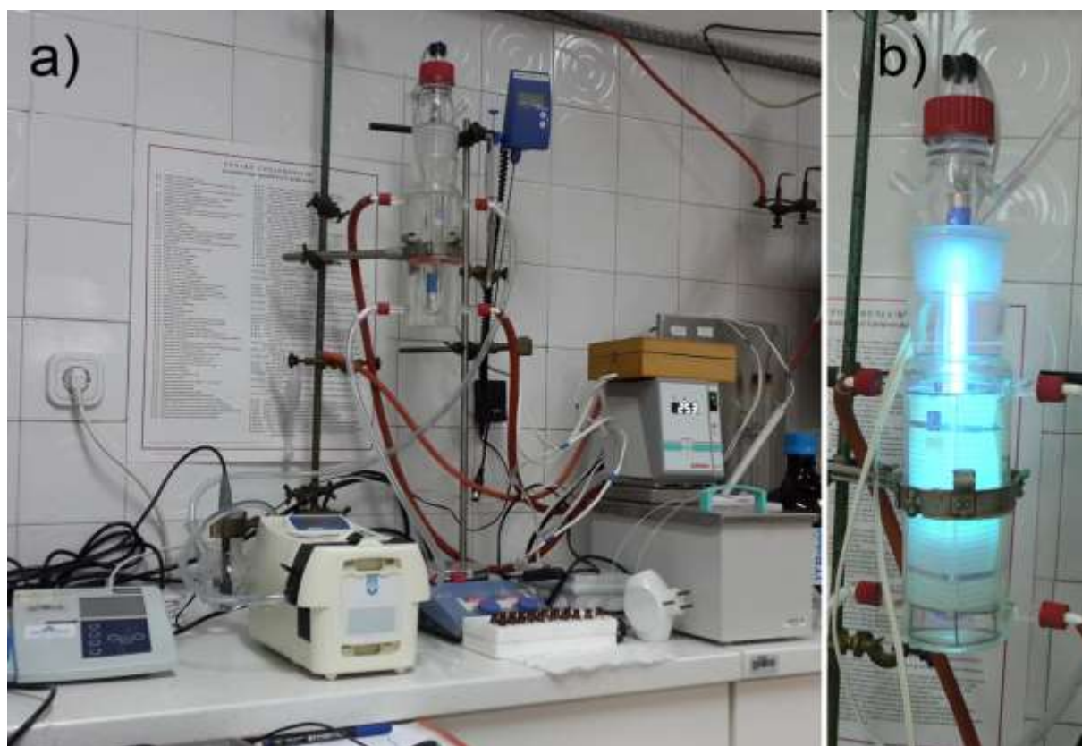
Slika 3.5.a Fotografija eksperimentalnog reaktorskog sustava i b fotokatalitičkog reaktora
