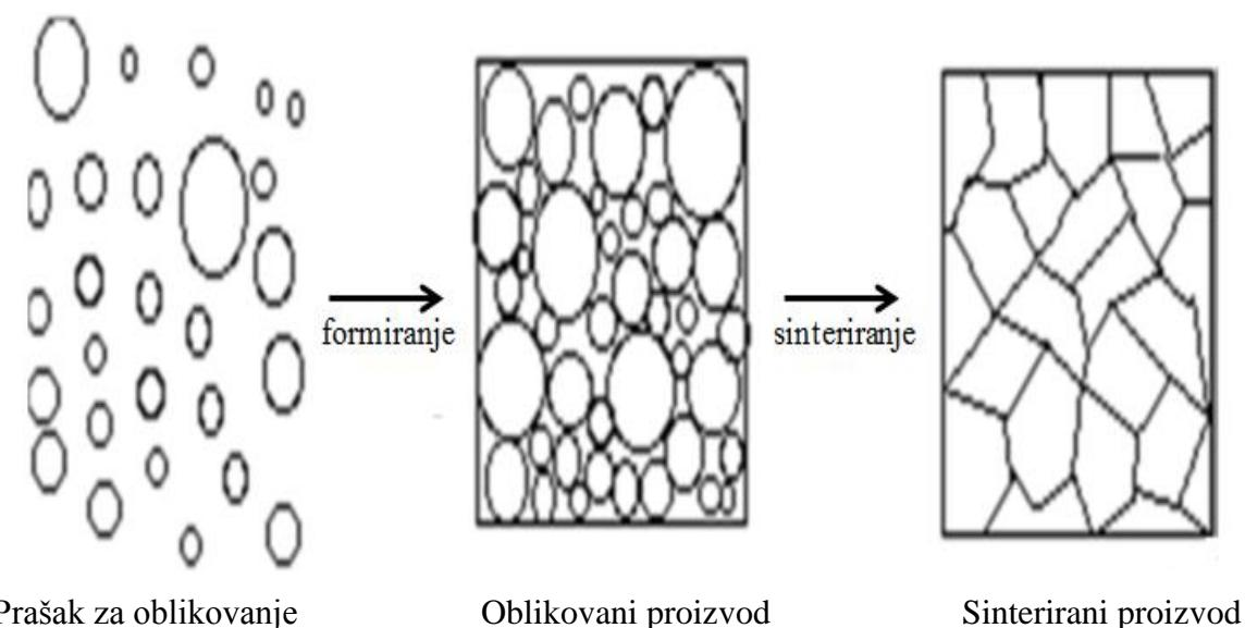
*Slika 6* : Prikaz čestica gline od praha do sinteriranog proizvoda<sup>11</sup>
