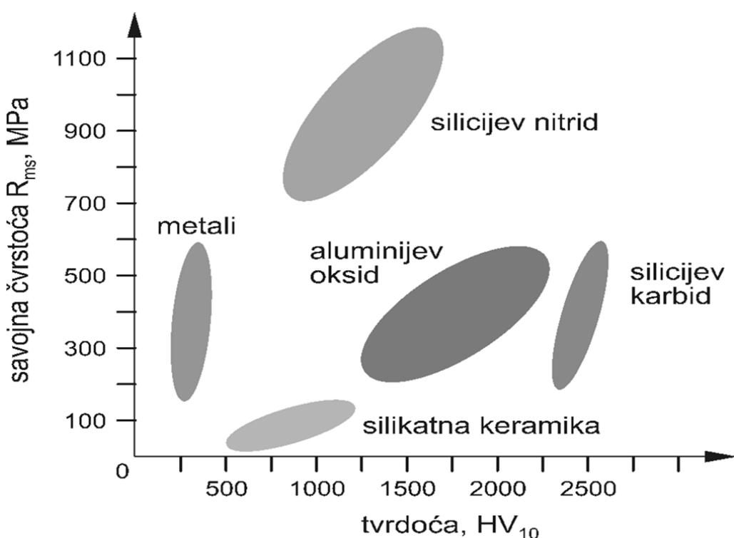
**Slika 90:** Područja vrijednosti tvrdoća i savojne čvrstoće pojedinih vrsta keramika<sup>11</sup>
