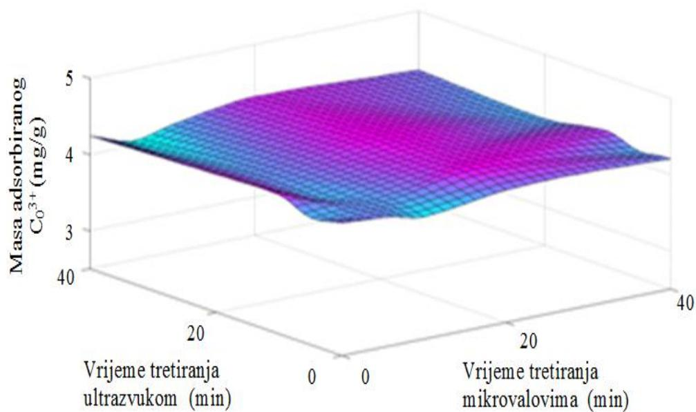
**Slika 40:** Ovisnost mase adsorbiranog kobalta o vremenu obrade gline pri snazi ultrazvuka 1200 W, te snazi mikrovalova a) 150 W, b) 300 W, c) 600 W.
