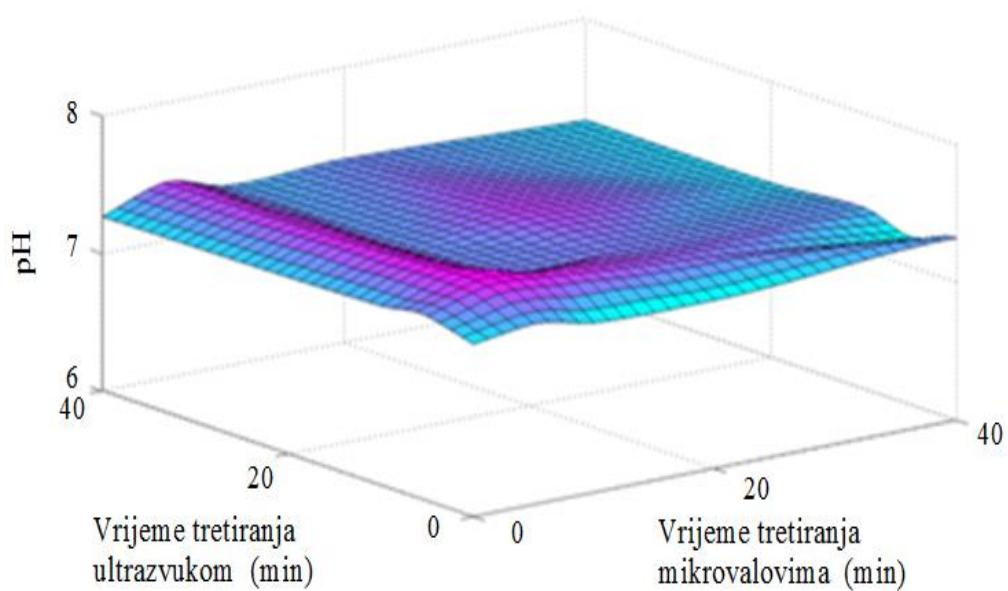
**Slika 43:** Ovisnost pH vrijednosti o vremenu obrade gline pri snazi ultrazvuka 1200 W te snazi mikrovalova a) 150 W, b) 300 W, c) 600 W.
