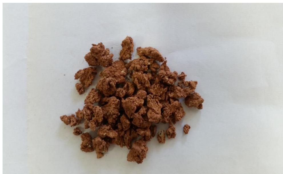
**Slika 50:** Prikaz dehidriranog mulja izloženog temperaturi od 1050°C
