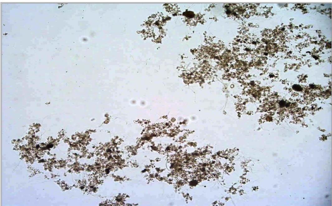
**Slika 12 :** Mikrofotografija aerobnog aktivnog mulja ( $P=400\times$ )<sup>61</sup>
