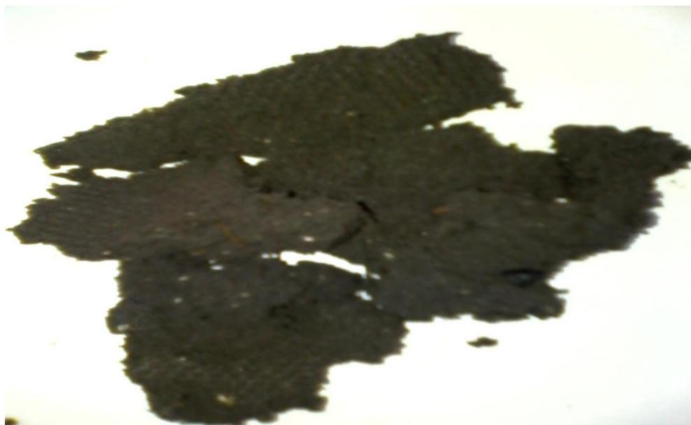
*Slika 45:* Prikaz sirovog dehidriranog mulja ( tvz. kolača )
