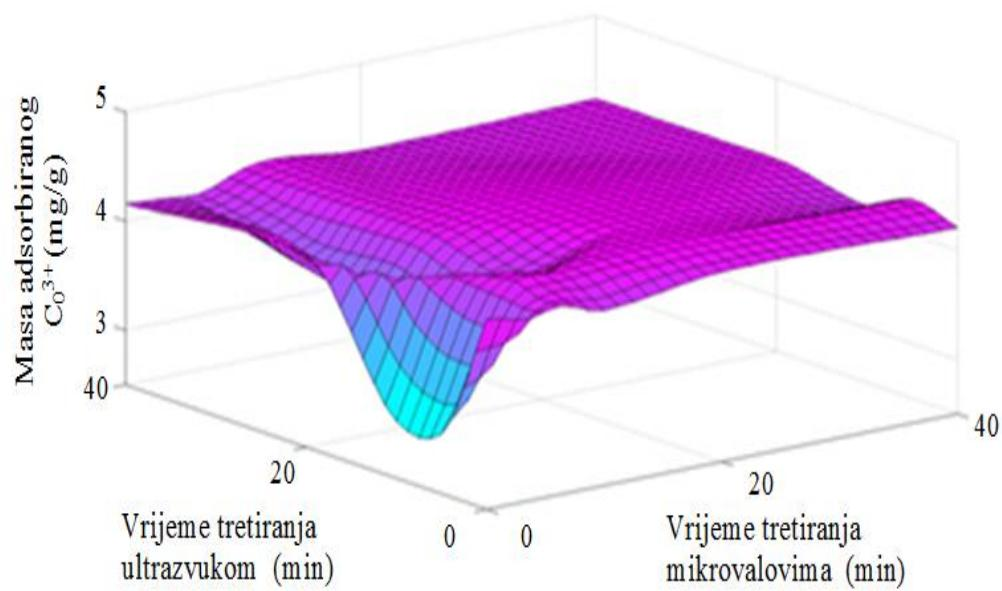
**Slika 39:** Ovisnost mase adsorbiranog kobalta o vremenu obrade gline pri snazi ultrazvuka 600 W, te snazi mikrovalova a) 150 W, b) 300 W i c) 600 W.
