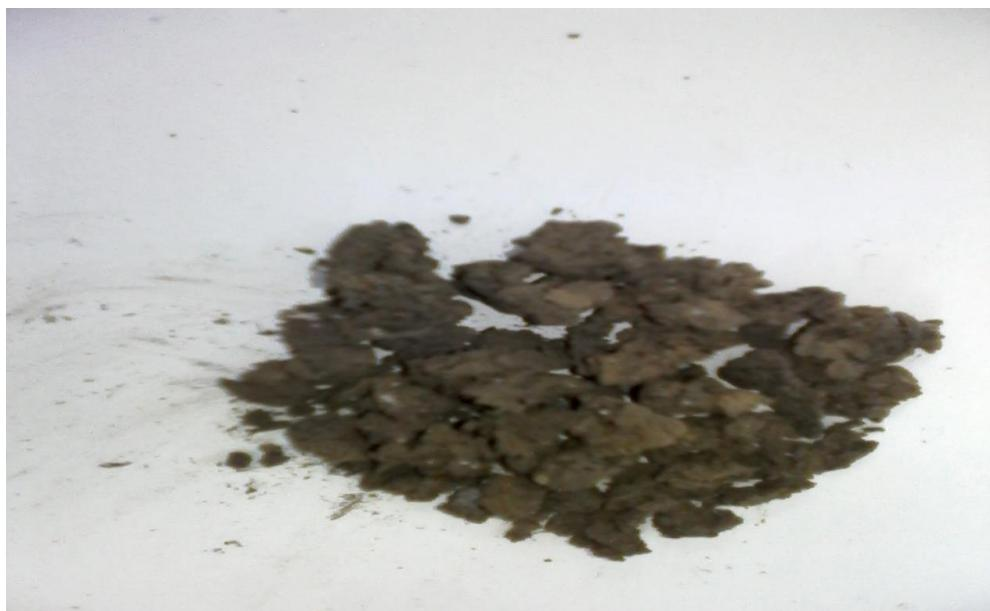
**Slika 47:** Prikaz dehidriranog mulja izloženog temperaturi od 500 °C
