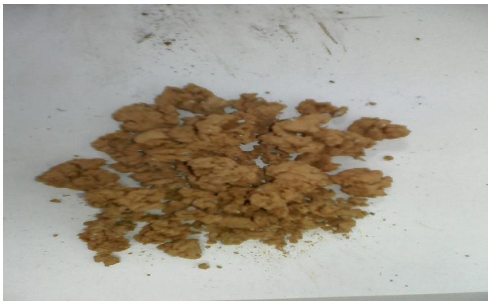
**Slika 48:** Prikaz dehidriranog mulja izloženog temperaturi od 700 °C
