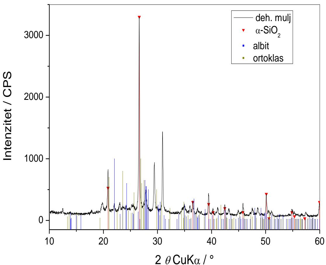
**Slika 51:** Difrakcijski spektar sušenog kanalizacijskog mulja na  $300\text{ }^{\circ}\text{C}$
