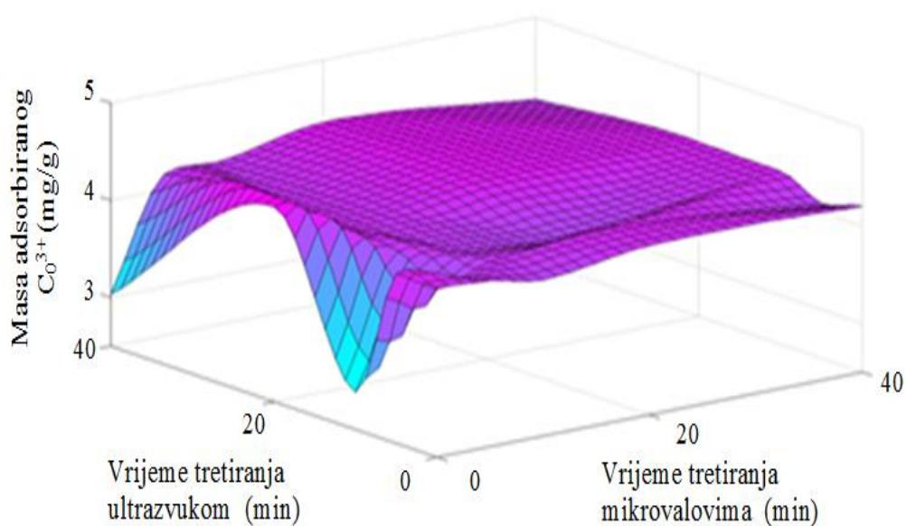
**Slika 38:** Ovisnost mase adsorbiranog kobalta o vremenu obrade gline pri snazi ultrazvuka 240 W, te snazi mikrovalova a) 150 W, b) 300 W, c) 600 W.
