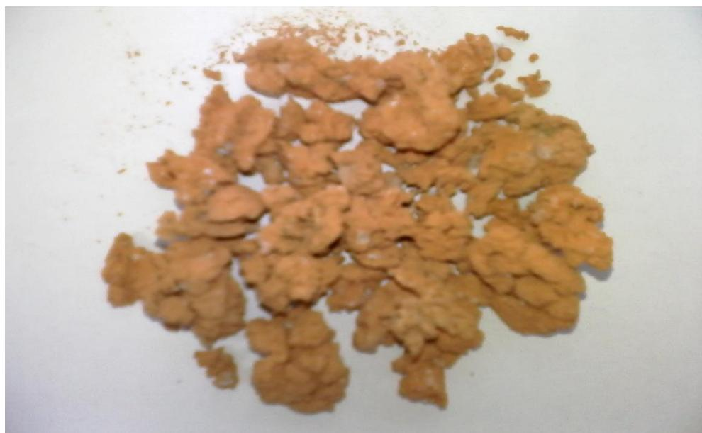
**Slika 49:** Prikaz dehidriranog mulja izloženog temperaturi od 900 °C
