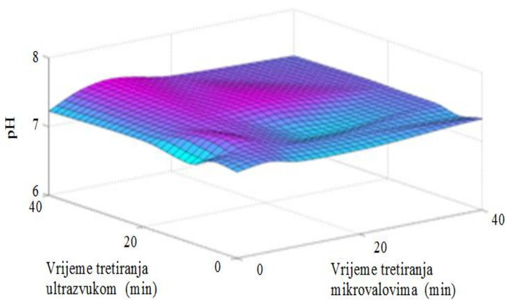
**Slika 41:** Ovisnost pH vrijednosti o vremenu obrade gline pri snazi ultrazvuka 240 W te snazi mikrovalova a) 150 W, b) 300 W, c) 600 W.
