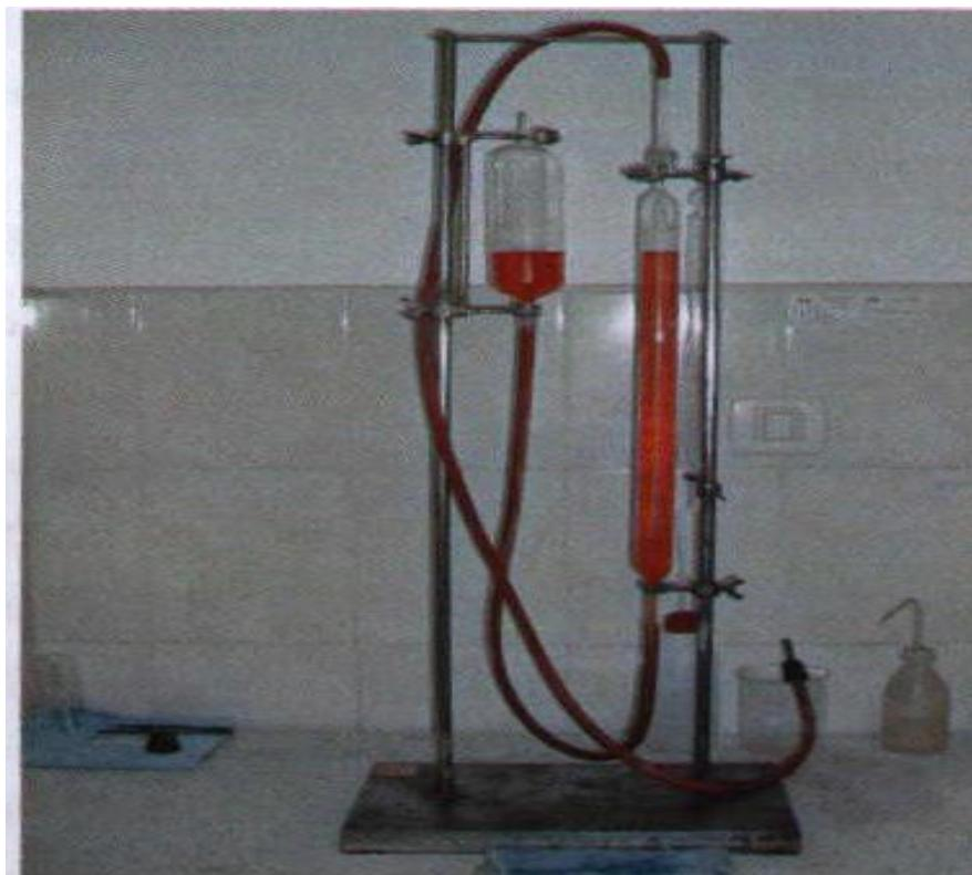
*Slika 23 : Aparatura za određivanje CO<sub>2</sub> – kalcimetar*
