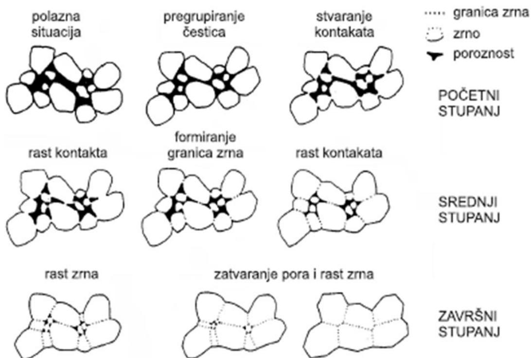
*Slika 7 : Rast zrna tijekom procesa sinteriranja<sup>11</sup>*
