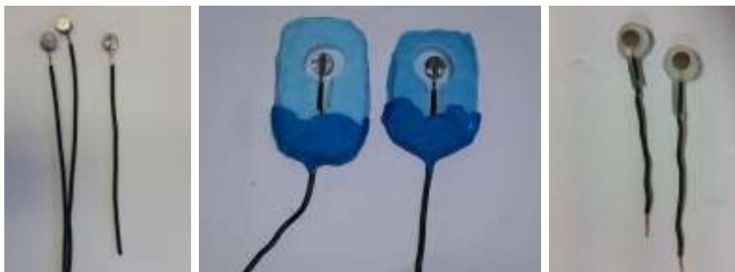
*Slika 3.1. Izrada radnih elektroda – zalijevanje CuNi elektroda u epoksidnu smolu*
