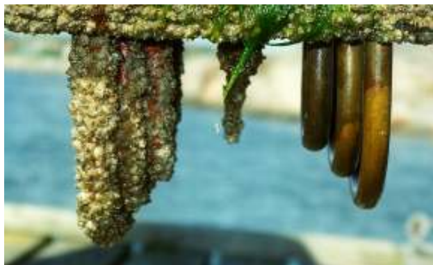
Slika 2.6. Usporedba cijevi zaštićenih premazom (lijeva strana) i cijevi izrađenih od legura bakra i nikla 18
