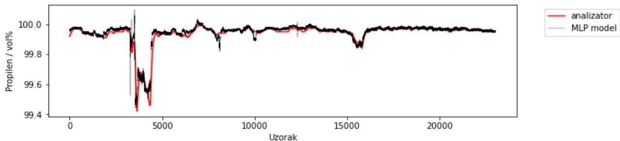
**Slika 19.** Usporebe između stvarnih podataka sadržaja propilena i vrijednosti dobivenih MLP modelom na cjelokupnim podacima za model ELU sa 10 neurona u skrivenom sloju
