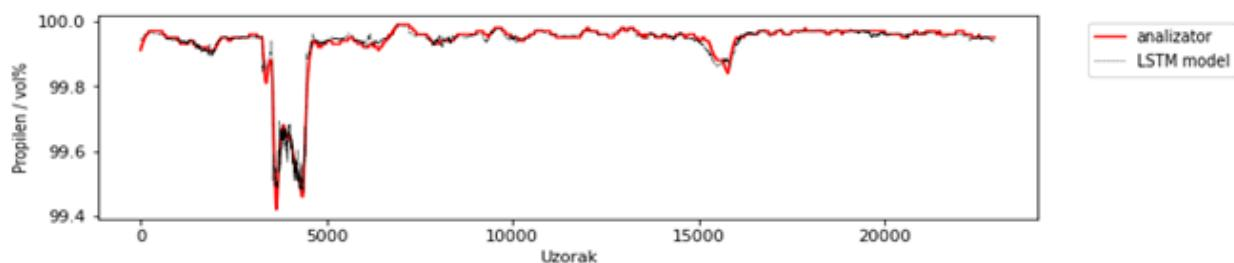
**Slika 47.** Usporedba između stvarnih podataka sadržaja propilena i vrijednosti dobivenih LSTM modelom na cjelokupnim podacima za model tanh sa 25 LSTM jedinica i 25 vremenskih koraka u prošlost
