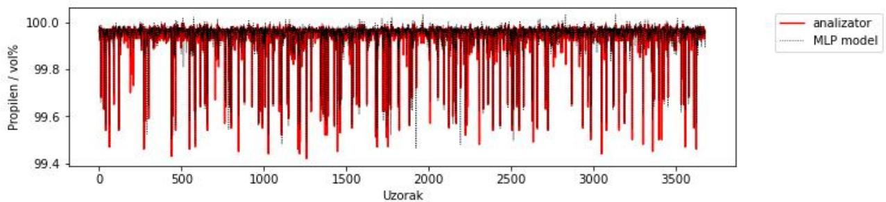
**Slika 18.** Usporedba između stvarnih podataka sadržaja propilena i vrijednosti dobivenih MLP modelom na validacijskim podacima za model ELU sa 10 neurona u skrivenom sloju
