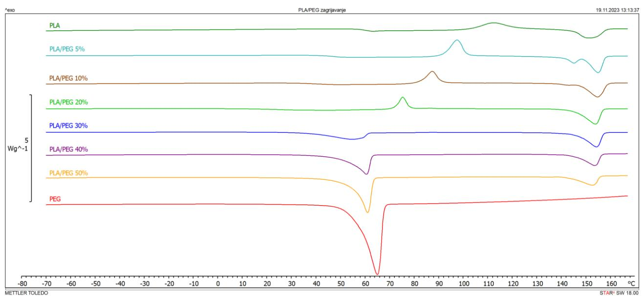
Slika 30. DSC termogram čistog PLA i PEG-a te PLA/PEG mješavina u ciklusu zagrijavanja
