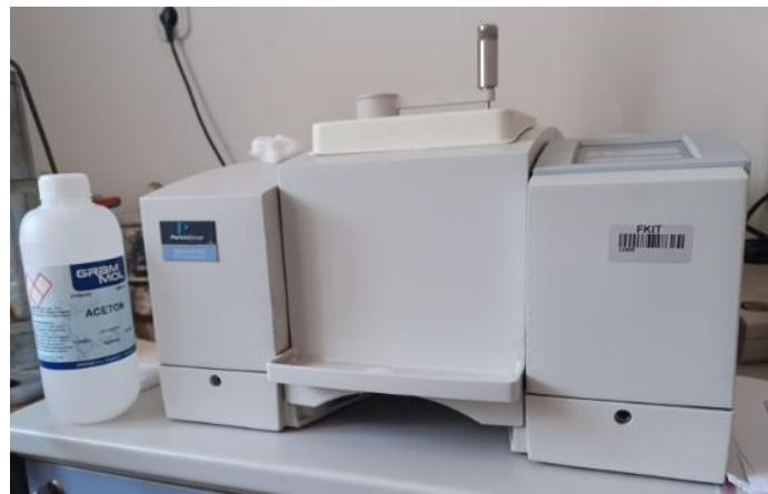
Slika 26. FTIR uređaj PerkinElmer Spectrum One
