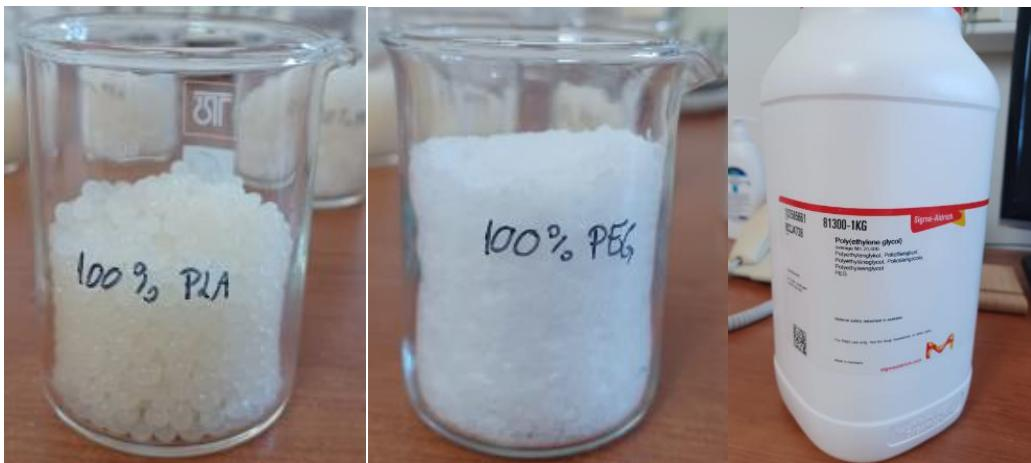
Slika 18. Prikaz upotrijeljenih polimera – s lijeva na desno : PLA granule, PEG granule
