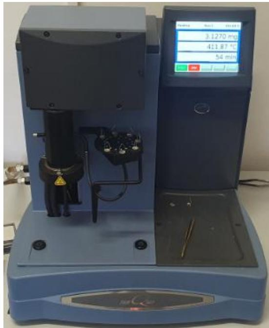
Slika 27. Uredaj za termogravimetrijsku analizu, TA Instruments Q500
