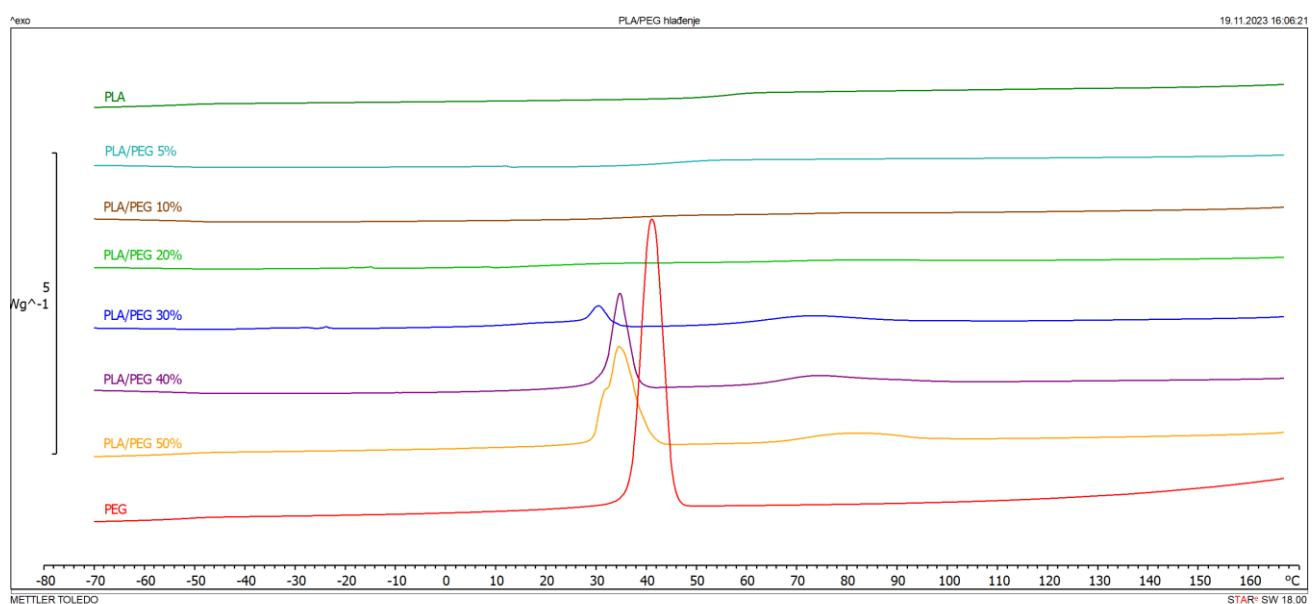
Slika 31. DSC termogram čistog PLA i PEG-a te PLA/PEG mješavina u ciklusu hlađenja
