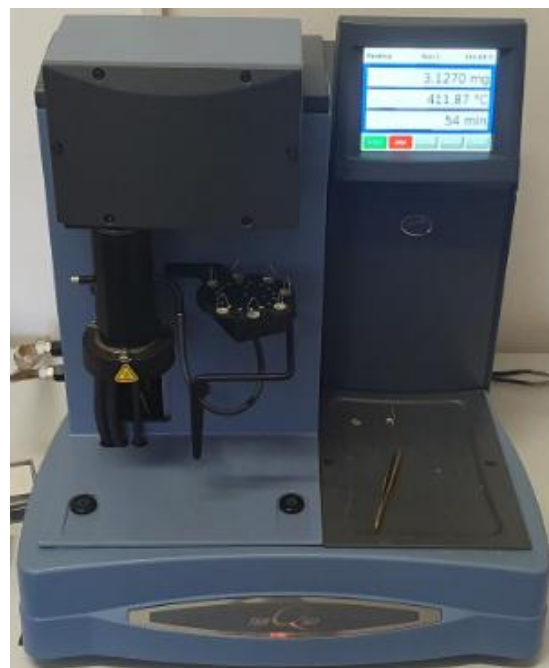
Slika 27. Uređaj za termogravimetrijsku analizu, TA Instruments Q500
