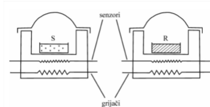
Slika 14. Shematski prikaz DSC uređaja
