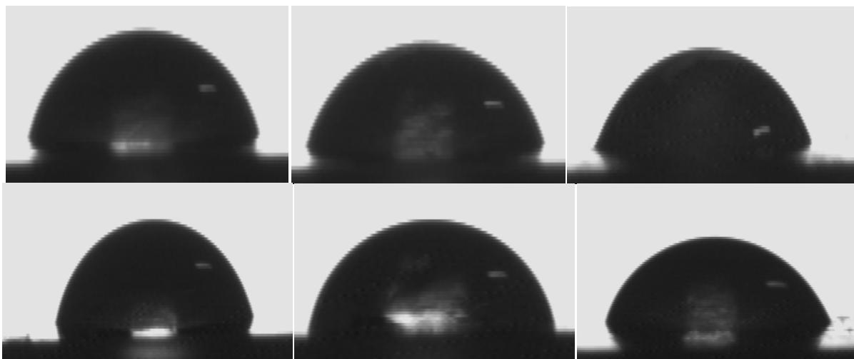
Slika 38. Prikaz kapljica na uzorcima polimernih mješavina ( s lijeva na desno: PLA/ 5% PEG, PLA/ 10% PEG, PLA/ 20% PEG, PLA/ 30% PEG, PLA/ 40% PEG, PLA/ 50% PEG)
