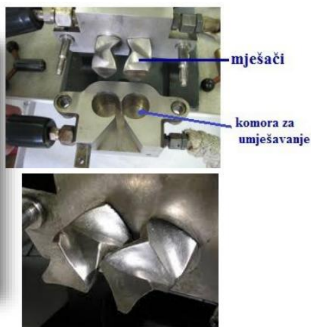
Slika 21. Prikaz komore za umješavanje i valjaka za rotiranje
