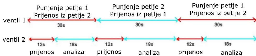
Slika 26. Shematski prikaz odnosa pozicija ventila u sustavu za prijenos analita tijekom analize
