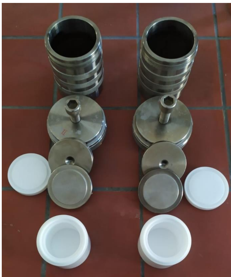
Slika 3. Čelične posude za hidrotermalnu sintezu (autoklavi) i teflonske posude u koje se stavljaju prekursori (bijeke posude i poklopci)
