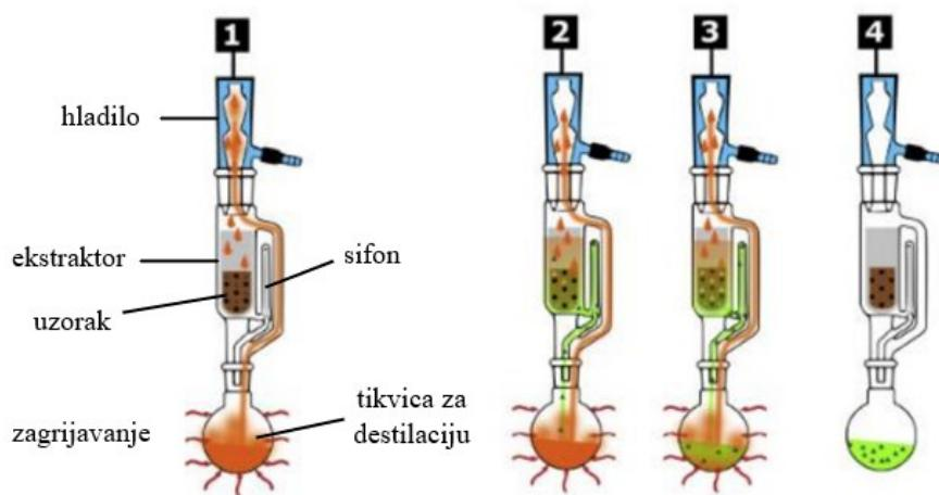
**Slika 4.** Soxhlet aparatura i ekstrakcija: 1 – isparavanje otapala, kondenzacija i natapanje uzorka, 2 – stvaranje otopine ekstrahirane tvari i preljevanje iz sifona u tikvicu za destilaciju, 3 – kontinuirano ponavljanje postupka, 4 – završetak ekstrakcije s otopinom ekstrahirane tvari u tikvici [17, 18].
