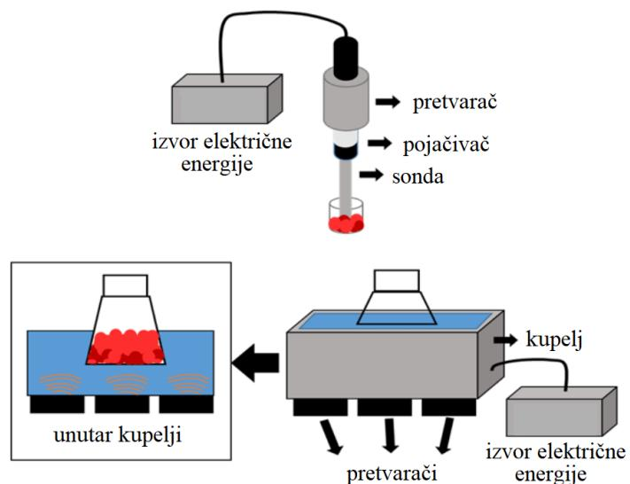
**Slika 5.** Ultrazvučna sonda i ultrazvučna kupelj [21].
