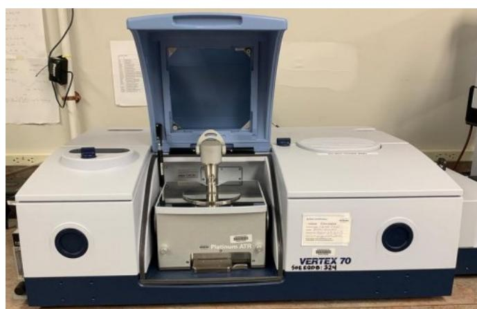
Slika 25. FTIR spektrometar Bruker Vertex 70.
