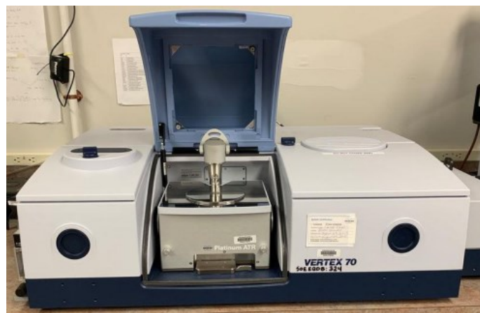
Slika 25. FTIR spektrometar Bruker Vertex 70.
