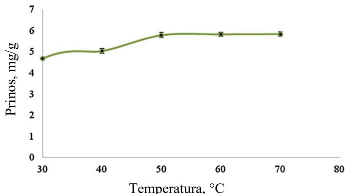
**Slika 9.** Utjecaj temperature ultrazučne kupelji na prinos piperina iz dugog papra uz parametre: vrijeme ekstrakcije 18 min, snaga ultrazvuka 125 W, frekvencija ultrazvuka 25 kHz, radni ciklus ultrazvuka 80 % [15].
