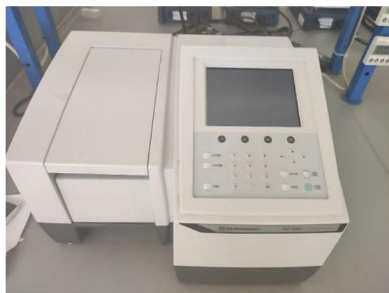
Slika 24. UV/Vis spektrometar Shimadzu UV-1280.
