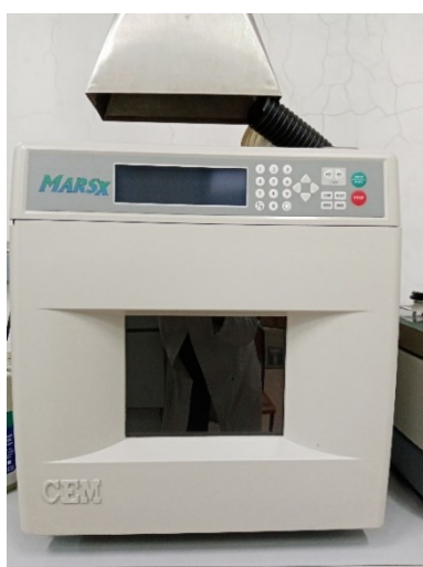
Slika 22. CEM MarsX mikrovalna pećnica i nosač s ekstrakcijskim posudama.
