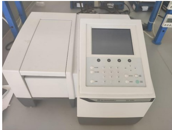
Slika 24. UV/Vis spektrometar Shimadzu UV-1280.
