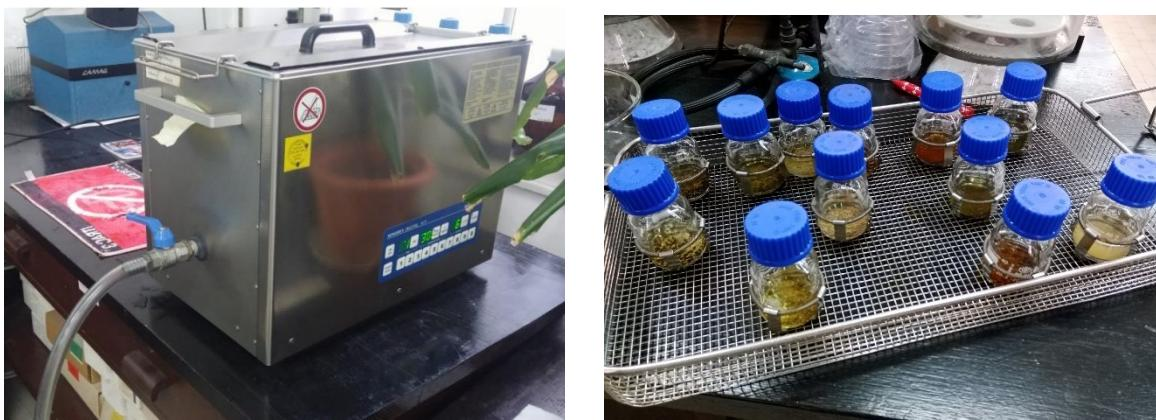
**Slika 21.** Ultrazvučna kupelj Bandelin Sonorex Digital 10 P i nosač s uzorcima.
