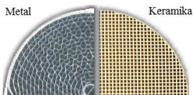
Slika 2.5. Monolitni katalitički supstrati [33]
