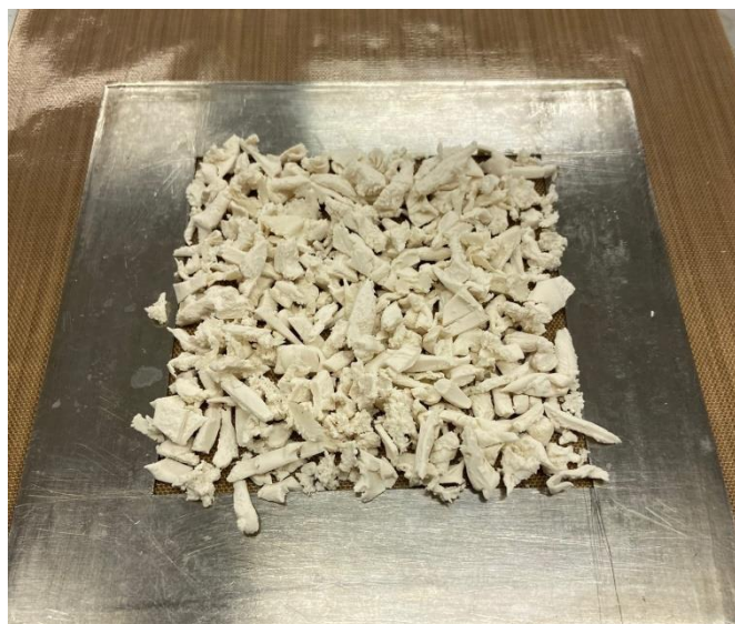
Slika 3.7. Stavljanje materijala u kalup
