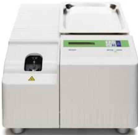
Slika 19. DSC uređaj Mettler Toledo DSC823e [44]
