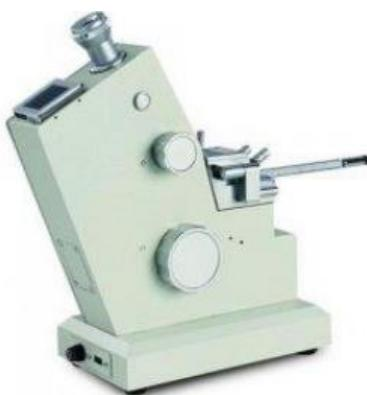
**Slika 14.** Refraktometar, *Exacta Optech RMI Abbe refractometer*.
