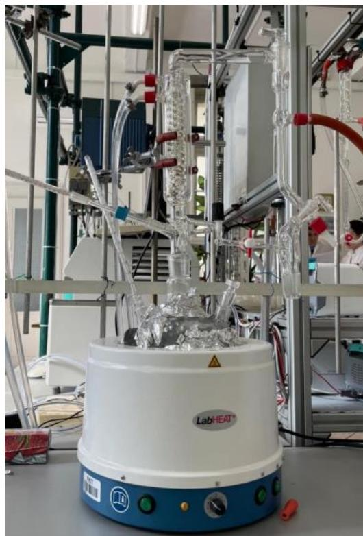
**Slika 13.** Destilacijska kolona za šaržnu destilaciju.
