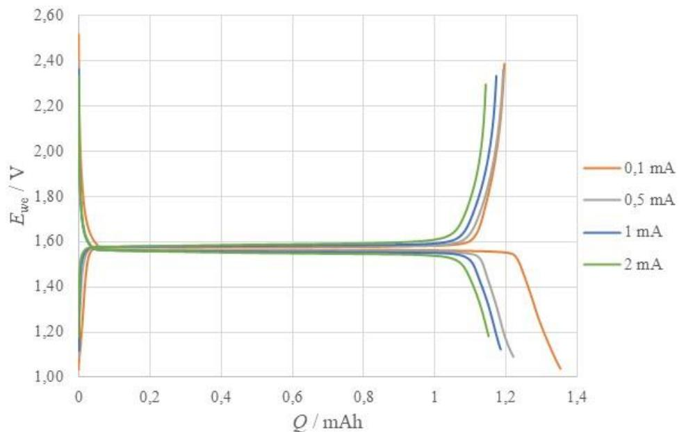
**Slika 4.8.** Naponski profili LTO radne elektrode u tro-elektrodnom sustavu kroz četiri ciklusa punjenja i pražnjenja s konstantnim strujama od  $I = 100 \mu\text{A}$ ,  $I = 500 \mu\text{A}$ ,  $I = 1 \text{ mA}$  i  $I = 2 \text{ mA}$
