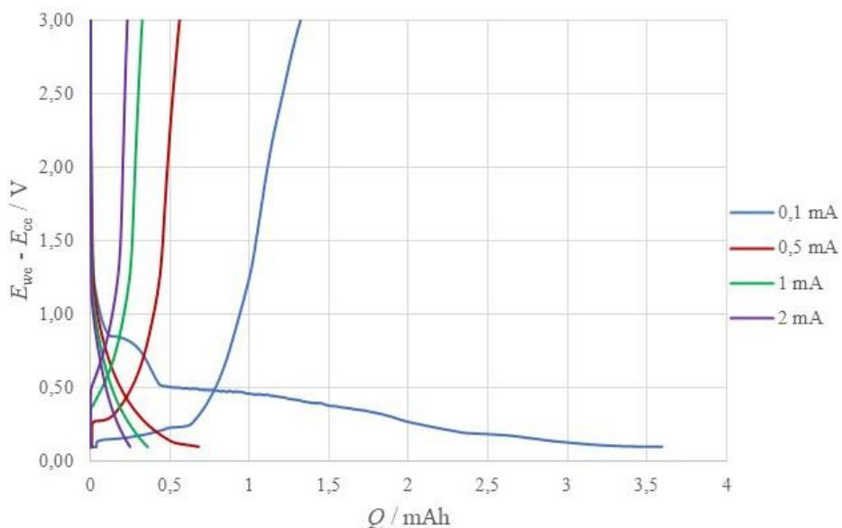
**Slika 4.12.** Promjena razlike potencijala grafitne radne elektrode i protuelektrode (Li) u tro-elektronim sustavima kroz četiri ciklusa punjenja i pražnjenja s konstantnim strujama od  $I = 100 \mu\text{A}$ ,  $I = 500 \mu\text{A}$ ,  $I = 1 \text{ mA}$  i  $I = 2 \text{ mA}$
