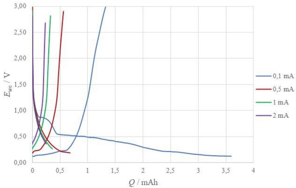
**Slika 4.9.** Naponski profili grafitne radne elektrode u tro-elektrodnom sustavu kroz četiri ciklusa punjenja i pražnjenja s konstantnim strujama od  $I = 100 \mu\text{A}$ ,  $I = 500 \mu\text{A}$ ,  $I = 1 \text{ mA}$  i  $I = 2 \text{ mA}$
