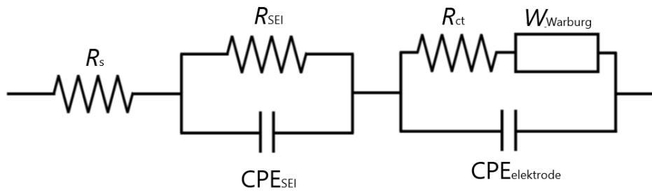
**Slika 5.1.** Model ekvivalentnog električnog kruga za polučlanak s radnom elektrodom u litij ionskim galvanskim člancima
