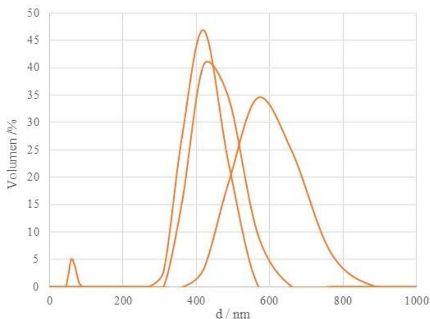
**Slika 4.18.** Rezultat dinamičkog raspršenja svjetlosti (volumen) za grafit
