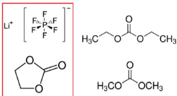
**Slika 2.6.** Kemijske strukture komponenti u komercijalnom elektrolitu: LiPF<sub>6</sub> kao litijeva sol (gore lijevo) i etilen karbonat kao otapalo (dolje lijevo) te dietil karbonat (gore desno) ili dimetil karbonat (dolje desno) [19]
