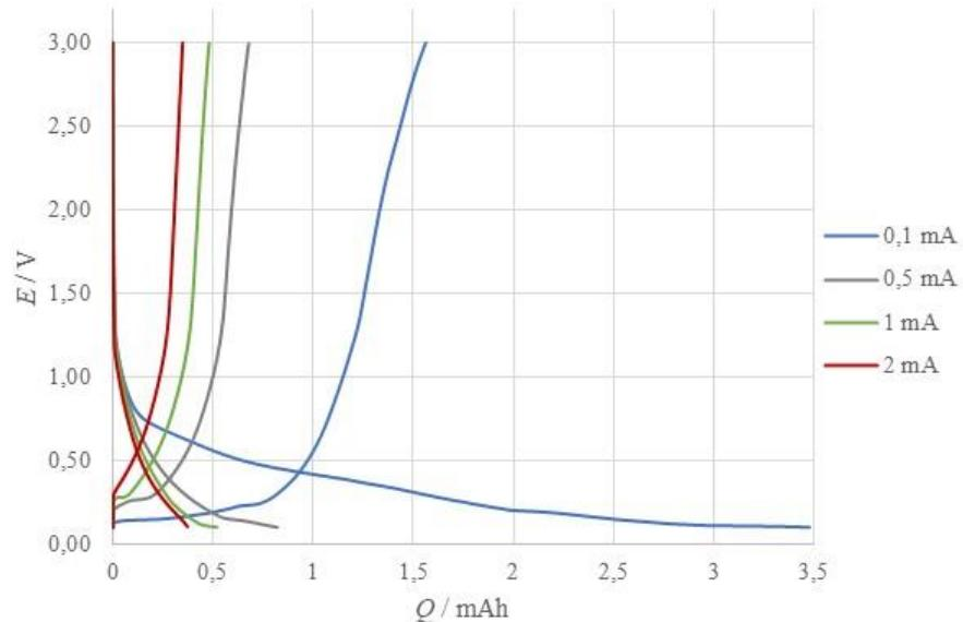
**Slika 4.3.** Naponski profili četiri ciklusa punjenja i pražnjenja dugmastog galvanskog članka (grafit) pri konstantnim strujama od  $I = 100 \mu\text{A}$ ,  $I = 500 \mu\text{A}$ ,  $I = 1 \text{ mA}$  i  $I = 2 \text{ mA}$
