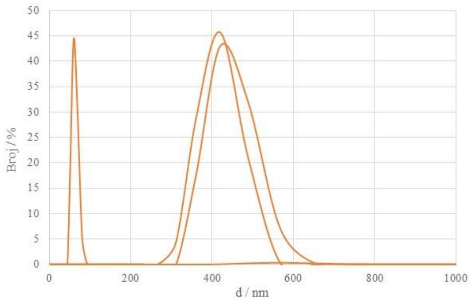
**Slika 4.20.** Rezultat dinamičkog raspršenja svjetlosti (broj) za grafit
