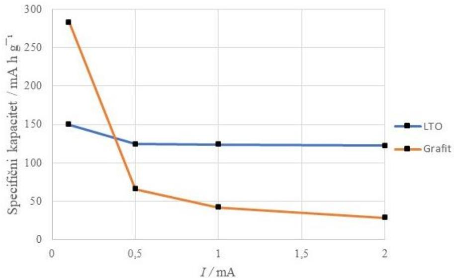
**Slika 4.4.** Ovisnost specifičnog kapaciteta dugmastihih galvanskih članaka o struji pražnjenja
