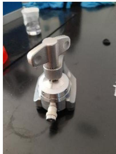
**Slika 3.6.** El-Cell celija za testiranje galvanskih članaka u tro-elekrodnom sustavu s umetnutom referentnom elektrodom
