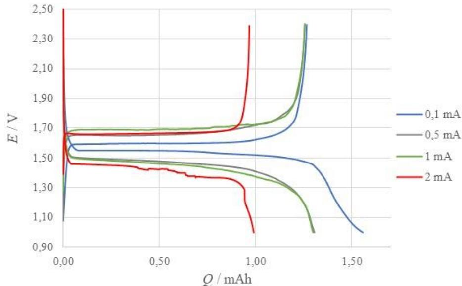
**Slika 4.2.** Naponski profili četiri ciklusa punjenja i pražnjenja dugmastog galvanskog članka (LTO) pri konstantnim strujama od  $I = 100 \mu\text{A}$ ,  $I = 500 \mu\text{A}$ ,  $I = 1 \text{ mA}$  i  $I = 2 \text{ mA}$
