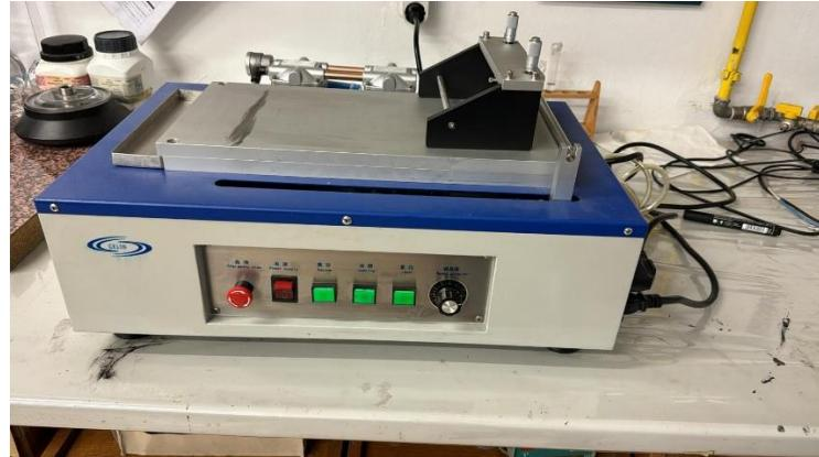
**Slika 3.1.** Uređaj za nanošenje tankih filmova – „Doctor Blade“ (Gelon Lib, Kina)
