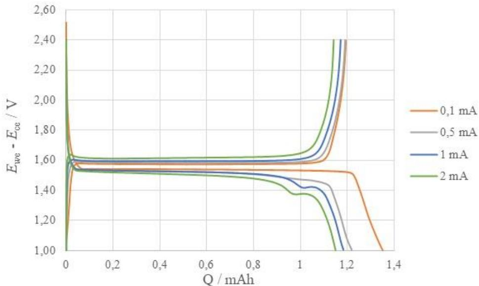
**Slika 4.11.** Promjena razlike potencijala LTO radne elektrode i protuelektrode (Li) u tro-elektronim sustavima kroz četiri ciklusa punjenja i pražnjenja s konstantnim strujama od  $I = 100 \mu\text{A}$ ,  $I = 500 \mu\text{A}$ ,  $I = 1 \text{ mA}$  i  $I = 2 \text{ mA}$
