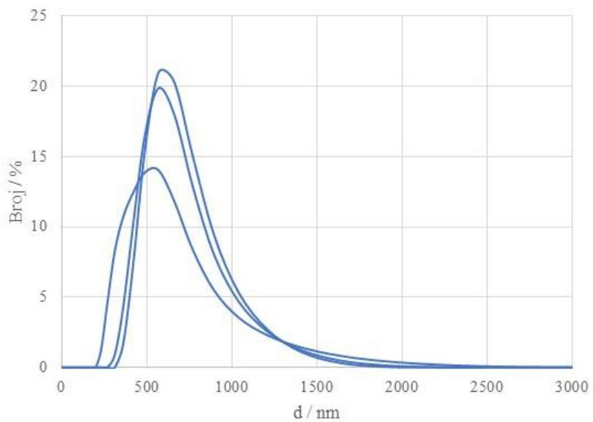
**Slika 4.19.** Rezultat dinamičkog raspršenja svjetlosti (broj) za LTO
