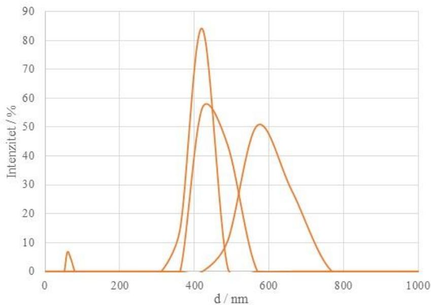
**Slika 4.16.** Rezultat dinamičkog raspršenja svjetlosti (intenzitet) za grafit
