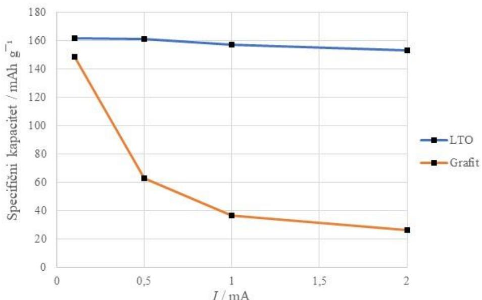
**Slika 4.14.** Promjena specifičnog kapaciteta tro-elektrodnih sustava povećanjem struje
