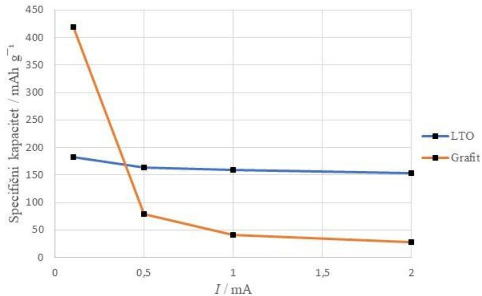
**Slika 4.13.** Promjena specifičnog kapaciteta tro-elektrodnih sustava povećanjem struje
