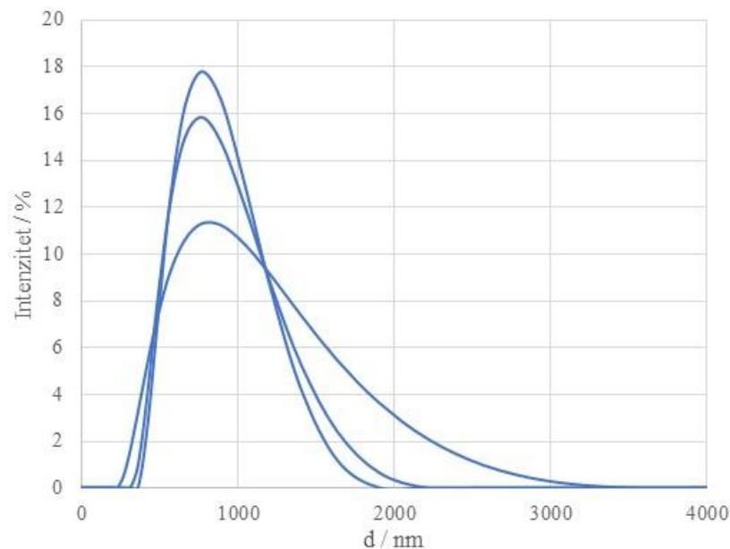
**Slika 4.15.** Rezultat dinamičkog raspršenja svjetlosti (intenzitet) za LTO
