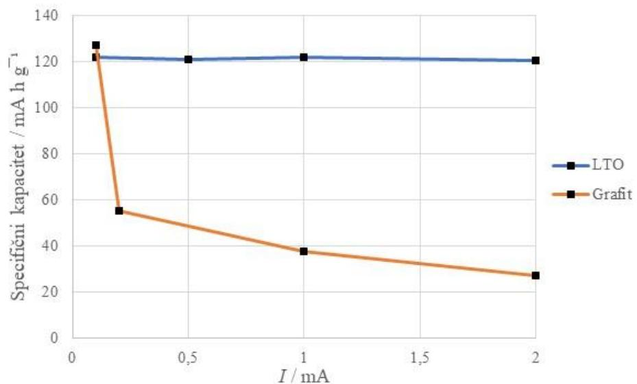
**Slika 4.5.** Ovisnost specifičnog kapaciteta dugmastihih galvanskih članaka o struji punjenja
