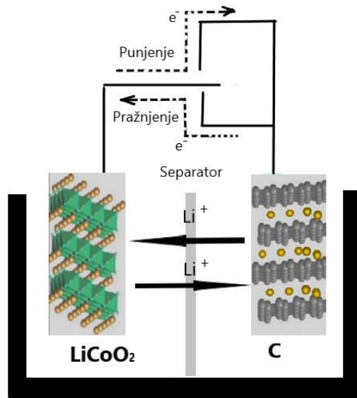
**Slika 2.3.** Ilustracija koja prikazuje osnovne komponente i princip rada litij ionskog galvanskog članka [8]
