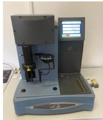
Slika 23. Termogravimetar TA Instruments Q500
