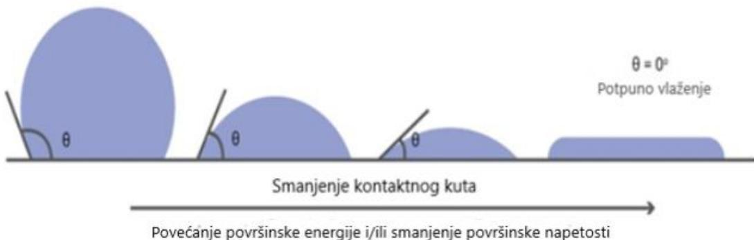
*Slika 17.* Prikaz odnosa kontaktnog kuta i površinske energije
