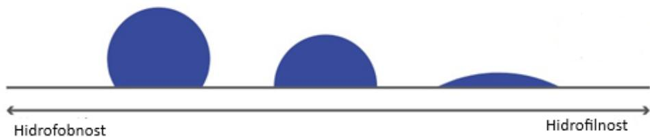
Slika18. Prikaz 2D presjeka kapljice na čvrstoj površini. Kut između obrisa kapljice i čvrste površine je kontaktni kut.<sup>66</sup>
