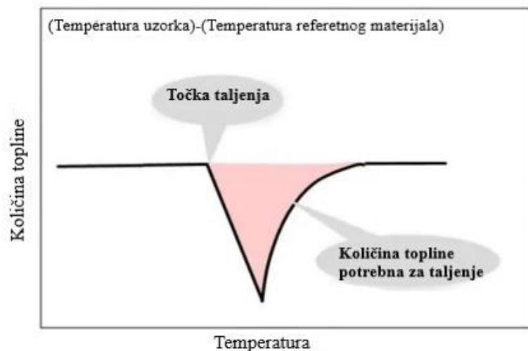
Slika 12. (Temperatura uzorka) - (Temperatura referentnog materijala) odgovara DSC signalima.
