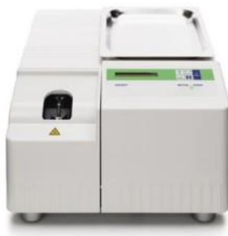
Slika 22. Uređaj Mettler Toledo DSC 823e
