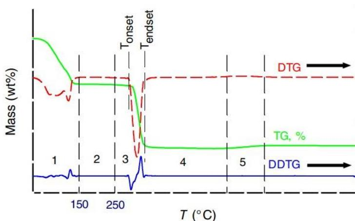
Slika 8. Prikaz pet mogućih odjeljaka temograma (TG krivulja (zeleno), DTG krivulja, prve derivacije (crveno), DDTG krivulja, druge derivacije (plavo)  $Mn(CH_3CO_2)_2 \cdot 4H_2O$  zagrijanog do 900 °C)
