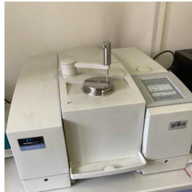
Slika 24. Uređaj FTIR Spectrum One
