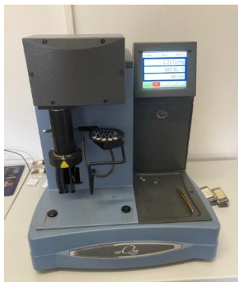
Slika 23. Termogravimetar TA Instruments Q500
