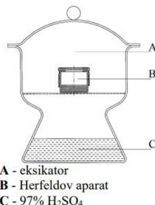
Slika 25. Herfeld-ova aparatura za ispitivanje propusnosti vodene pare
