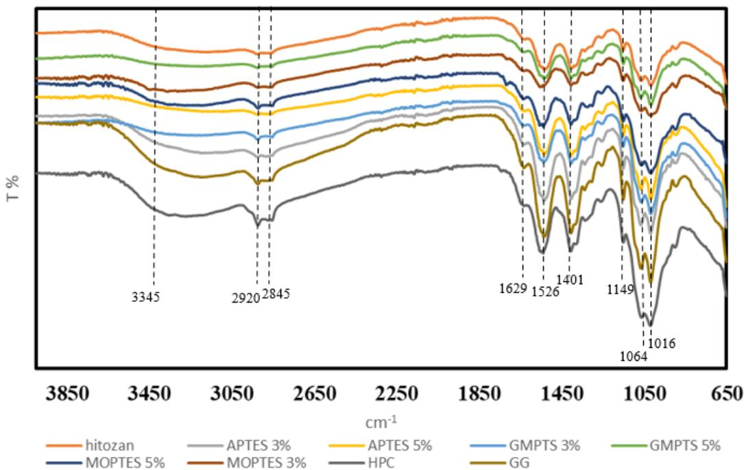
Slika 31. Usporedni FTIR spektri prevlaka hitozana
