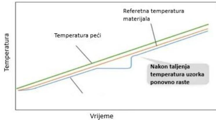
*Slika 11.* Nakon taljenja, temperatura uzorka ponovno raste prateći temperaturu peći.
