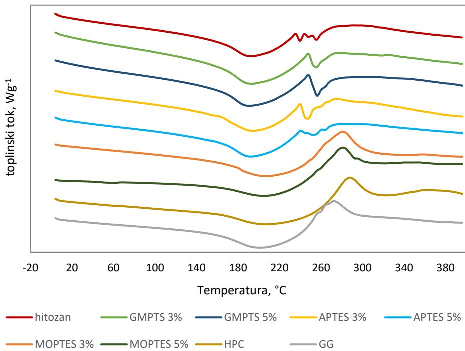
Slika 29. Usporedni DSC termogrami 2. ciklusa zagrijavanja prevlaka hitozana
