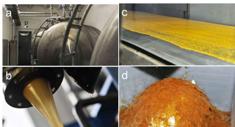
Slika 3. Postupak ekstrakcije otapalom: a) spremnik u kojem se šelak otapa u etanolu, b) ispuštanje rastaljenog šelaka iz isparivača tankog filma, c) hlađenje šelak filma, d) ljuskice šelaka (4)
