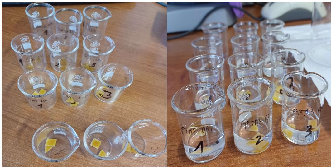
Slika 33. Prikaz različitih prevlaka šelaka u čašicama za mjerenje prije i nakon dodatka modelne otopine ljudskog znoja.
