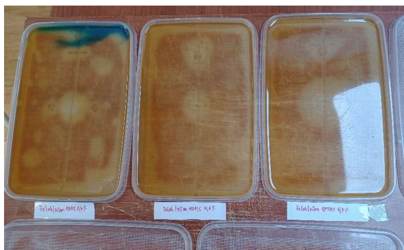
Slika 22. Filmovi u procesu sušenja.
