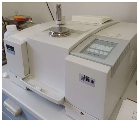
Slika 27. Perkin Elmer Spectrum One Spectrometer s ATR sustavom.
