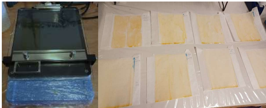
Slika 24. Izvlačenje filmova na automatskom izvlakivaču.
