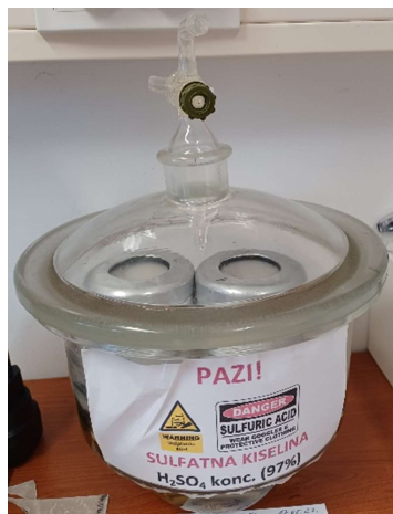
Slika 28. Herfeld-ov uređaj za određivanje propusnosti vodene pare.
