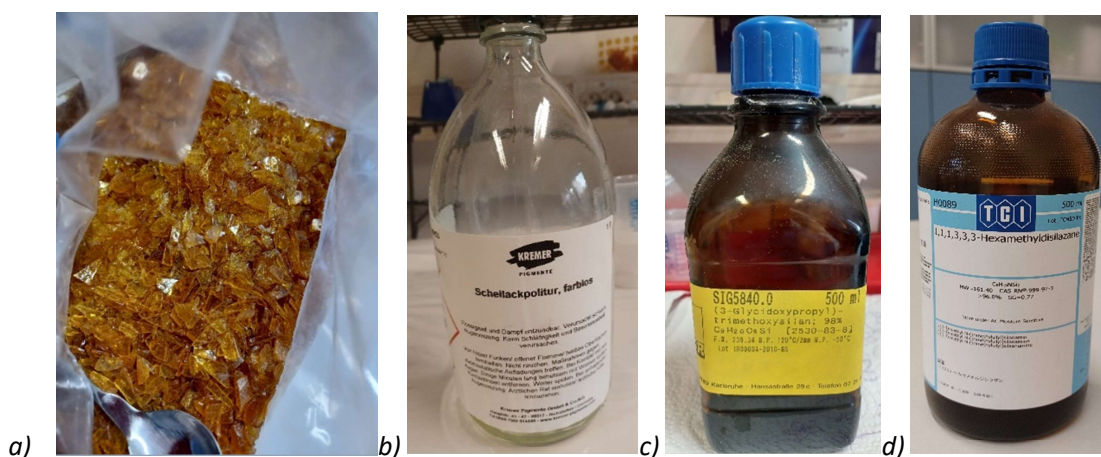
Slika 20. Komponente za pripravu prevlaka a) kruti šelak, b) komercijalna otopina šelaka, c) GPTMS-silan i d) HMDS-silan).
