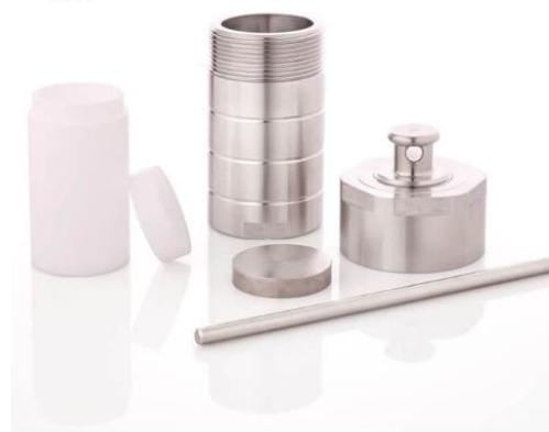
Slika 9. Hidrotermalni reaktor [50]
