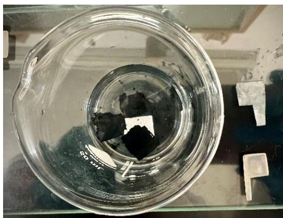
Slika 3.10. a) GO papiri \approx 1 \text{ cm}^2 te niklena i cinkova elektroda i b) sastavljena Zn//rGO/V 2 O 5 baterija
