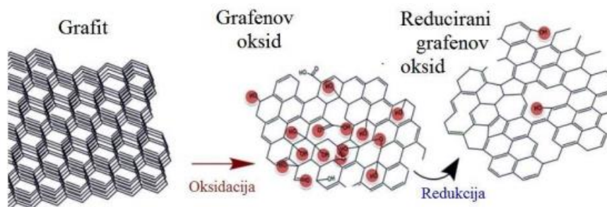
Slika 2.5. Struktura grafita, GO i rGO
