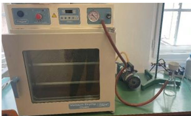
Slika 3.7. Aparatura za pripremu GO papira
