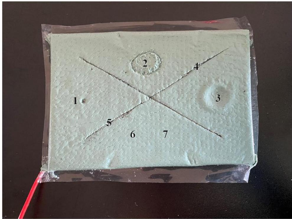
**Slika 17.** Prikaz pozicija impedancijskog mjerjenja na mehanički oštećenom uzorku
