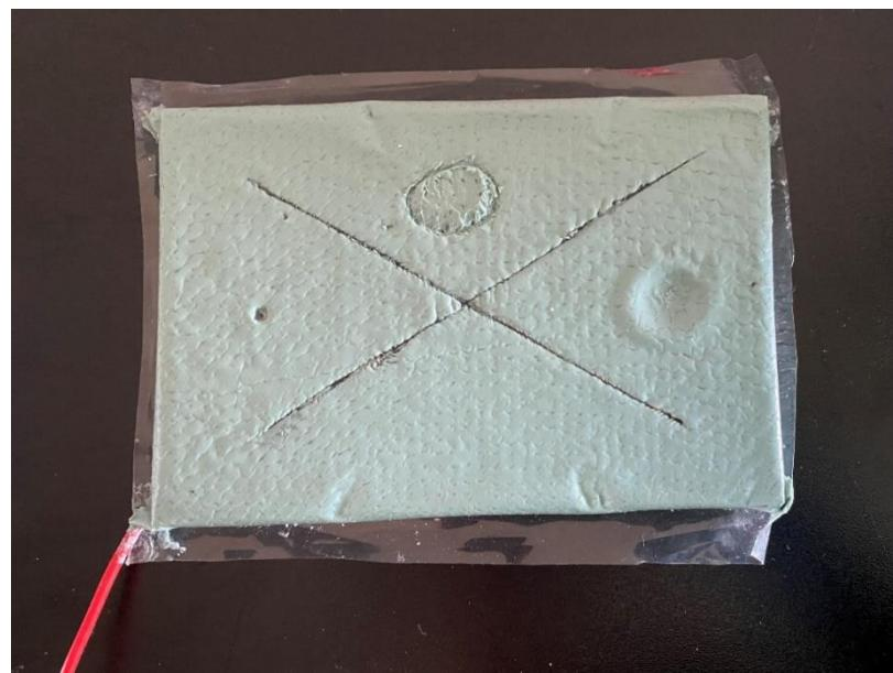
Slika 14. Mehanički oštećen uzorak
