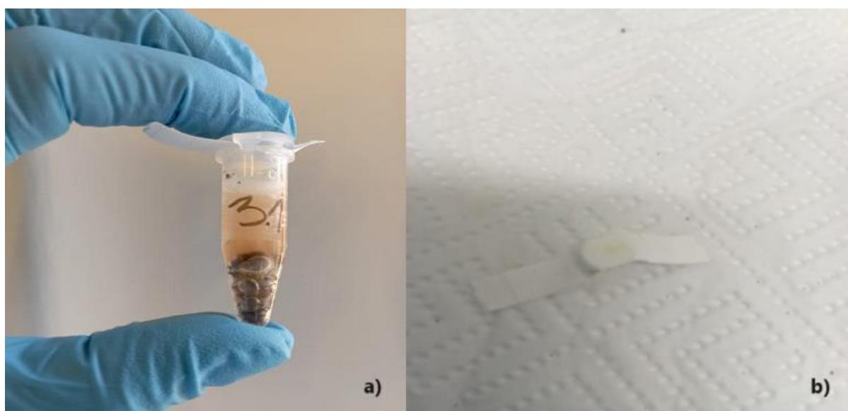
**Slika 59.** Prikaz a) nastajanja mjeđurića plina tijekom provođenja testa na karbone i sulfide i b) izgled indikatorske trakice nakon testa.
