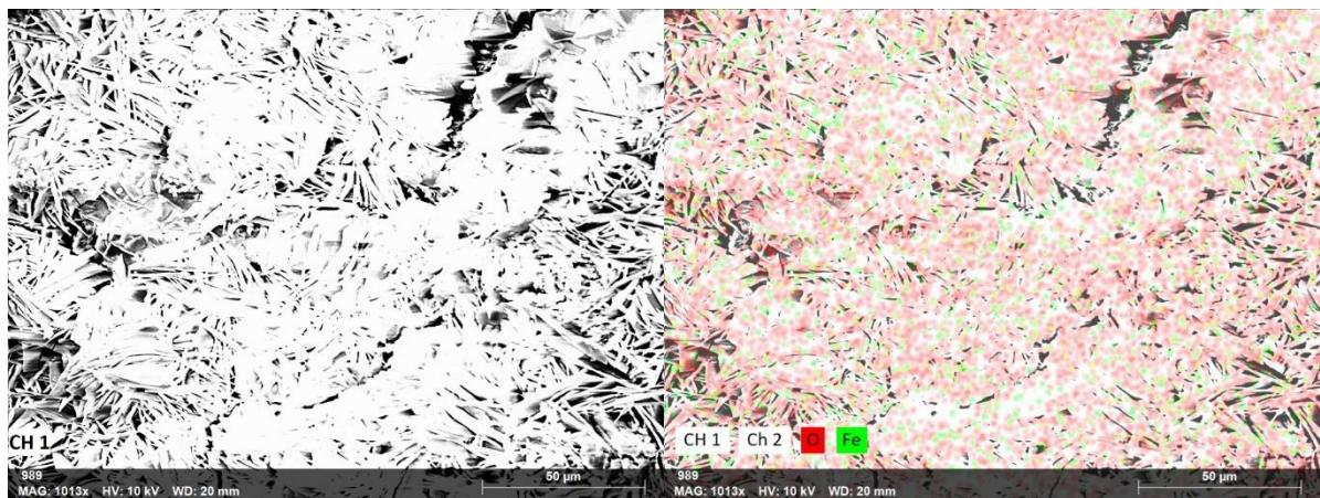
**Slika 41.** Prikaz rezultata dobiven EDS mapiranjem za uzorak 2.3.
