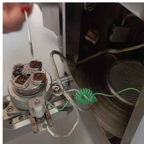
**Slika 25.** Prikaz stavljanja uzorka u SEM uređaj.
