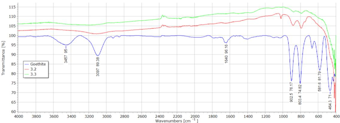
**Slika 28.** FTIR spektri korozijskih uzoraka 3.2. i 3.3. s getitom kao referentnom supstancicom.
