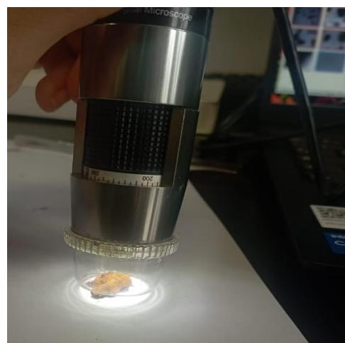
**Slika 24.** Prikaz upotrebe digitalnog mikroskopa na korozijskim produktima.
