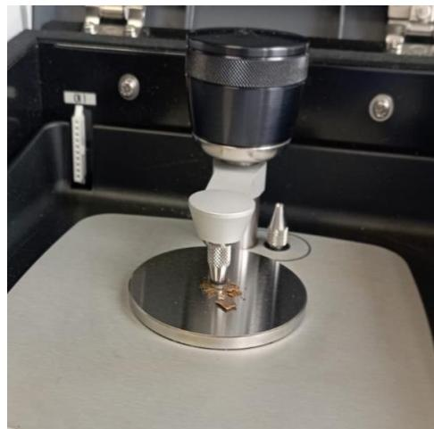
**Slika 23.** Prikaz ATR-FTIR mjerena na uzorcima korozijskih produkata.
