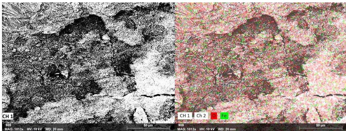
**Slika 47.** Prikaz rezultata dobiven EDS mapiranjem za uzorak 3.1.
