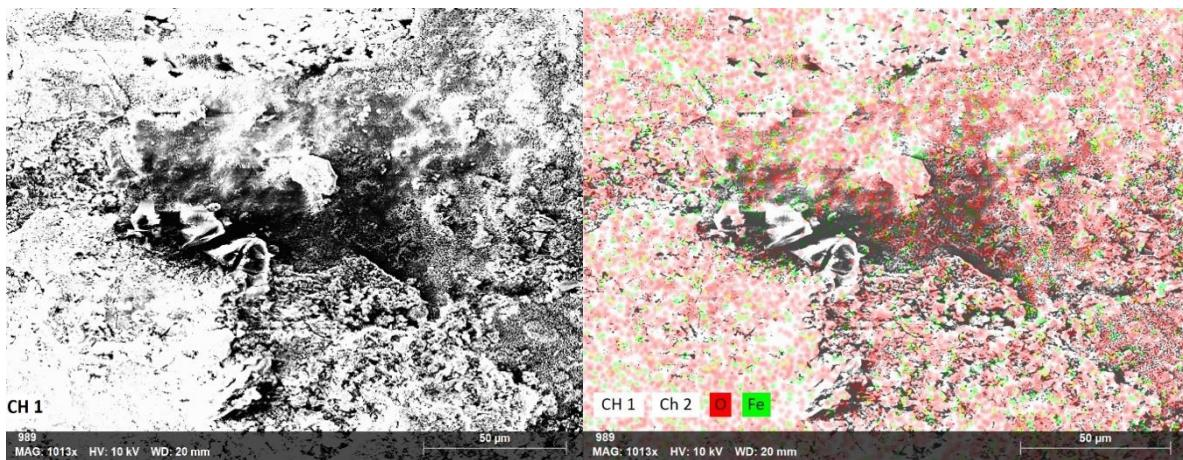
**Slika 39.** Prikaz rezultata dobiven EDS mapiranjem za 1.5. uzorak.
