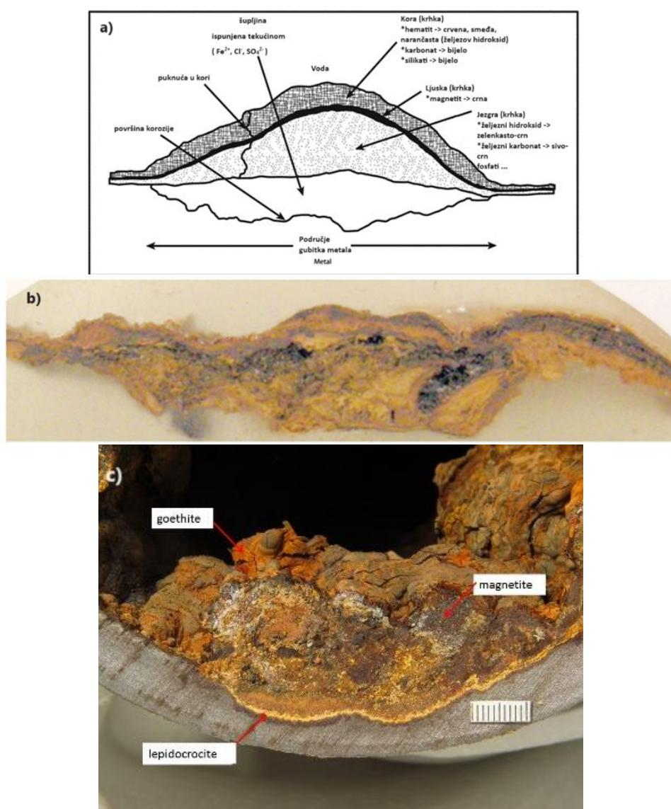
**Slika 4.** a) Shematski prikaz morfologije tuberkule b) fotografija tuberkule c) presjek tuberkule sa označenim nusprodukta korozije [9,10].
