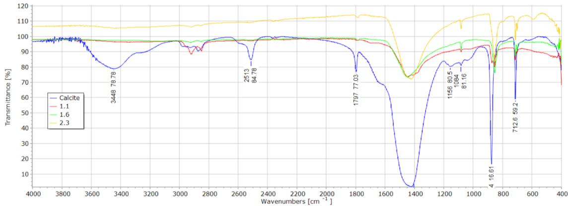
**Slika 27.** FTIR spektar korozijskih uzoraka s kalcitom kao referentnom tvari i uzorcima 1.1., 1.6., 2.3.
