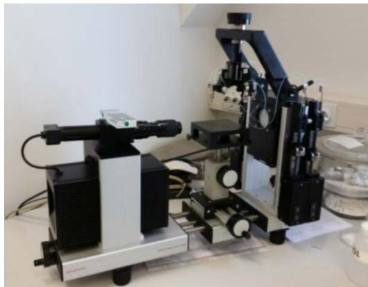
Slika 3.22. Goniometar, instrument za mjerjenje kontaktnog kuta, DataPhysics OCA 20.
