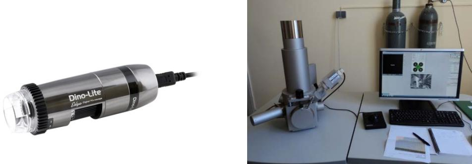
Slika 3.24. Optički mikroskop (lijevo) i pretražni elektronski mikroskop (desno).
