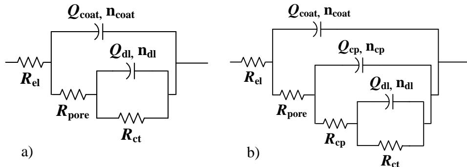
Slika 4.43. Ekvivalentni električni krugovi korišteni za analizu impedancijskih spektara premazom zaštićenih uzoraka.
