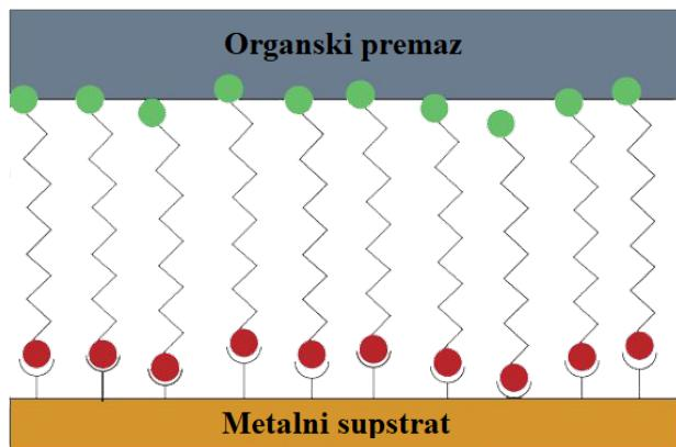
Slika 2.15. Shematski prikaz modifikacije metala poboljšivačima adhezije.
