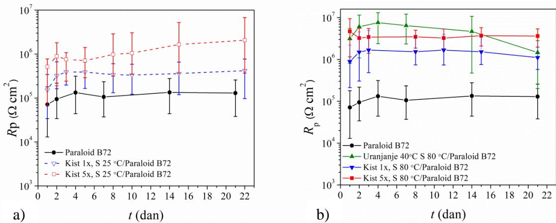
Slika 4.56. Ovisnost polarizacijskog otpora o vremenu u umjetnoj kiseloj kiši za patinirane uzorke i uzorke zaštićene Paraloidom B72 sa i bez predtretmana s COOH-PA.<sup>82</sup>
