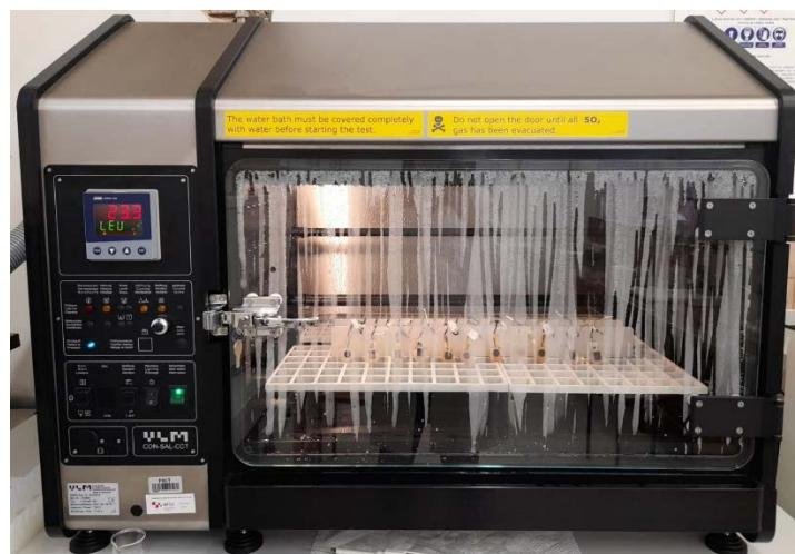
Slika 3.26. Komora za ubrzana korozijska ispitivanja.
