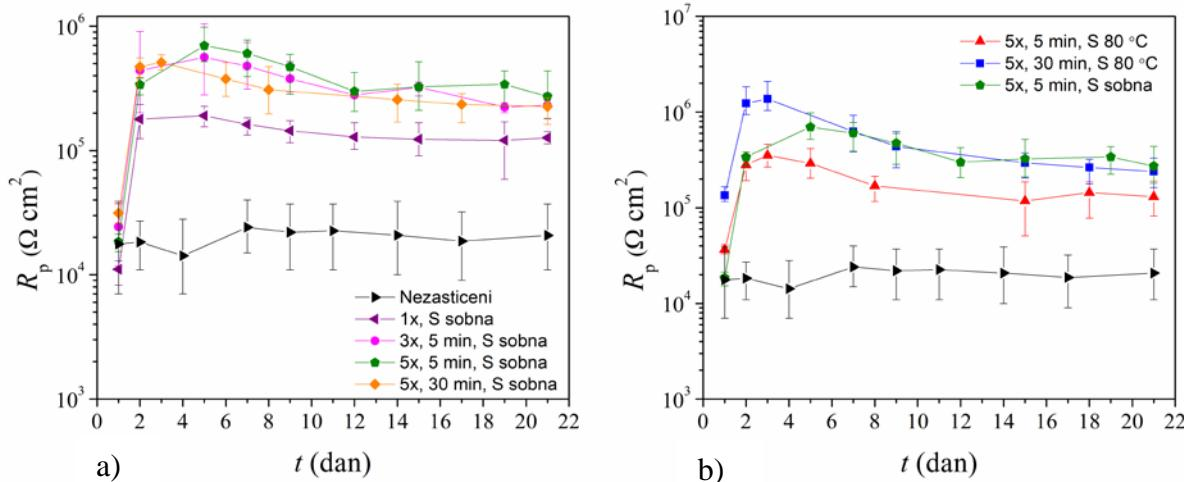
Slika 4.7. Ovisnost polarizacijskog otpora o vremenu u umjetnoj kiseloj kiši za nezaštićeni uzorak CuSn12 bronce i uzorke zaštićene filmovima COOH-PA dobivenih metodom prskanja.
