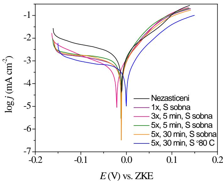
Slika 4.6. Polarizacijske krivulje dobivene u umjetnoj kiseloj kiši za nezaštićeni uzorak CuSn12 bronce i uzorke zaštićene filmovima COOH-PA dobivenih metodom prskanja.
