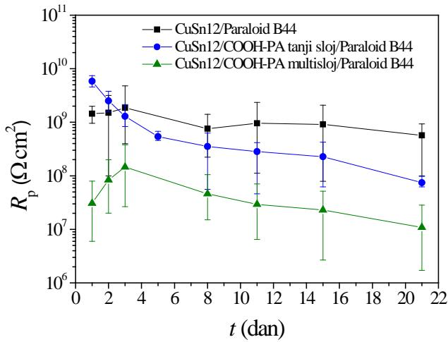
Slika 4.46. Ovisnost polarizacijskog otpora o vremenu izlaganja umjetnoj kiseloj kiši za uzorke zaštićene Paraloidom B44 sa i bez predtretmana s COOH-PA.
