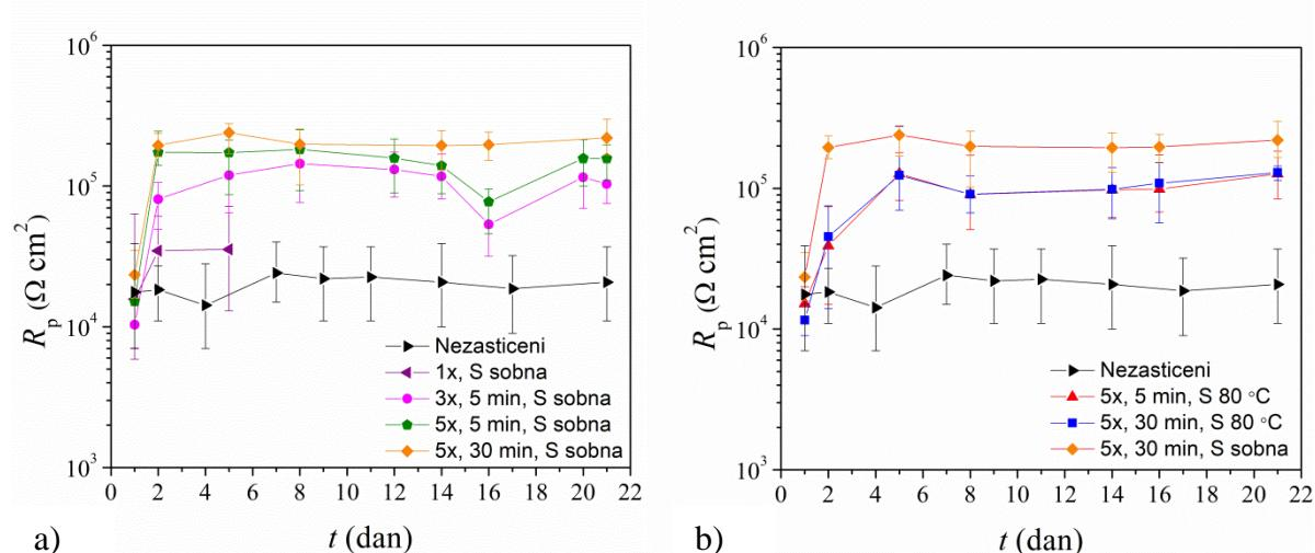
Slika 4.2. Ovisnost polarizacijskog otpora o vremenu u umjetnoj kiseloj kiši za nezaštićeni uzorak CuSn12 bronce i uzorke zaštićene filmovima COOH-PA dobivenih metodom kista.
