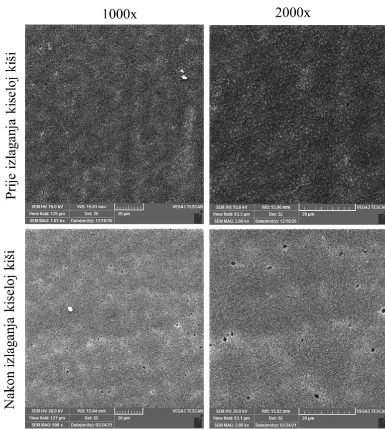
Slika 4.12. SEM slike uzorka zaštićenog filmom COOH-PA prije i nakon 3 tjedna izlaganja umjetnoj kiseloj kiši. Film dobiven metodom uranjanja
