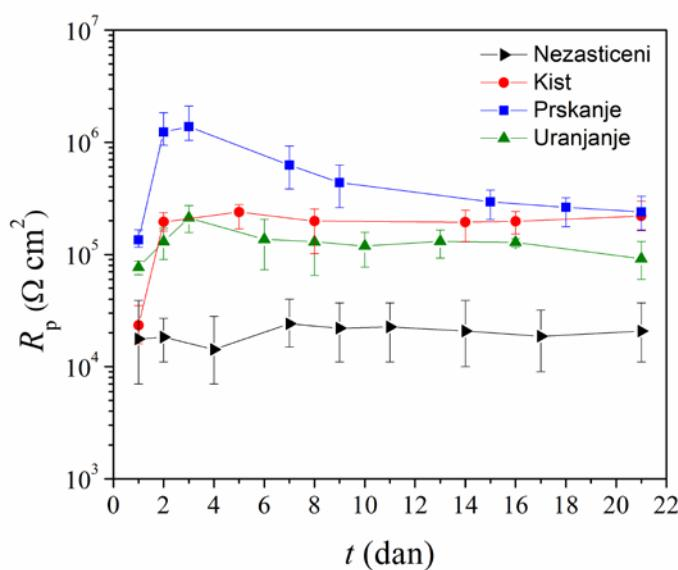
Slika 4.11. Ovisnost polarizacijskog otpora o vremenu u umjetnoj kiseloj kiši za nezaštićeni uzorak i uzorke zaštićene filmovima COOH-PA dobivenih metodama kista, prskanja i uranjanja.
