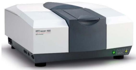
Slika 3.15. FTIR uređaj Shimadzu IRTtracer-100.
