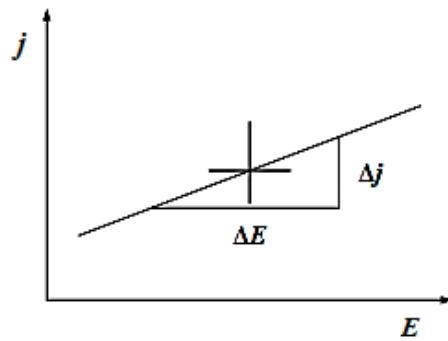
Slika 3.8. Određivanje polarizacijskog otpora prema F. Mansfeldu.<sup>2</sup>
