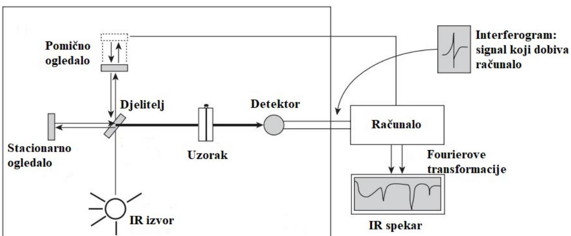
Slika 3.14. Shematski prikaz Fourier transformacijskog spektrometra.<sup>134</sup>
