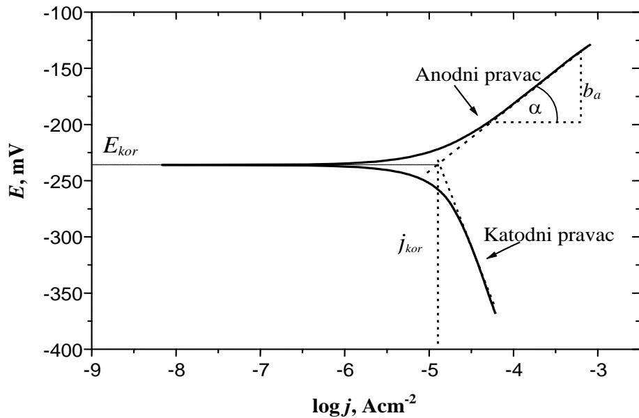
Slika 3.7. Određivanje koroziskih parametara iz polarizacijske krivulje metodom Tafelove ekstrapolacije.<sup>2</sup>
