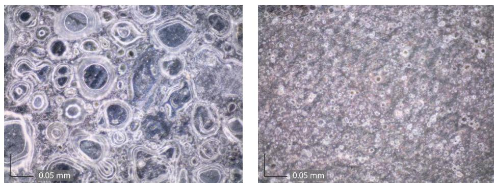
Slika 4.59. Uzorci snimljeni optičkim mikroskopom pri povećanju od 740x nakon dva tjedna izloženosti komori za ubrzana koroziska ispitivanja: a) patinirana bronca zaštićena Paraloidom B72 i b) patinirana bronca tretirana filmom fosfonske kiseline i zaštićena Paraloidom B72.<sup>82</sup>
