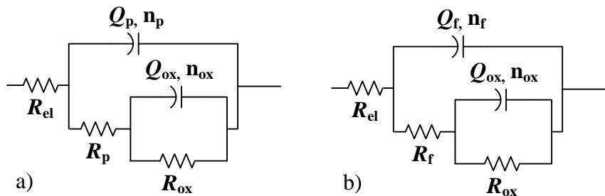
Slika 4.33. Ekvivalentni električni krugovi korišteni za modeliranje impedancijskih spektara
