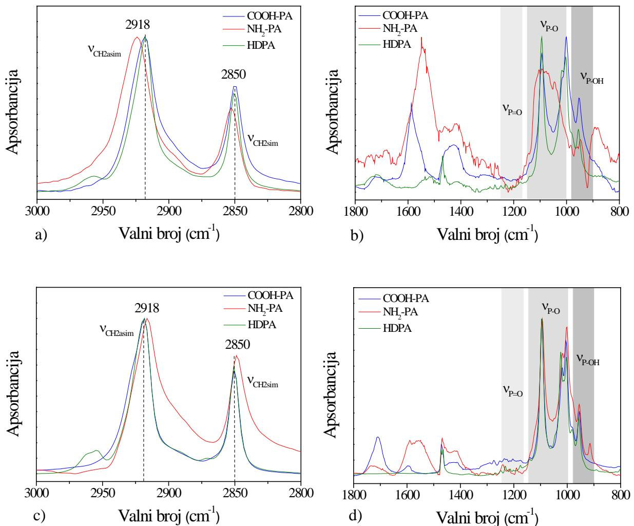
Slika 4.14. Normalizirani FTIR spektri COOH-PA, NH<sub>2</sub>-PA i HDPA filmova dobivenih iz
