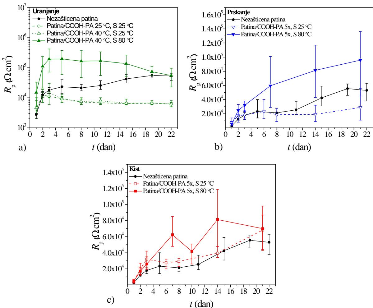
Slika 4.51. Ovisnost polarizacijskog otpora o vremenu u umjetnoj kiseloj kiši za nezaštićene patinirane uzorke i uzorke zaštićene kiselinama dobivenim metodom a) uranjanja, b) prskanja i c) kista.<sup>82</sup>
