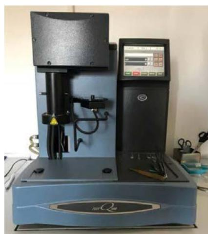
Slika 3.25. TGA analizator Q500.
