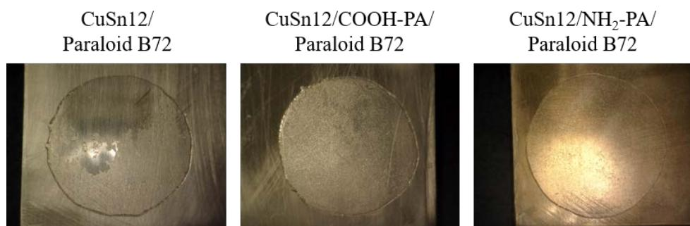
Slika 4.45. Slike uzorka nakon ispitivanja prionjivosti premaza vlačnom metodom.
