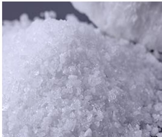
**Slika 5. Bijeli taljeni aluminijev oksid tvrtke Alteo**
