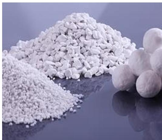
**Slika 3. Sinterirani aluminijev oksid tvrtke Alteo**
