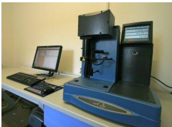
Slika 6. Uređaj za termogravimetrijsku analizu TGA Q500 2910 (TA Instruments)
