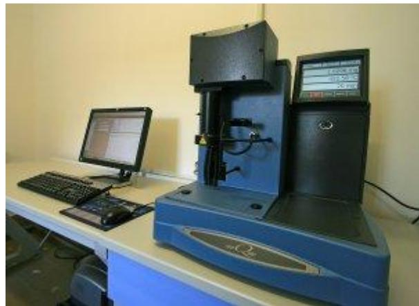
Slika 6. Uredaj za termogravimetrijsku analizu TGA Q500 2910 (TA Instruments)
