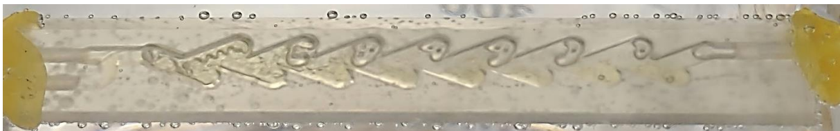
Slika 4.6.3.4. Profil strujanja u mikroreaktoru Tmod2 pri \tau = 8 min
