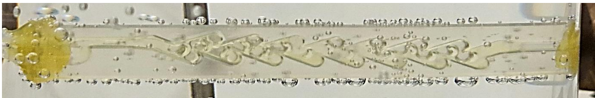
Slika 4.6.2.2. Profil strujanja u mikroreaktoru Tmod1 pri \tau = 1 min
