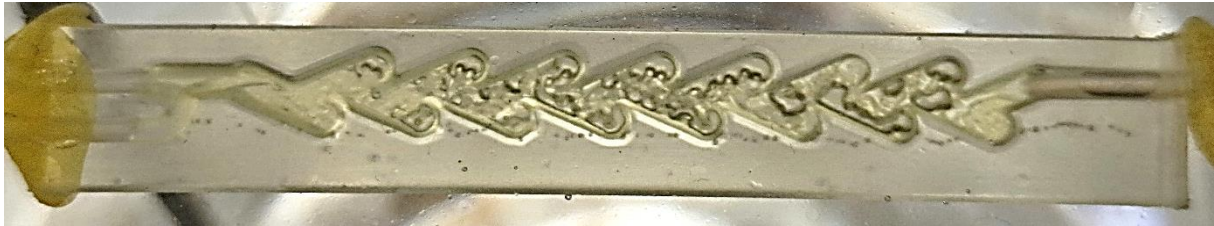
Slika 4.6.3.3. Profil strujanja u mikroreaktoru Tmod2 pri \tau = 4 min
