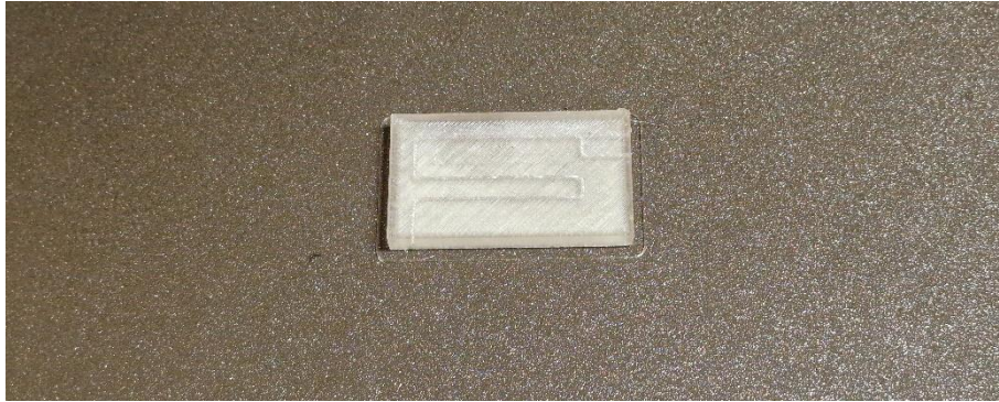
Slika 4.5.1.1 Mikroreaktor 3D-ispisan FFF tehnologijom
