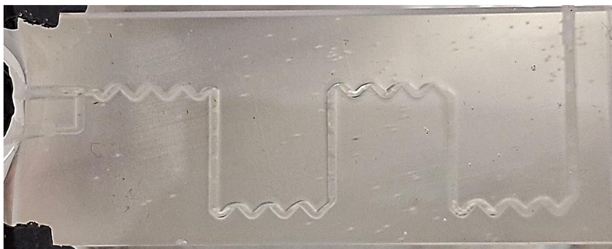
Slika 4.6.8.2. Profil strujanja u mikroreaktoru C7Kzz3 pri \tau = 4,7 min
