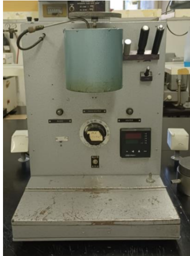
Slika 3.6. Uređaj za mjerenje MFR-a Ceast MFI
