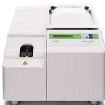
Slika 3.4. Diferencijalni pretražni kalorimetar, Mettler Toledo DSC 823e
