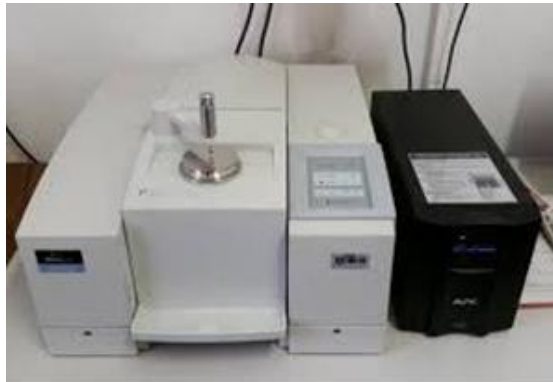
Slika 3.2. FTIR spektrofotometar PerkinElmer Spectrum One
