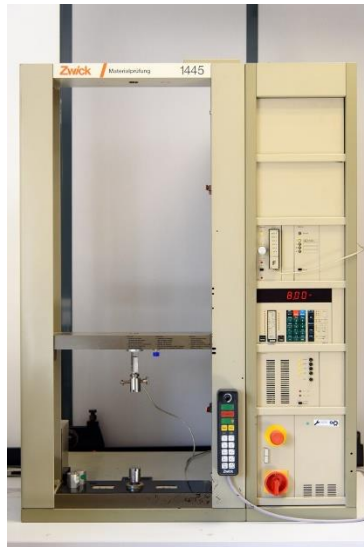
Slika 3.5. Mehanička kidalica Zwick UTM 1445
