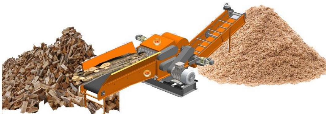
Slika 16. Prikaz načina rada iverača. 14
