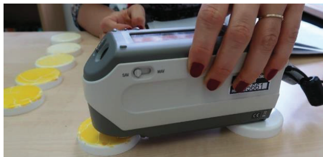
Slika 26. Uređaj Konica Minolta spektrometar CM-2600d [54]
