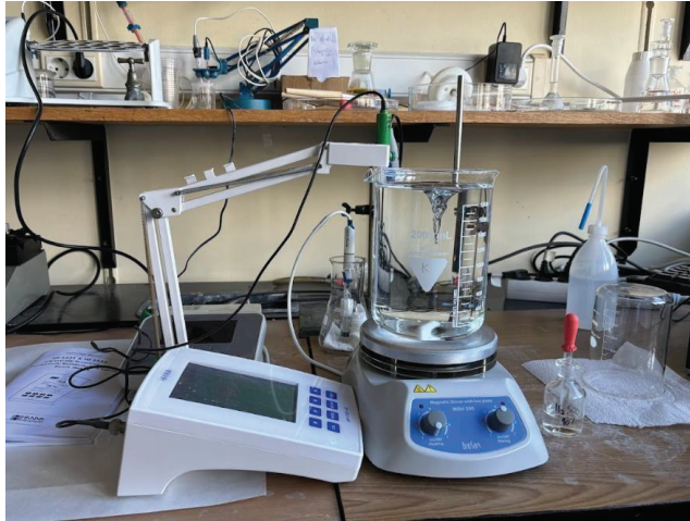
Slika 18. Zakiseljavanje otopine kiselih kiša i praćenje pH vrijednosti otopine
